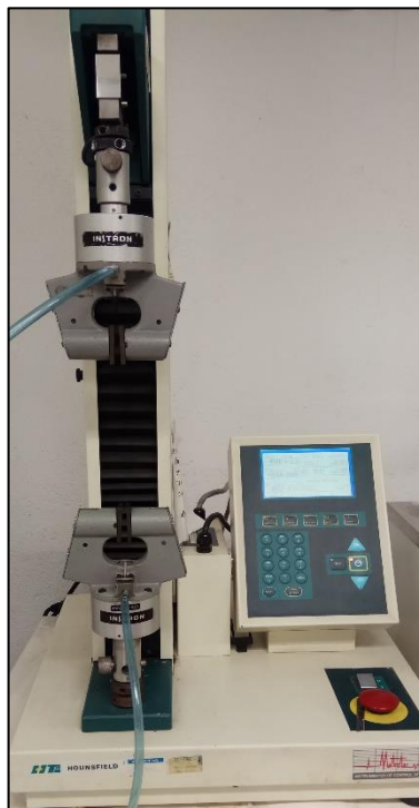
Figura 2-7. Màquina universal d'assajos a tracció Instron de Metrotec (Espanya).
