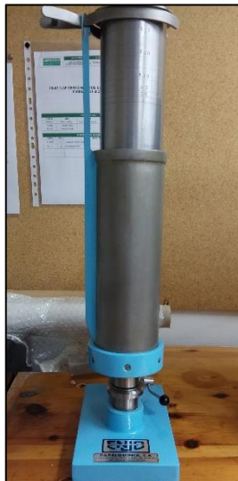
Figura 2-8. Medidor de permeabilitat a l'aire Gurley.
