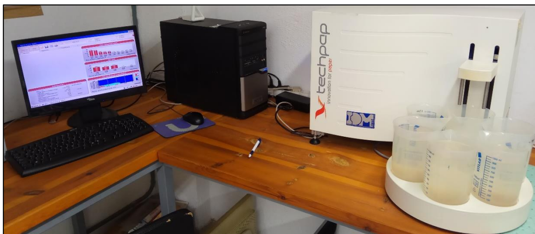
Figura 2-6. Equip MorFi per a la caracterització de les suspensions fibroses.
