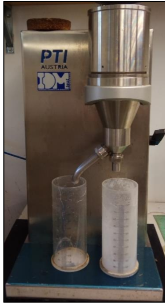
Figura 2-5. Aparell Schopper-Riegler adquirit de l'empresa PTI (Àustria).
