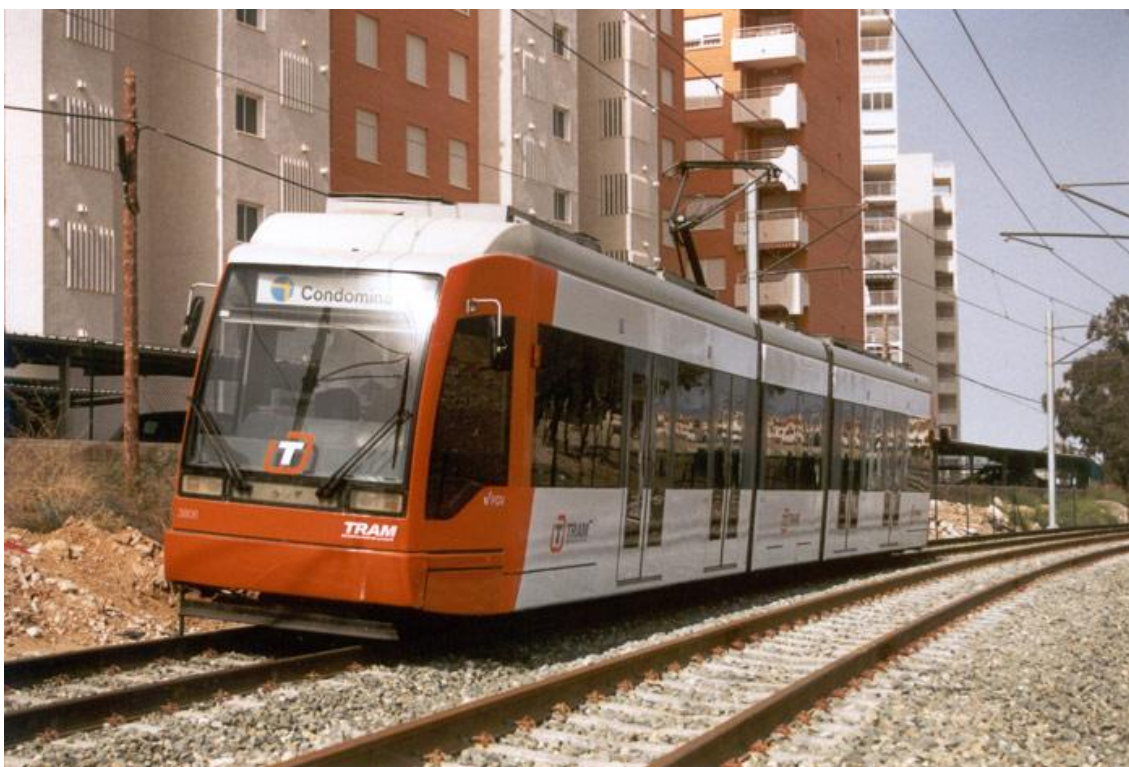
Figura 4.3. Imatge del tren-tram d'Alacant. Observem que el tramvia es mou a través de la via pròpia d'un ferrocarril. Font: http://www.vialibre.org/multimedia
