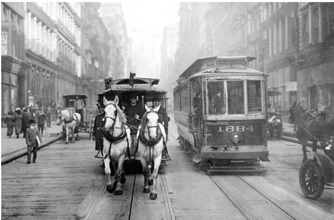
Figura 2.1. Comparativa gràfica entre el tramvia a tracció animal i el traccionat mitjançant el cable mecànic. Font: http://www.edisontechcenter.org/TrolleysTrams.html
