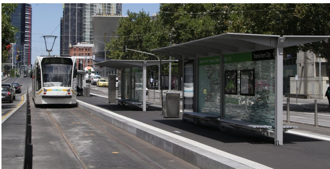
Figura 4.7. Imatge del que es coneix com a parada en plataforma d'illa. S'observa que el tramvia circula per ambdós costats de la plataforma. Font: https://railgallery.wongm.com
