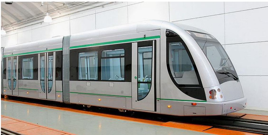
Figura 4.2. Imatge del metro lleuger de Sevilla. La circulació és subterrània tot i que la carrosseria com a tal és la d'un tramvia. Font: http://www.caf.net
