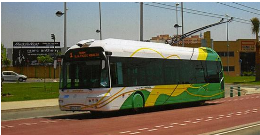
Figura 3.2. Imatge d'un troleibús. La carrosseria és idèntica a la de l'autobús, i es pot observar la catenària i la manca de rails. Font: http://www.anden1.org
