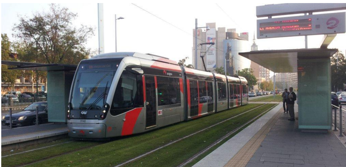
Figura 2.4. Tramvia de Saragossa. A la imatge es poden observar les catenàries i els rails, els quals estan coberts per gespa. Font: http://www.aragonradio.es/
