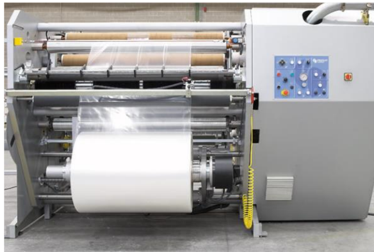
Figura 4. Vista frontal desbobinador shaftless
