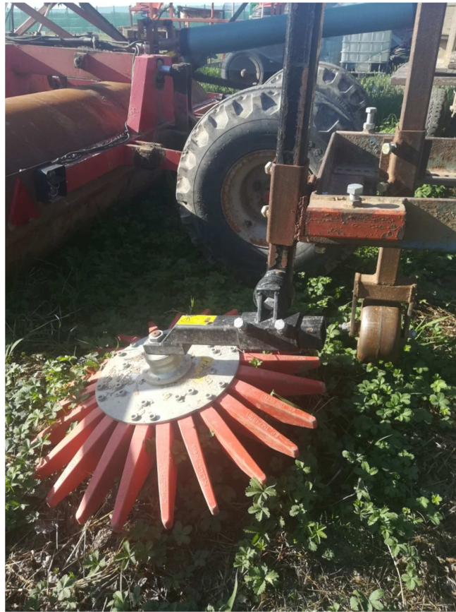
Figura 10: Sistema K.U.L.T. de desherbatge mecànic, a partir de dents de plàstic que entren superficialment en el sòl i trenquen les arrels de les herbes adventícies d'entre línies.
