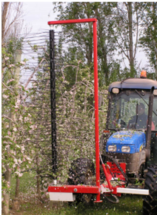
Figura 15: Màquina d'aclarida mecànica Darwin® 250 en funcionament en pomeres "Gàlaxy".
