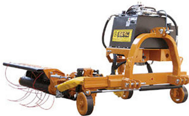
Figura 11: Desbrossadora ECOsprint pel desherbat entre línies en fruiters i vinya. Formada per un rotor amb filaments de nylon, col·locat paral·lelament al sòl. Fa un treball molt superficial.
