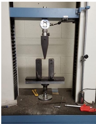
Figura 22. Màquina universal d'assajos. Equip per Flexió.
