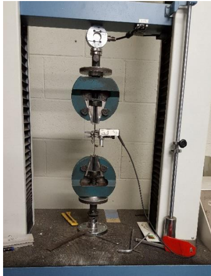
Figura 21. Màquina universal d'assajos. Equip per Tracció.
