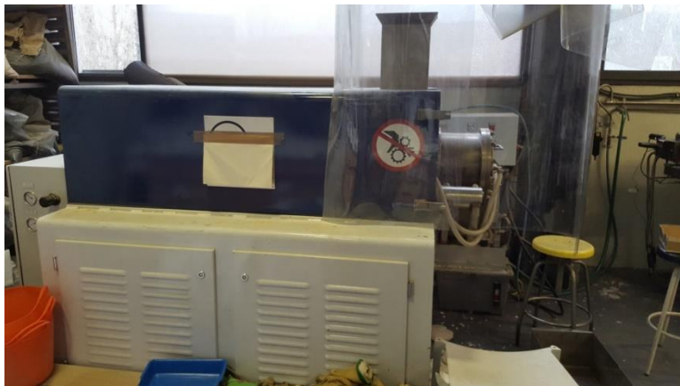
Figura 13. Mesclador cinètic d'alta intensitat
