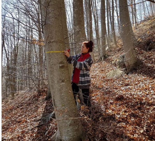
• Imatge 1: Procediment al camp de mesura del diàmetre a l'alçada del pit (DBH). Font: Lluís Vilar
