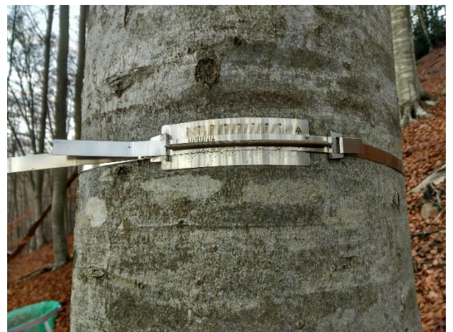
• imatge 3: Faig amb dendròmetre de banda per al registre de creixement radial. Font: Laia Tarradas
