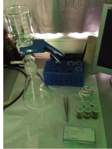
Figura 10. Material utilitzat per a l'anàlisi de clorofil·la. Font: imatge pròpia
