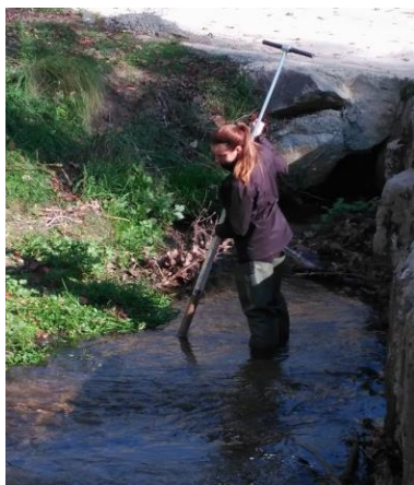
Figura 6. Extracció de la mostra utilitzant el mostrejador de sediment. Font: imatge pròpia
