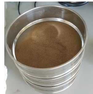
Figura 8. Alguns dels tamisos utilitzats amb el sediment retingut. Font: imatge pròpia
