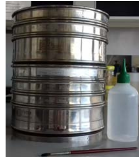
Figura 3: Material per dur a terme la filtració i separació per mida de diàmetres els ous de les gònades. En la imatge s'observen els 7 filtres - 0.800 mm, 0.600 mm, 0.500 mm, 0.400 mm, 0.300 mm, 0.125 mm i 0.100 mm -, el pinzell i l'aigua. Font: Pròpia.
