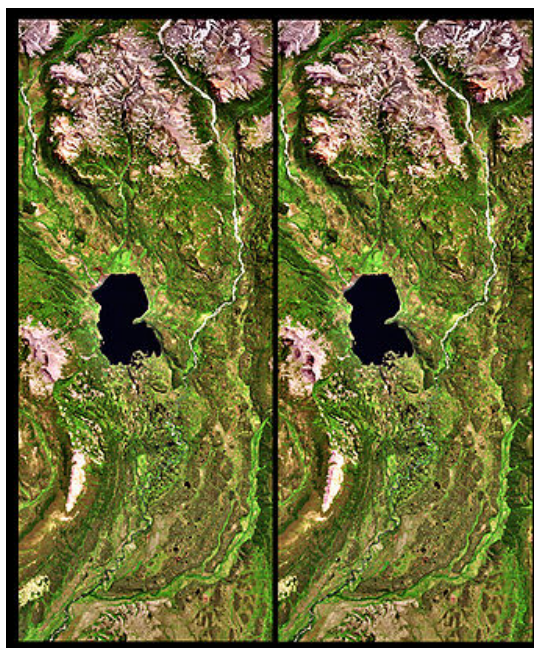
Figura 5. Par estereográfico. Con un poco de entrenamiento y cruzando la mirada, puede observarse una tercera imagen en relieve en el centro.
