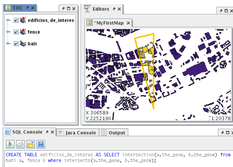
Figura 2: Intersección ejecutada interactivamente.
