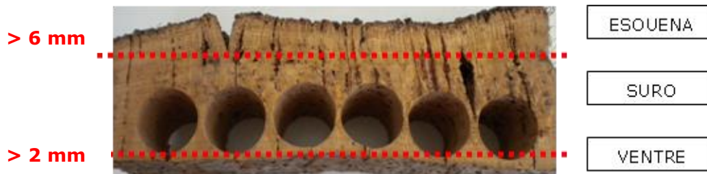
Figura 3.2 Esquema de la separació de les parts d'una llesca de suro.
