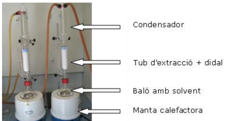
Figura 3.7 Muntatge del sistema Soxhlet per a la determinació d'extractius.
