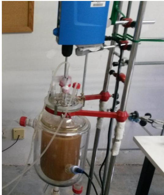
Figura 3.16 Reactor de tanc agitat amb el suro i la solució d'HAPs.
