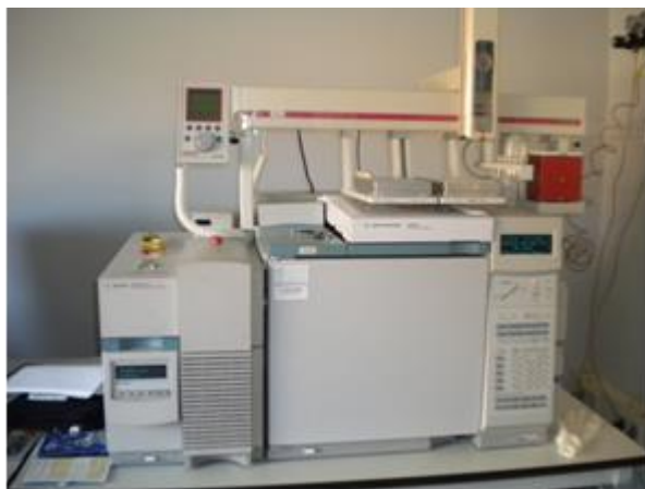
Figura 3.11 Cromatògraf de gasos espectrometria de masses (GC-MS).
