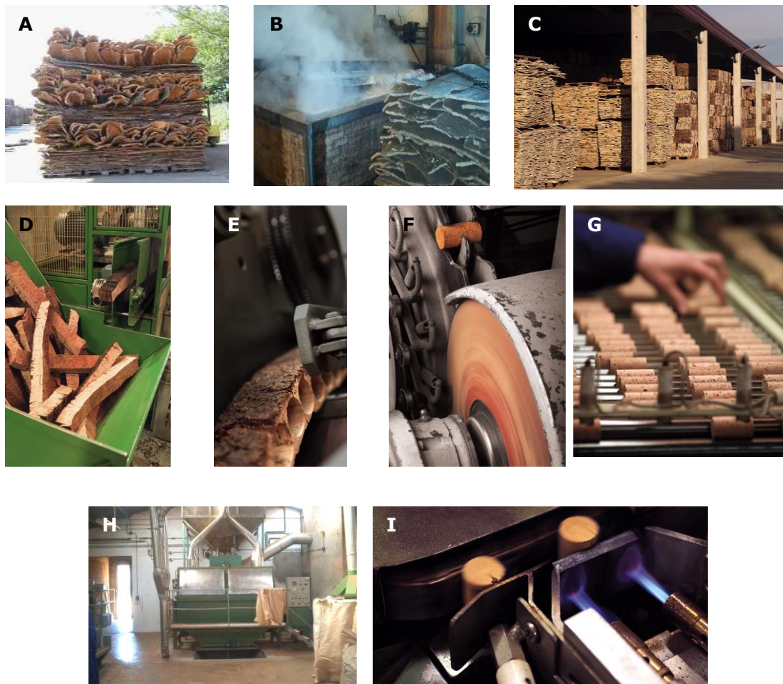
Figura 1.9 Fases del procés de fabricació dels taps de suro. Font: Aecork.
