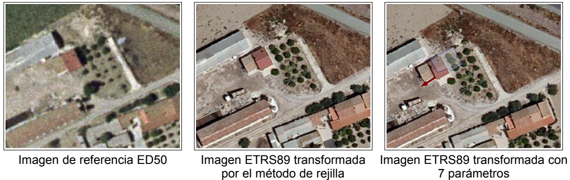
Figura 4: Diferencias observadas en la transformación de ETRS89 a ED50. El desplazamiento medio observado entre b) y c) es de 8,8m NE-SO.
