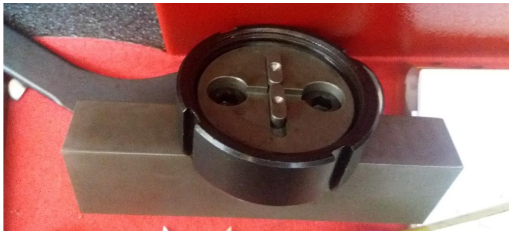
Figura 22: Detall cargols unió ATAP i punxó doblegat actual de la màquina
