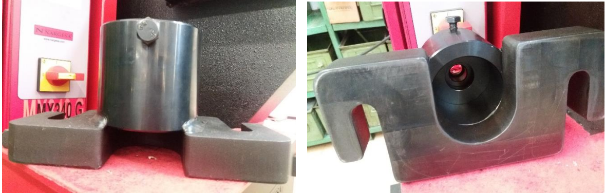
Figura 23: Portamatriu de punxonat actual de la màquina. Sistema per evacuar el rebuig.
