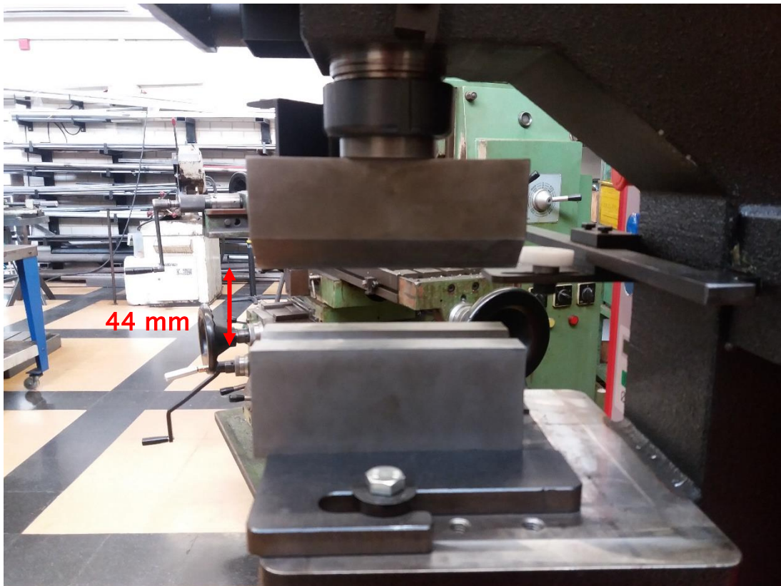
Figura 19: Distància vertical actual entre el punxó i la matriu de doblegat.
