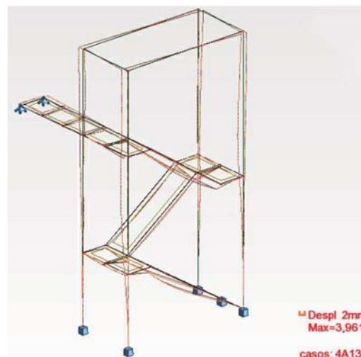
IMATGE MODEL ESTRUCTURAL_DEFORMADA
