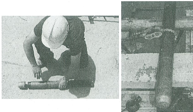
Figura 2. Aspecte que presenta l'agafamostres durant el seu muntatge (esquerra) i amb la mostra inalterada en el seu interior (dreta).
