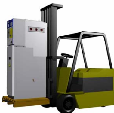
Figura 2.1: Elevación de celda modular cgm.3 mediante carretilla elevadora
