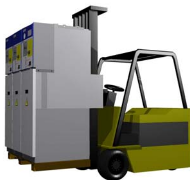
Figura 2.4: Elevación de un conjunto de funciones de cgm.3 mediante carretilla elevadora
