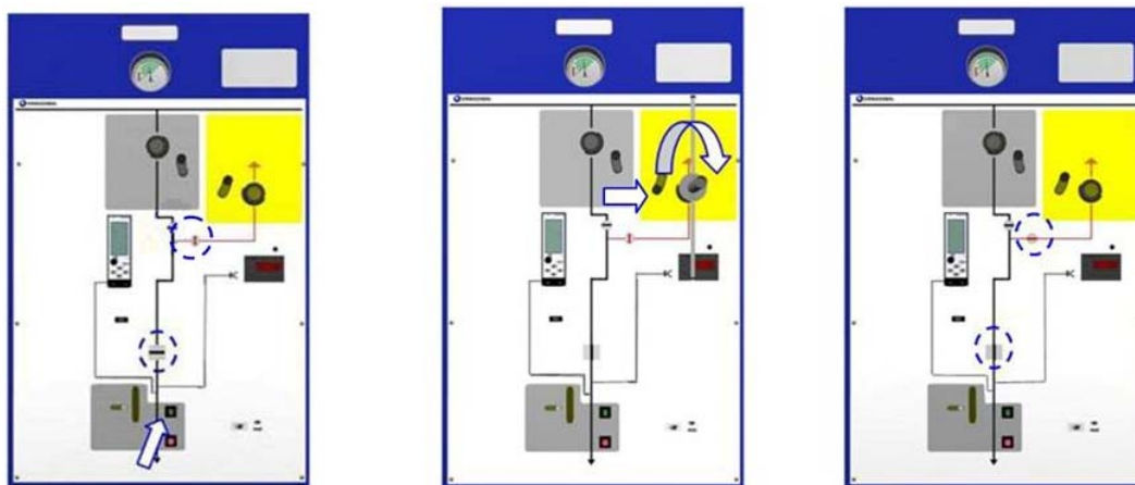
Figura 5.42: Puesta a tierra desde seccionamiento para mecanismo A(M)V
