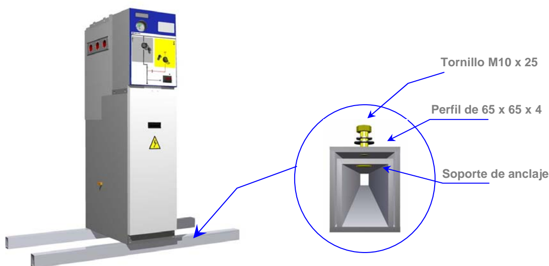
Figura 4.2: Ubicación de celdas sobre perfil
