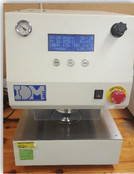
Figura 31 Aparell assaig de rebentament
