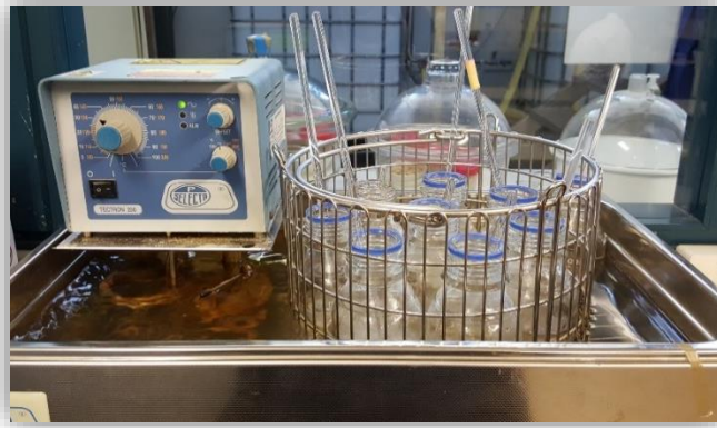
Figura 19 Procés de determinació de la lignina Klason
