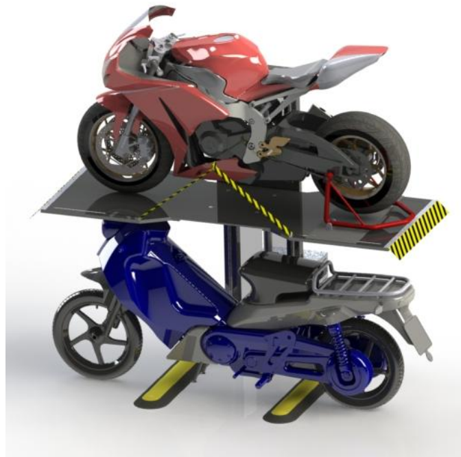
Figura 1 Elevador per l'aprofitament d'espai en garatges
