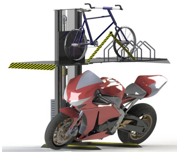
Figura 3 Rampes per facilitar l'aparcament de la motocicleta i adaptació per bicicletes
