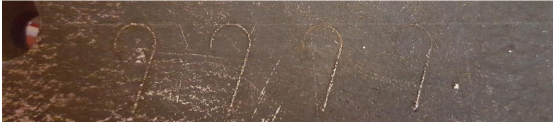
Figura 20: Processat a 100 watts amb valors de velocitat d'escanejat de 6000, 9000, 10500 i 12000 mm/min
