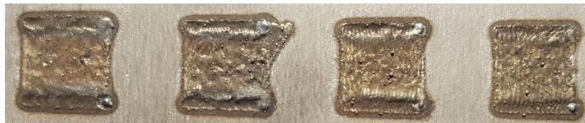
Figura 38: Processat a 170 watts amb valor de velocitat d'escanejat de 12000 mm/min amb overlapping de 50, 60, 80 i 100%
