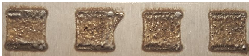
Figura 36: Processat a 130 watts amb valor de velocitat d'escanejat de 12000 mm/min amb overlapping de 50, 60, 80 i 100%
