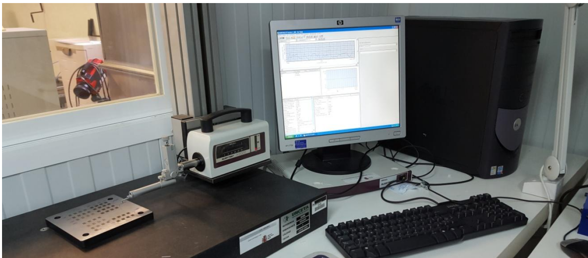
Figura 14: Rugosímetre Mitutoyo SurfTest SV-2000 amb Programa d'adquisició de dades Surfpak
