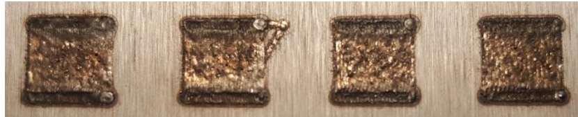
Figura 28: Processat a 130 watts amb valor de velocitat d'escanejat de 9000 mm/min amb overlapping de 50, 60, 80 i 100%
