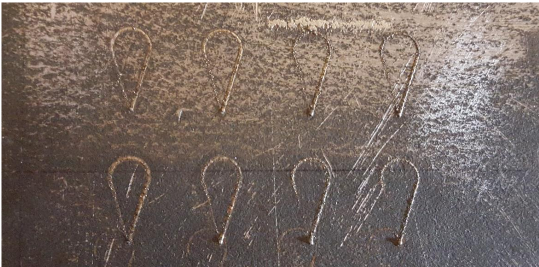
Figura 22: En la part superior processat a 130 watts amb valors de velocitat de 6000, 9000, 10500 i 12000 mm/min En la part inferior processat a 170 watts amb valors de velocitat de 6000, 9000, 10500 i 12000 mm/min
