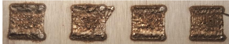
Figura 32: Processat a 130 watts amb valor de velocitat d'escanejat de 10500 mm/min amb overlapping de 50, 60, 80 i 100%
