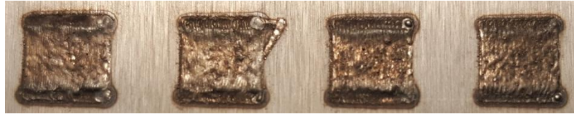
Figura 30: Processat a 170 watts amb valors de velocitat d'escanejat de 9000 mm/min amb overlapping de 50, 60, 80 i 100%
