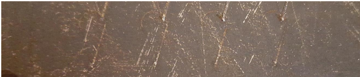
Figura 19: Processat a 80 watts amb valors de velocitat d'escanejat de 6000, 9000, 10500 i 12000 mm/min
