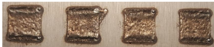
Figura 34: Processat a 170 watts amb valor de velocitat d'escanejat de 10500 mm/min amb overlapping de 50, 60, 80 i 100%
