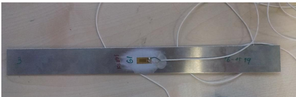
Figura 7: Proveta d'alumini amb les galgues extensiomètriques.
