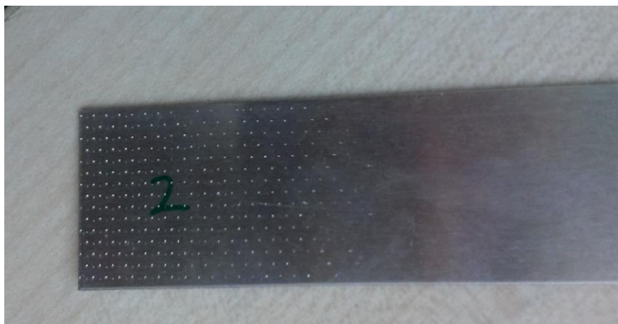
Figura 10: Marques de les mordaces en la proveta.
