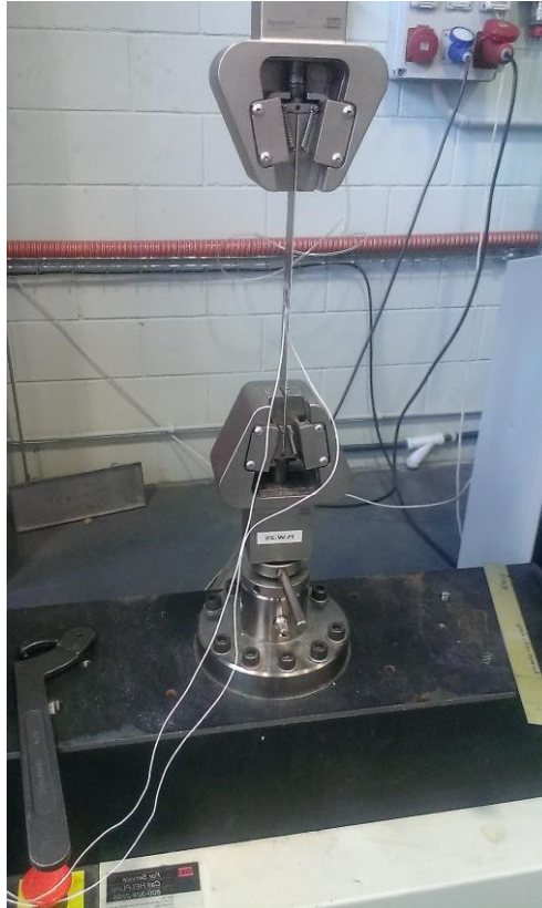
Figura 8: Col·locació de les provetes en les mordaces.
