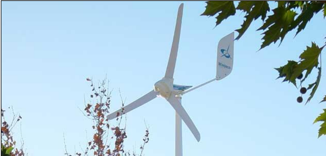
Figura 4: Aerogenerador domèstic d'eix horitzontal amb el rotor a sobrevent.
