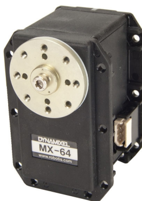
Figura 2.11. Servomotor Dynamixel MX-64T de Robotis (imatge extreta de catàleg)
