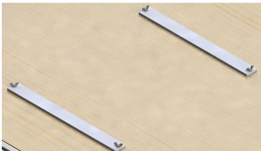
Figura 2.24. Sistema per la fixació del material a tallar DIN A3 al taulell
