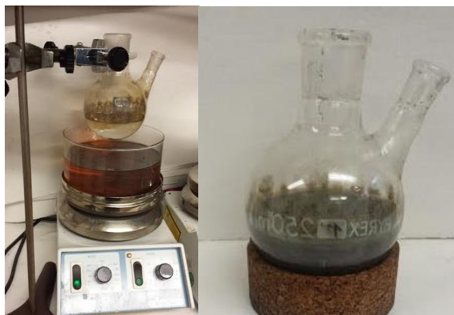
Figura 4.5 Solución antes y después de la síntesis de los AgNWs.
