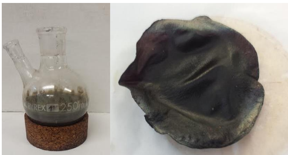
Figura 4.4 Solución de color gris oscuro y el nanopapel hecho vía "casting".
