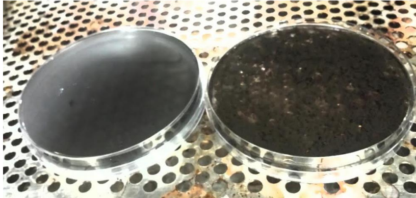
Figura 4.8 Formación del nanopapel vía "casting" antes y después de un tiempo determinado.
