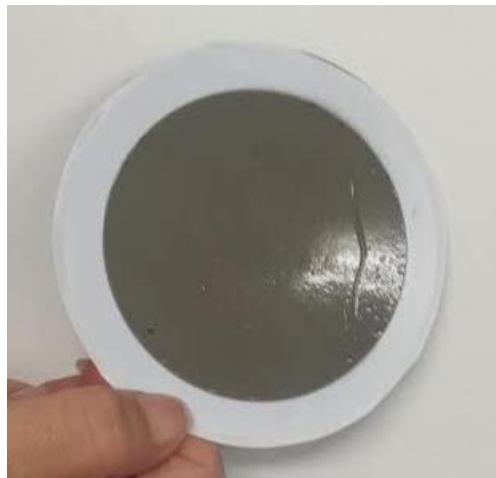
Figura 4.9 Formación del nanopapel vía filtración al vacío.
