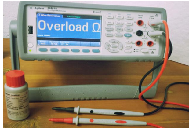
Figura 3.11 Multímetro digital y pintura de plata.
