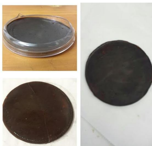
Figura 4.6 Nanopapel conductor siguiendo el método de "casting"
