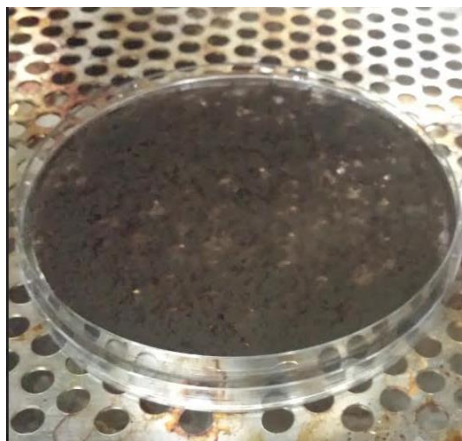
Figura 4.7 Aglomeración de las CNF y los AgNWs.
