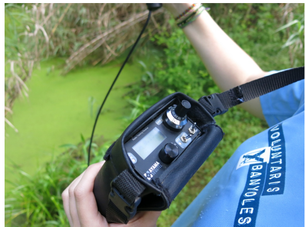
Imatge 13: detall del receptor AYAMA SEGUTEL. Font: pròpia.
