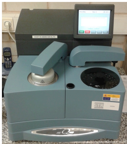
Figura 3.8. Calorímetre Diferencial d'Escaneig (DSC) Q 2000 de TA Instruments.
