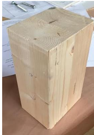
Il·lustració 4.44. Imatge d'una mostra de fusta GL24 dimensionada (dimensions 30x15x14cm)
