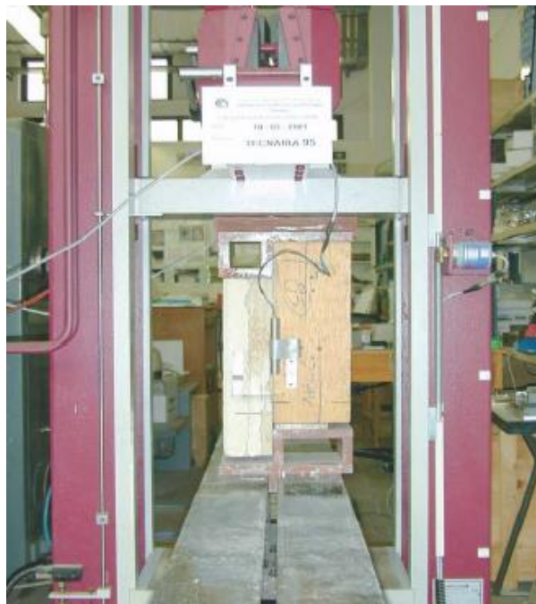
Il·lustració 4.36. Imatge proposta equip d'assaig d'estudi n°2 (posició vertical)
