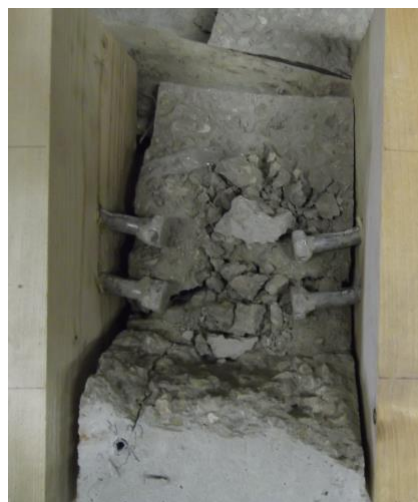
Il·lustració 5.42. Interpretació falla formigó PT1.03
