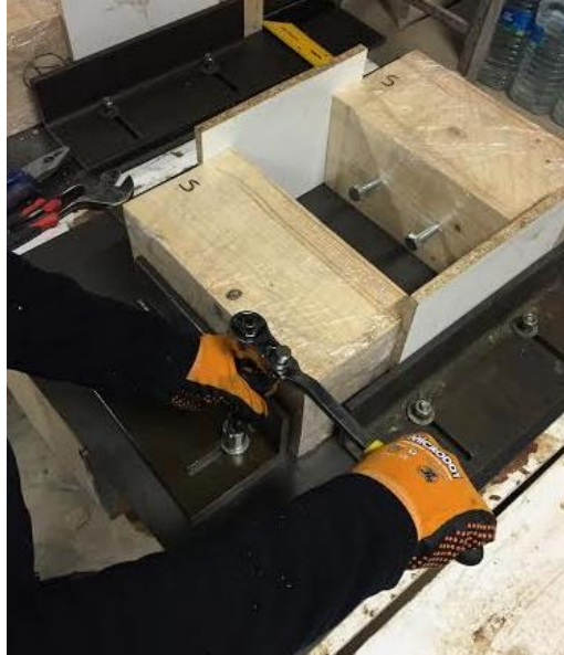
Il·lustració 4.86. Collat de les platines "L" a la platina inferior
