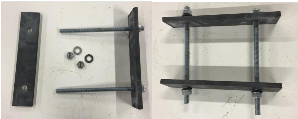
Il·lustració 4.107. Conjunt de compressió interna del formigó
