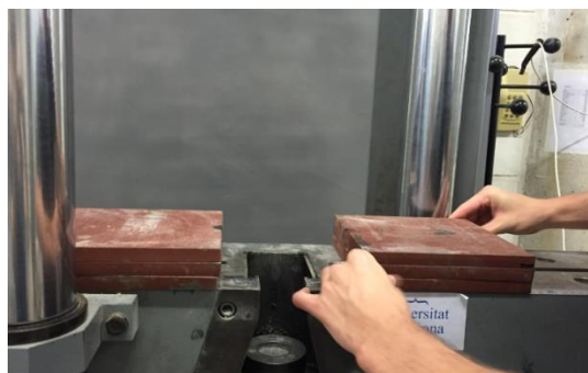
Il·lustració 4.99. Procés de col·locació de platines de suport
