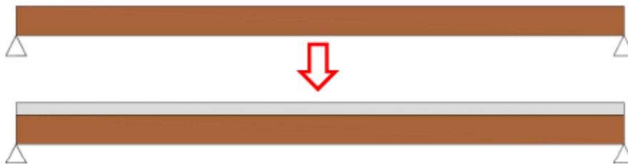
Il·lustració 4.1. Representació del pas del forjat de fusta, al forjat de fusta-formigó
