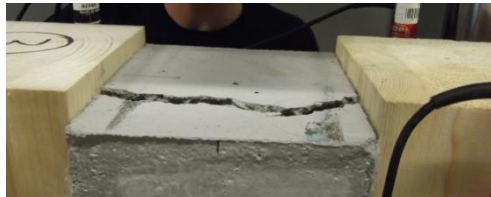
Il·lustració 5.13. Interpretació falla formigó PT3.02
