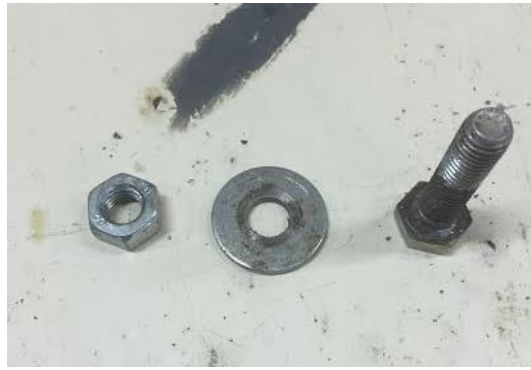
Il·lustració 4.46. Equip d'ancoratge del material auxiliar d'encofrat
