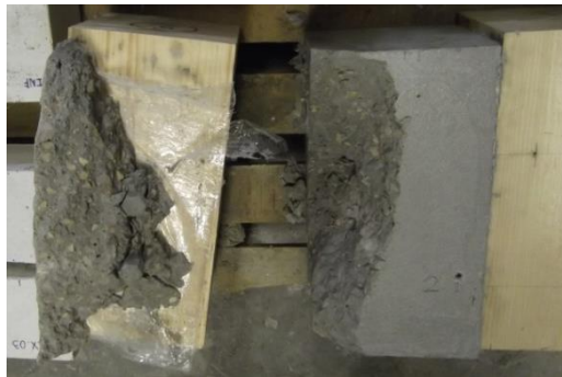
Il·lustració 5.28. Interpretació falla formigó PT2.02
