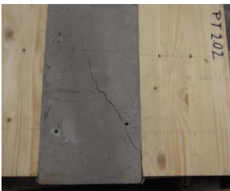
Il·lustració 5.25. Interpretació falla formigó PT2.02
