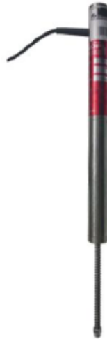
Il·lustració 4.58. Transductors utilitzats durant l'assaig
