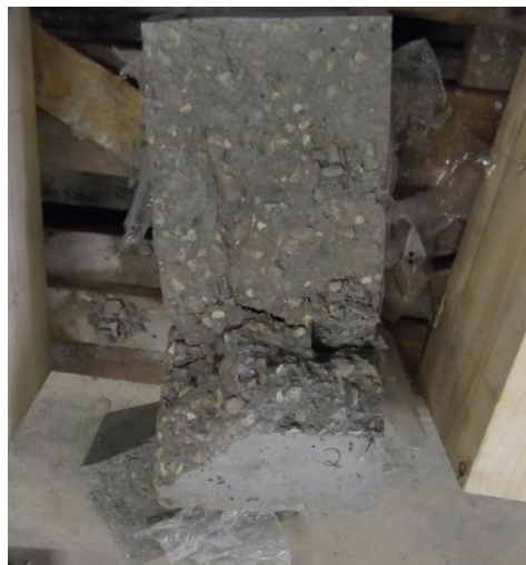
Il·lustració 5.17. Interpretació falla formigó PT3.02
