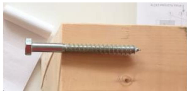
Il·lustració 4.77. Plantejament de tirafons a l'element de fusta GL24
