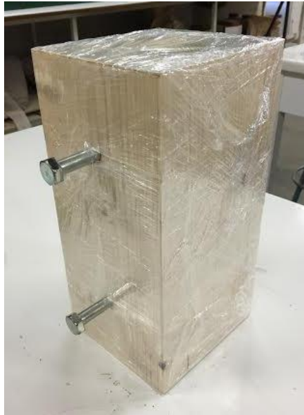
Il·lustració 4.80. Element de fusta impermeabilitzat amb film
