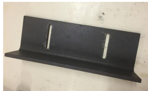
Il·lustració 4.48. Esquema Autocad i fotografia platina "L" llarga
