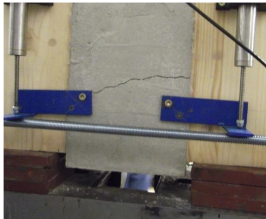
II-lustració 5.11. Interpretació falla formigó PT3.01
