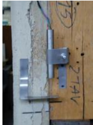
Il·lustració 4.37. Imatge col·locació del transductor de l'equip d'assaig d'estudi nº2 (posició vertical)
