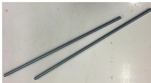
Il·lustració 4.54. Barres d'acer roscades ajusta-proveta (Ø12mm)
