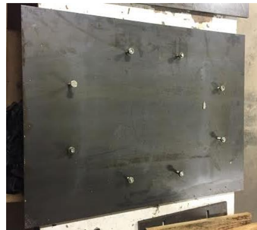
Il·lustració 4.50. Esquema Autocad i fotografia platina de base 600x600x10mm
