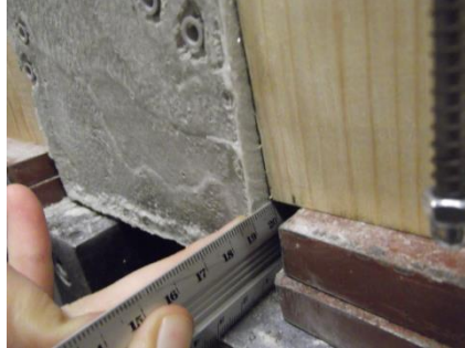
Il·lustració 5.3. Interpretació falla formigó PT4.01
