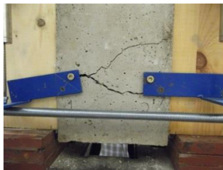
Il·lustració 5.15. Interpretació falla formigó PT3.02
