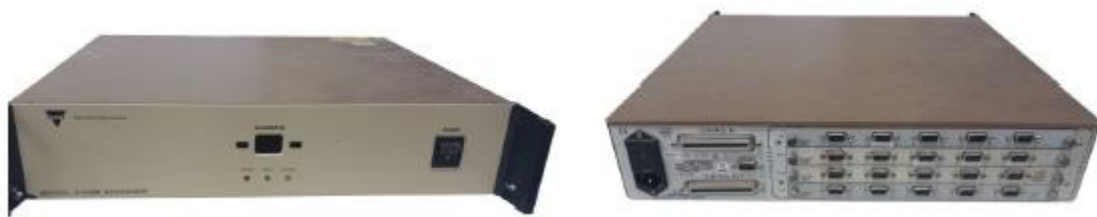
Il·lustració 4.59. Vista anterior i posterior d'equip d'adquisició de dades
