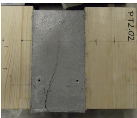
Il·lustració 5.26. Interpretació falla formigó PT2.02
