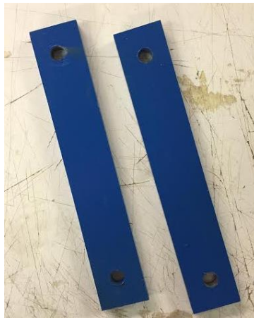
Il·lustració 4.53. Platina d'acer de collat de proveta (250x50x10mm)
