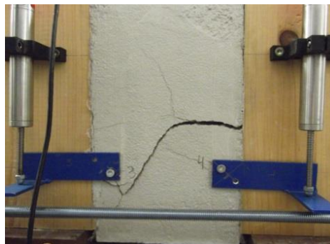
Il·lustració 5.30. Interpretació falla formigó PT2.03
