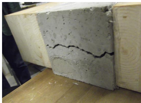
Il·lustració 5.5. Interpretació falla formigó PT4.02
