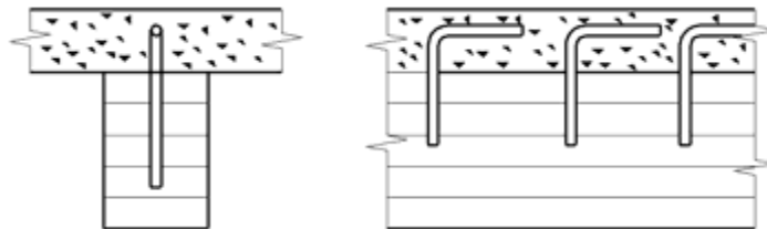
Il·lustració 3.22. Unió mecànica amb barra d'acer corrugada
