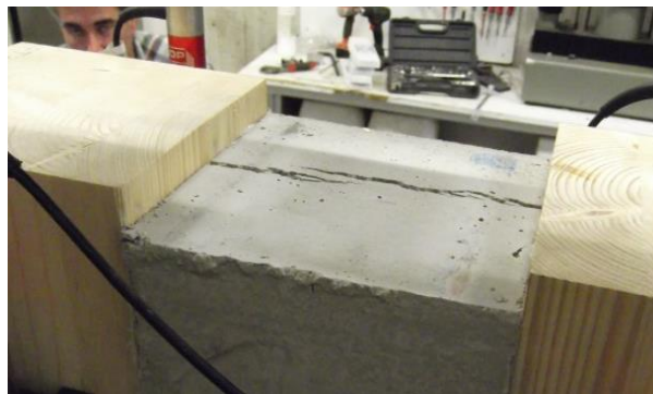
II-lustració 5.10. Interpretació falla formigó PT3.01
