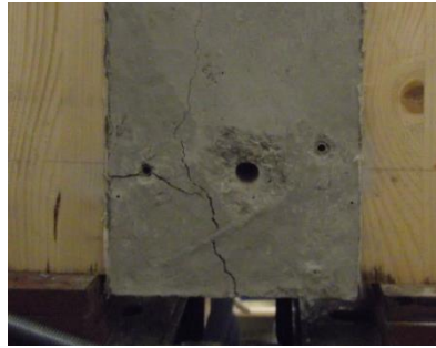
Il·lustració 5.19. Interpretació falla formigó PT3.03
