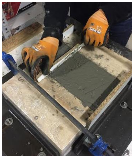
Il·lustració 4.89. Enrasat del formigó
