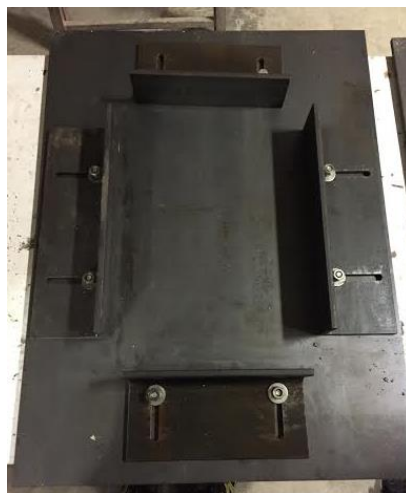
Il·lustració 4.83. Planteig inicial de les platines "L" del muntatge d'encofrat
