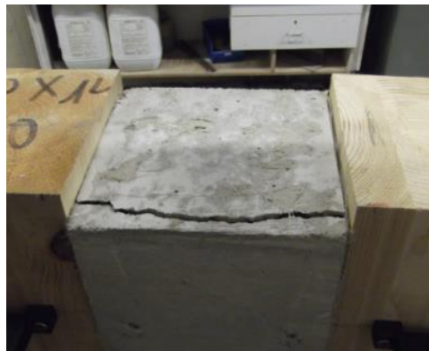
Il·lustració 5.39. Interpretació falla formigó PT1.03
