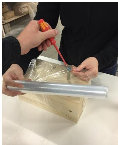
Il·lustració 4.79. Col·locació de film per impermeabilitzar
