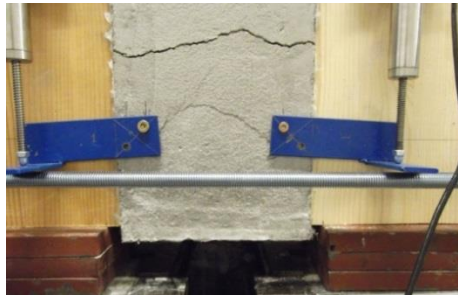
II-lustració 5.22. Interpretació falla formigó PT2.01
