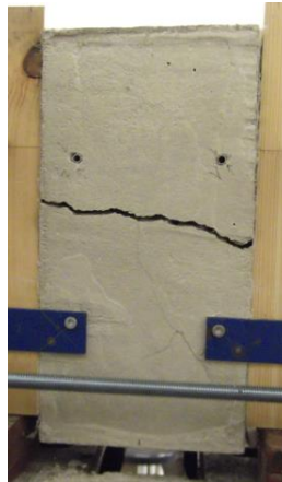
Il·lustració 5.41. Interpretació falla formigó PT1.03
