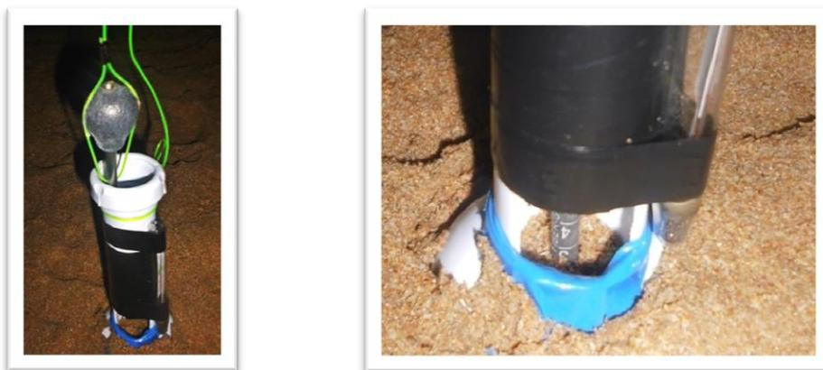
**Figura 4:** Imágenes del instrumento empleado para medir la dureza del sustrato. **A la izquierda.** El tubo de plástico enterrado en la arena con la vara metálica y el peso antes de dejarlos caer. **A la derecha.** Un ejemplo donde se observan los centímetros que la vara ha penetrando en el sustrato.
