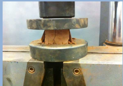
Figura 78. Compresió de proveta
