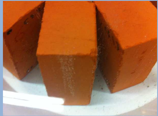
Figura 74. Procés de saturació de proveta
