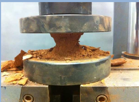
Figura 81. Resultats de compressió de proveta
