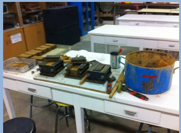
Figura 18. Conformació de provetes
