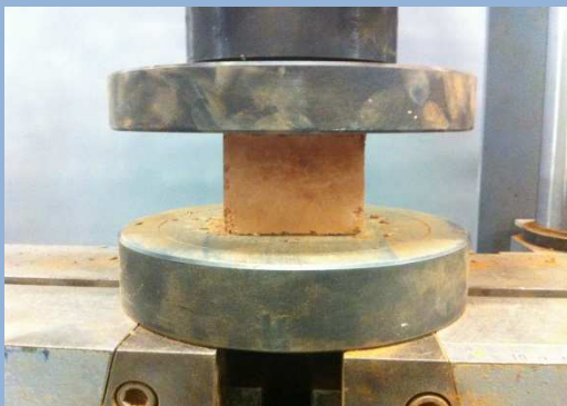
Figura 79. Proveta en la premsa hidràulica
