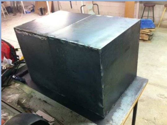
Figura 49. Soldadura de les parets de la caixa
