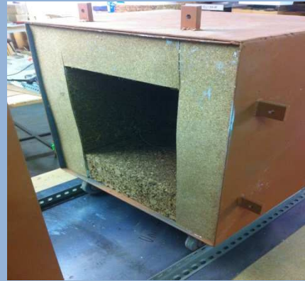
Figura 55. Col·locació del suro a l'interior
