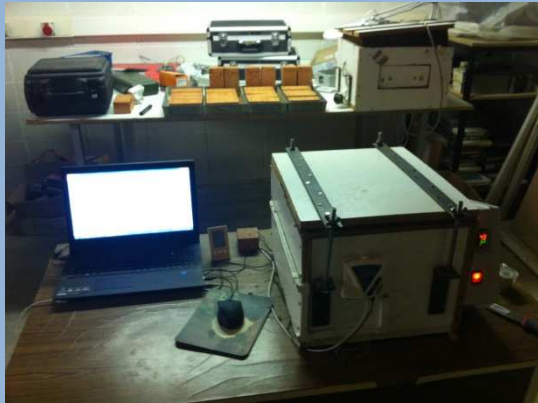
Figura 36. Caixa tèrmica en funcionament
