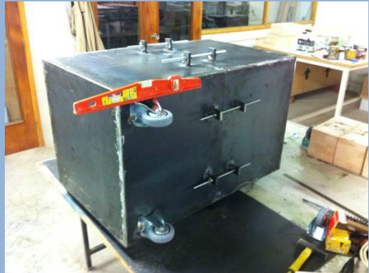
Figura 50. Soldadura de les rodes i les fixacions
