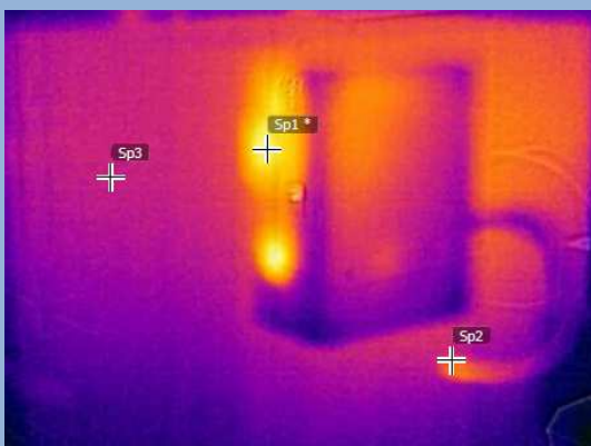
Figura 70. Termografia cambra i mecanismes
