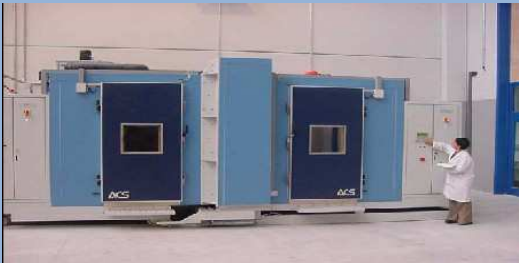
Figura 29. Caixa calenta normalitzada segons norma UNE 8990
