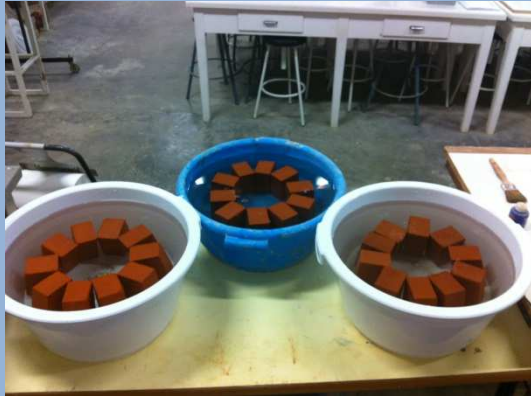
Figura 73. Provetes submergides en aigua
