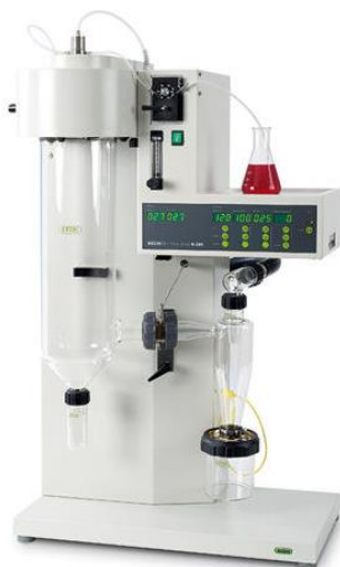
Figura 1. Imatge del Mini Spray Dryer B-290 de Büchi utilitzat durant aquestes pràctiques. ("Mini Secador por aspersion B-290 - buchi.com", 2016)
