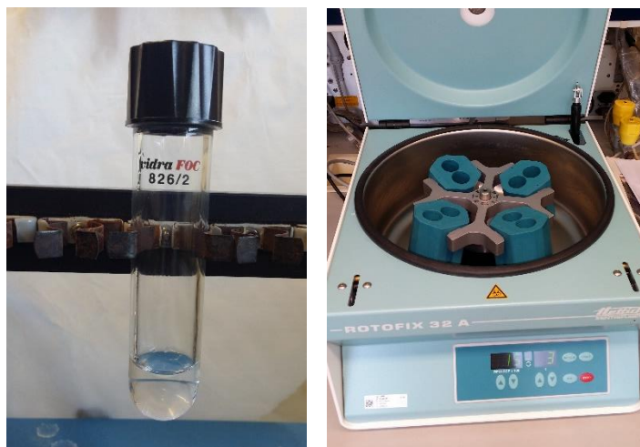
Figura 7. Experiments líquid-líquid. Tub en agitador a l'esquerra i centrífuga a la dreta.
