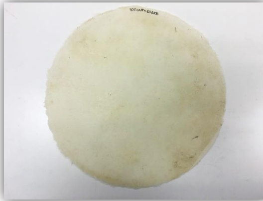
Figura 3.20 Material nanocompost obtingut pel mètode de filtració
