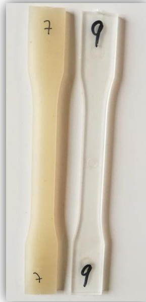
Figura 4.11 Comparativa d'aspectes entre una proveta de PLA (dreta) i una de PLA+CNF 2/3 diglyme (consistència 2,59%) (esquerra)
