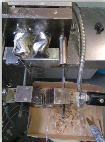
Figura 3.9 Aspecte visual de la mescladora Brabender desmuntada i amb part del producte adherit
