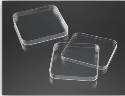
Figura 3.21 Placa de Petri utilitzada en la formació dels films per evaporació
