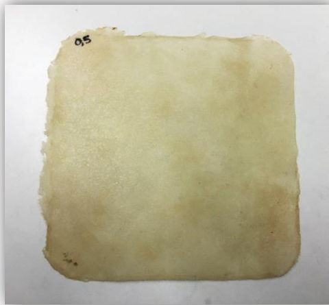
Figura 3.22 Material nanocompost obtingut pel mètode d'evaporació
