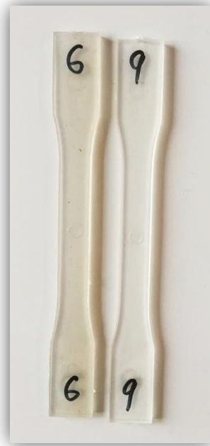
Figura 4.9 Comparativa d'aspectes entre una proveta de PLA (dreta) i una de PLA degradat amb aigua (esquerra)
