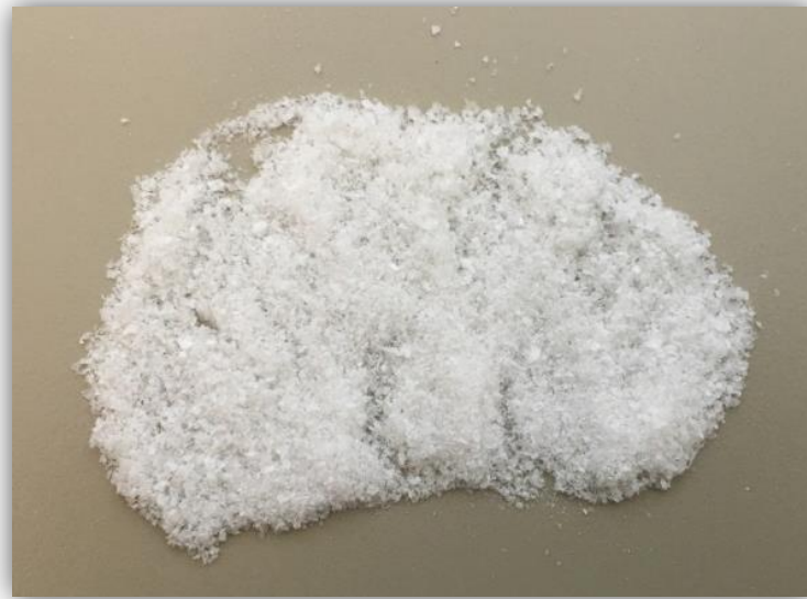
Figura 4.5 Aparència de les CNF un cop han estat liofilitzades i triturades
