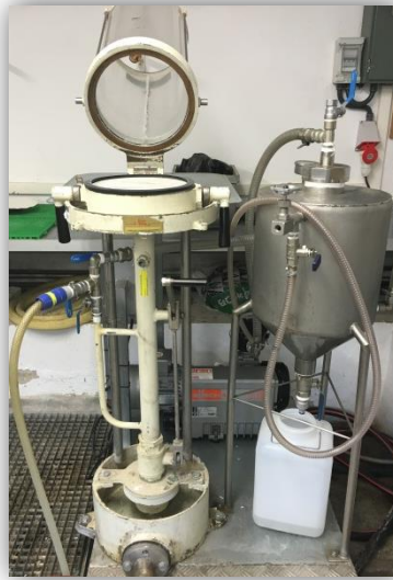
Figura 3.17 Columna de formació manual adaptada amb una bomba de buit
