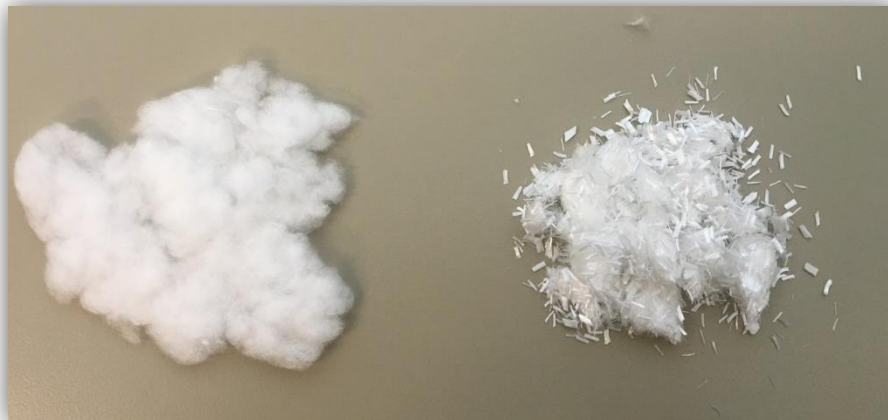
Figura 4.16 Diferència d'aspectes entre la fibra de PLA comercial de 3 mm de longitud (dreta) i la mateixa fibra un cop ha estat triturada (esquerra)
