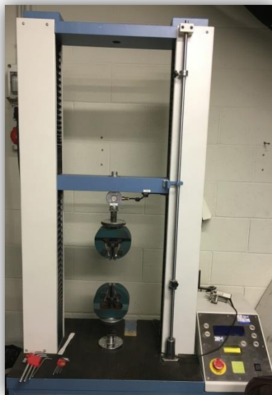
Figura 3.14 Aparell d'assajos universals IDMtest model DTC-10
