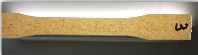
Figura 4.6 Aspecte del material nanocompost, vist a contra-llum, obtingut en l'estratègia 1
