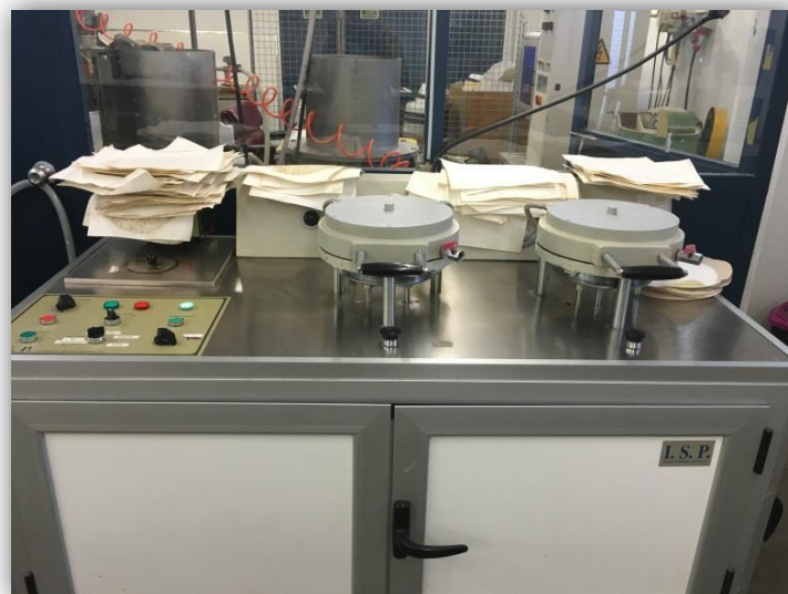
Figura 3.18 Plats assecadors model 786 FH (I.S.P)
