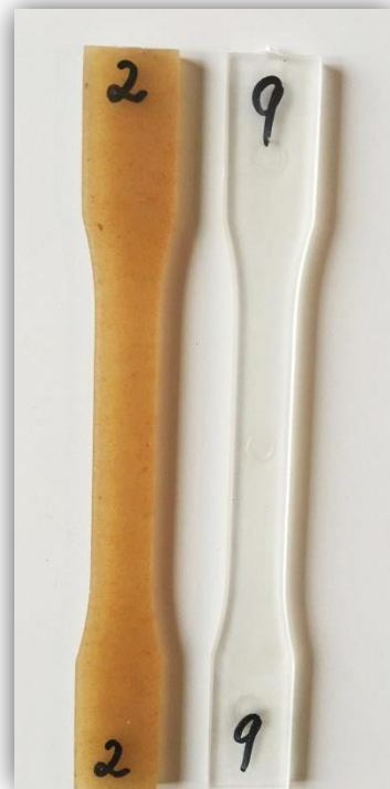
Figura 4.7 Comparativa d'aspectes entre una proveta de PLA (dreta) i una de PLA+CNF liofilitzades (esquerra)
