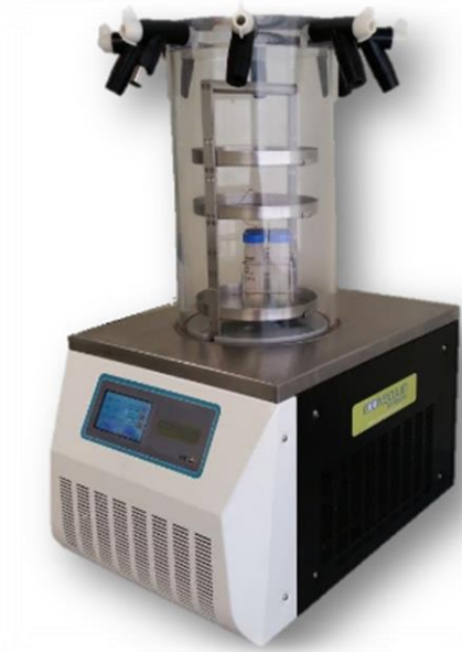
Figura 3.4 Liofilitzador utilitzat en la formació d'aerogels [39].
