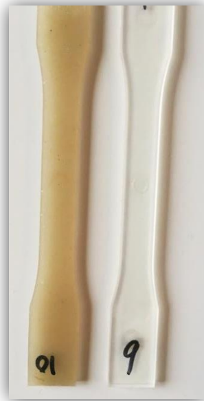
Figura 4.8 Comparativa d'aspectes entre una proveta de PLA (dreta) i una de PLA/CNF aq (esquerra)
