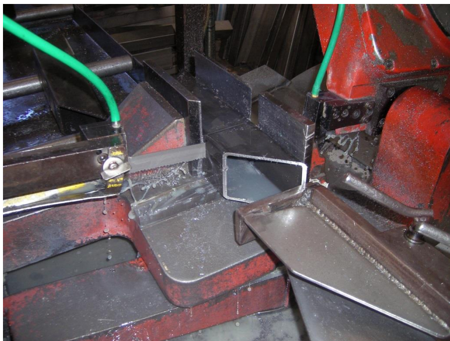
Figura 73: Serratge dels perfils 80x80x4mm a 130mm i 45°
