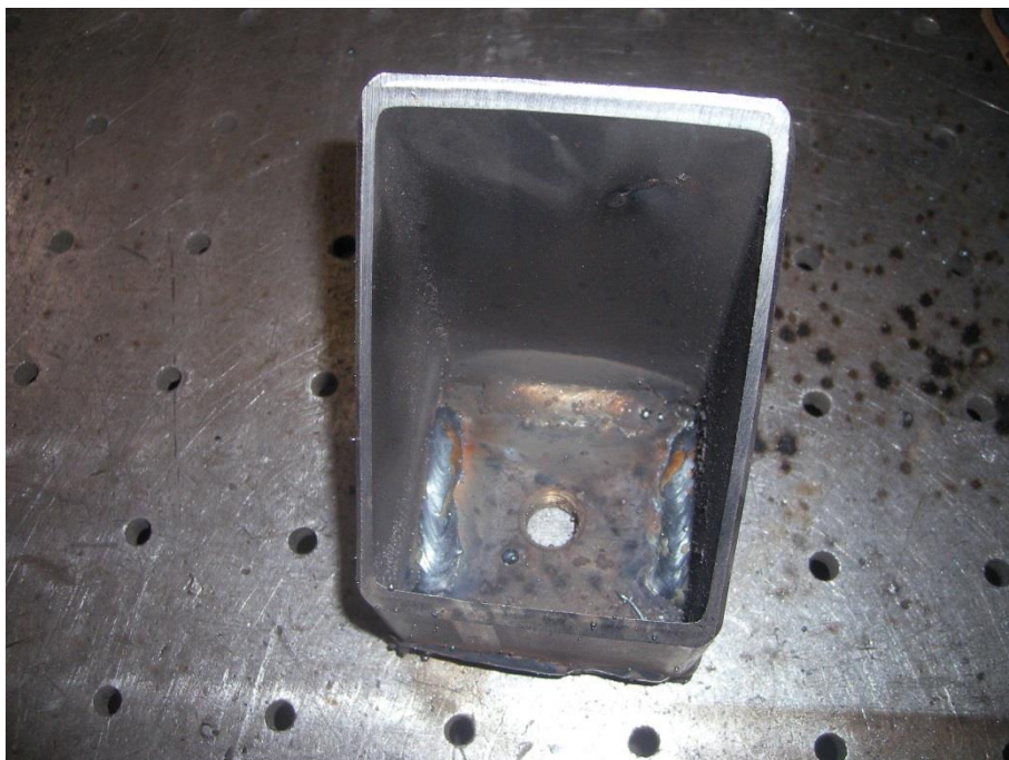
Figura 84: Cordons de soldadura interiors
