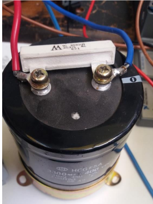
Figura 116: Filtre de condensador i resistència
