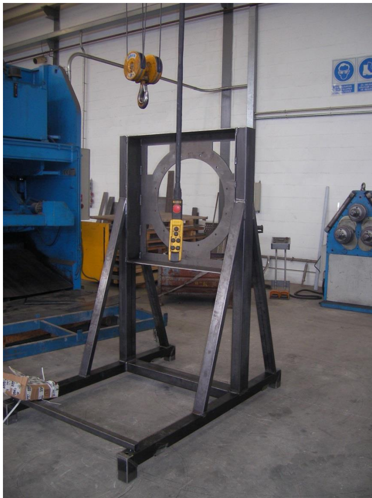
Figura 94: Suport acabat de soldar, amb el travesser complementari
