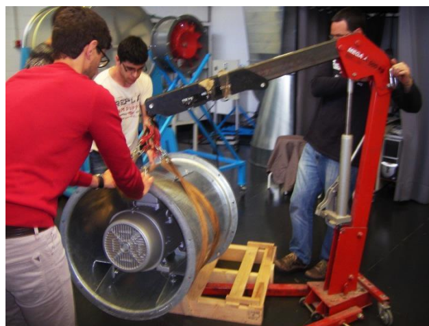
Figura 104: Elevació del ventilador
