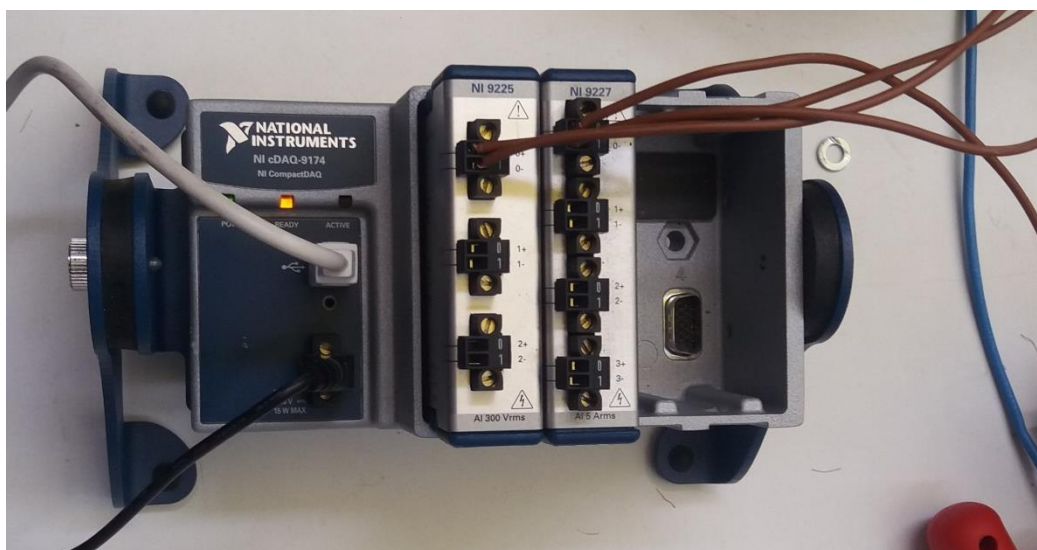
Figura 119: Equip d'adquisició de dades (voltímetre i amperímetre)
