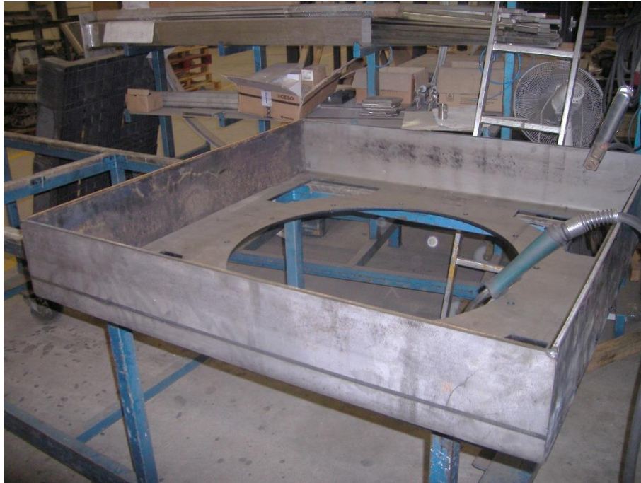
Figura 91: Fixació dels taps laterals
