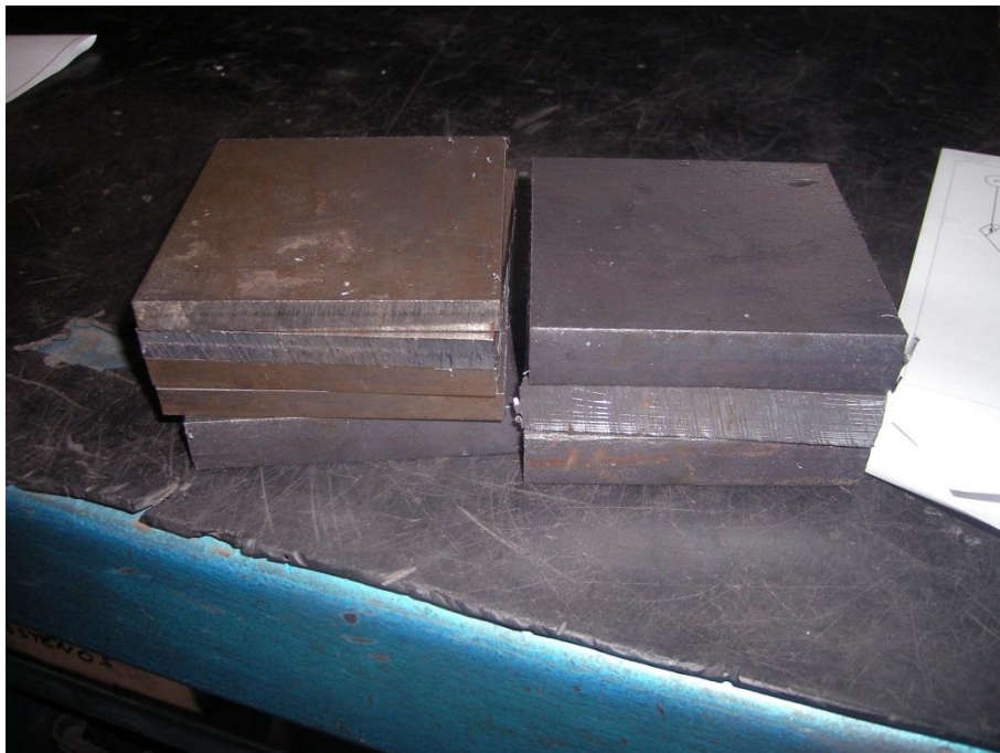
Figura 75: Platines de passamà després de serrar-les
