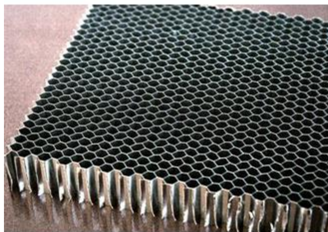
Figura 26: Imatge d'un panell d'alumini de nius d'abella
