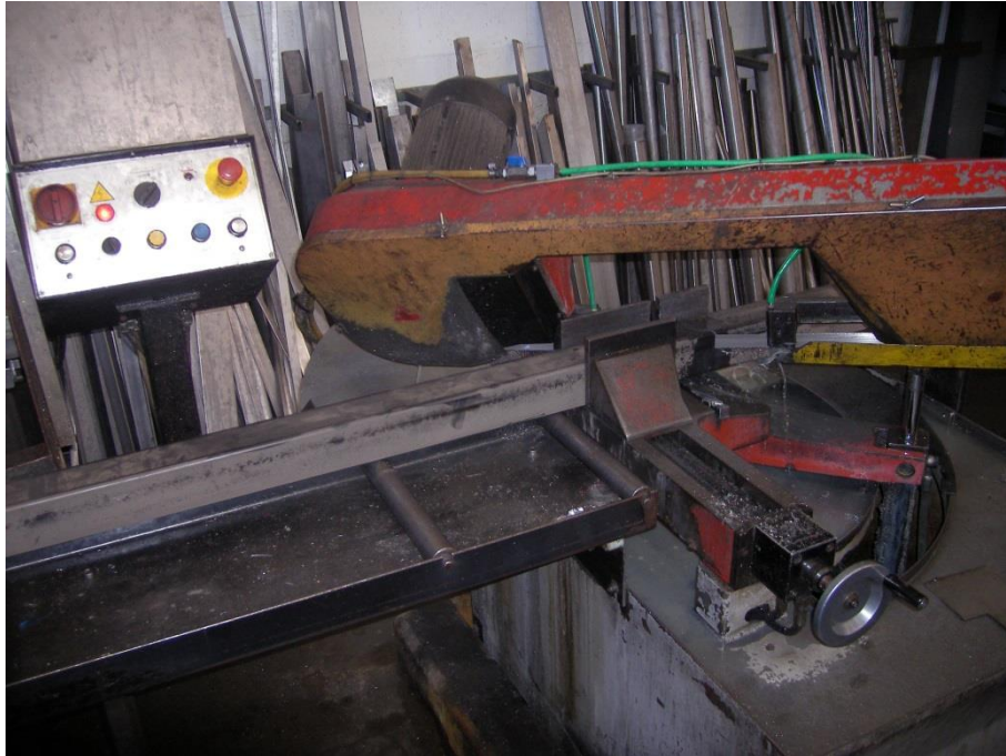
Figura 72: Sistema de fixació i comandament bimanual de seguretat
