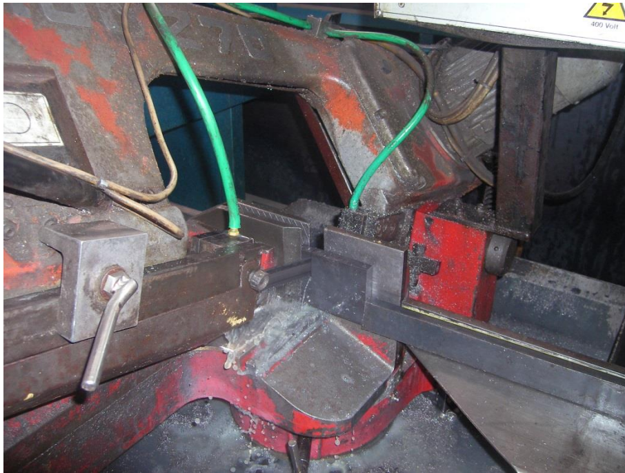
Figura 74: Tall dels passamans utilitzant un retall com topall a 80mm
