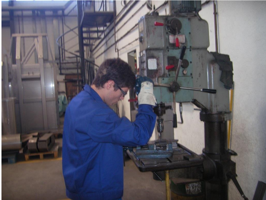
Figura 79: Procés de trepanat del passamans 80x80x8 i 80x80x15 mm
