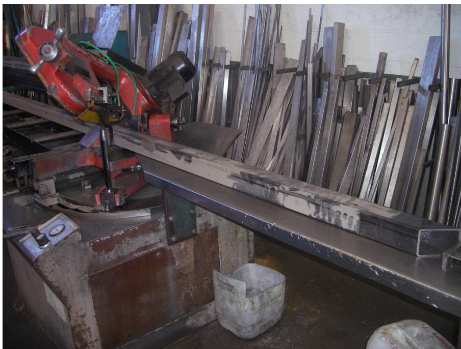
Figura 70: Procés de serratge del tub de 80x80x4 mm
