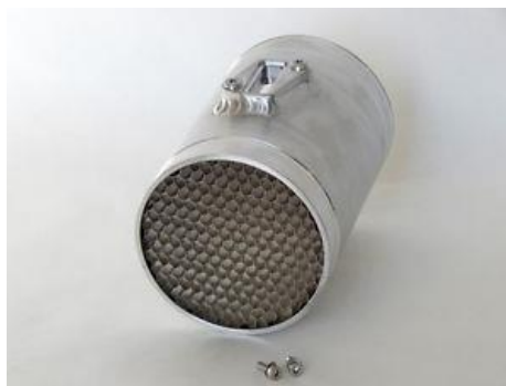
Figura 28: Aplicació de la malla com a condicionador de flux
