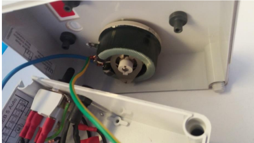
Figura 118: Interior d'un reòstat
