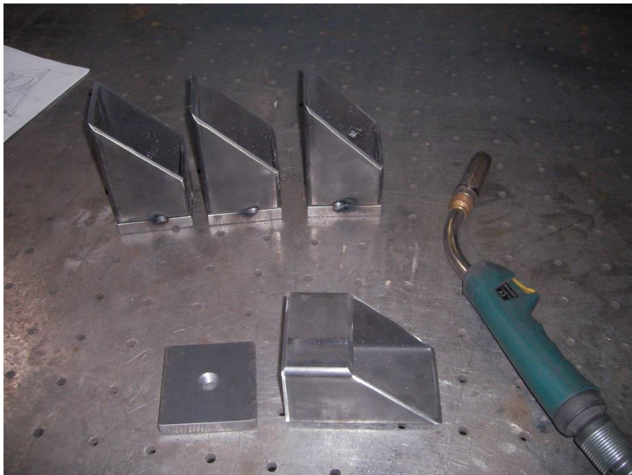
Figura 82: Procés de soldadura entre la platina i els peus del lateral
