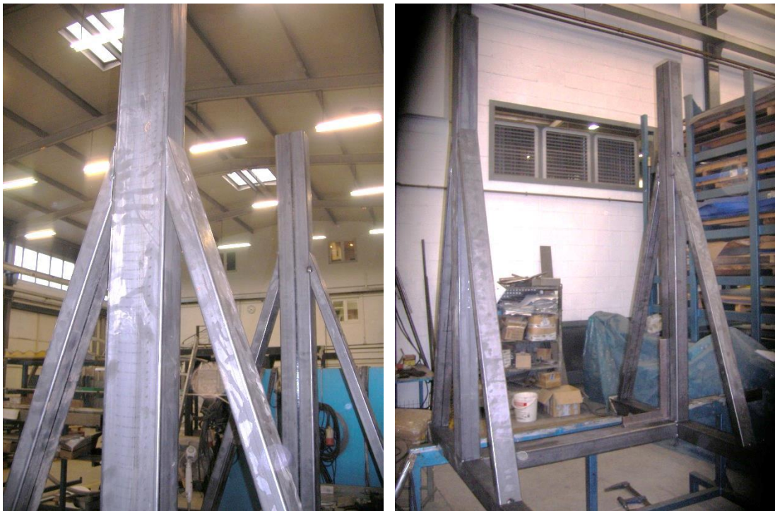
Figura 90: Procés de soldadura dels tornapunts amb l'estructura
