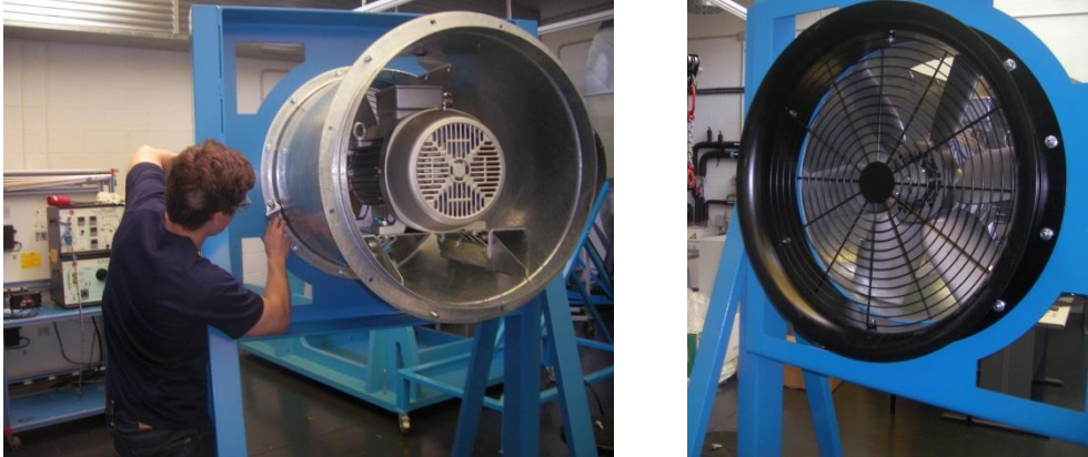
Figura 105: Fixació del ventilador i la protecció amb el suport
