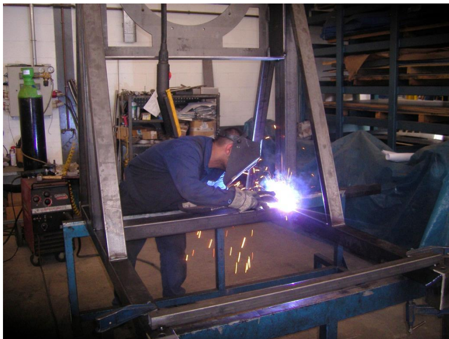
Figura 93: Soldadura de reforç final dels punts anteriors
