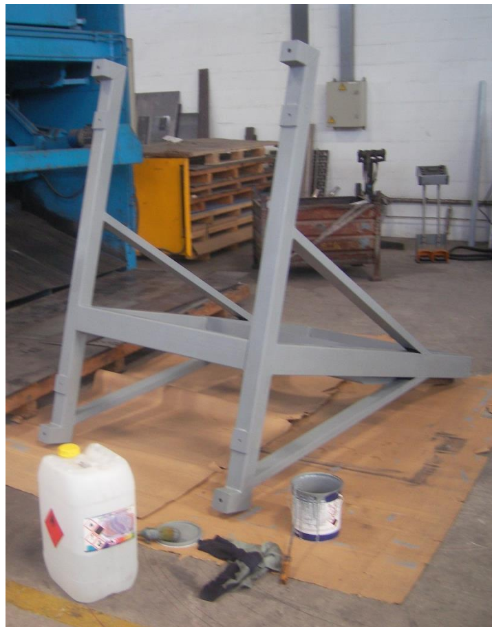
Figura 96: Procés de pintat amb pintura d'imprimació gris
