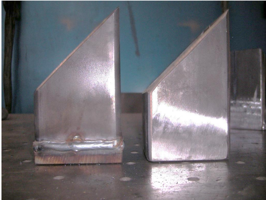
Figura 85: Diferència entre abans i després de polir la peça
