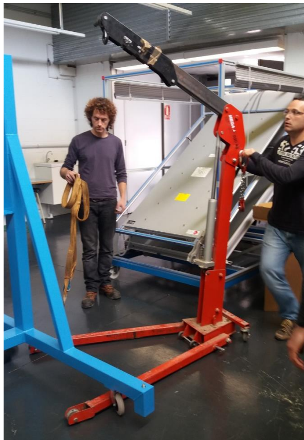
Figura 102: Ploma i bragues utilitzades en l'elevació
