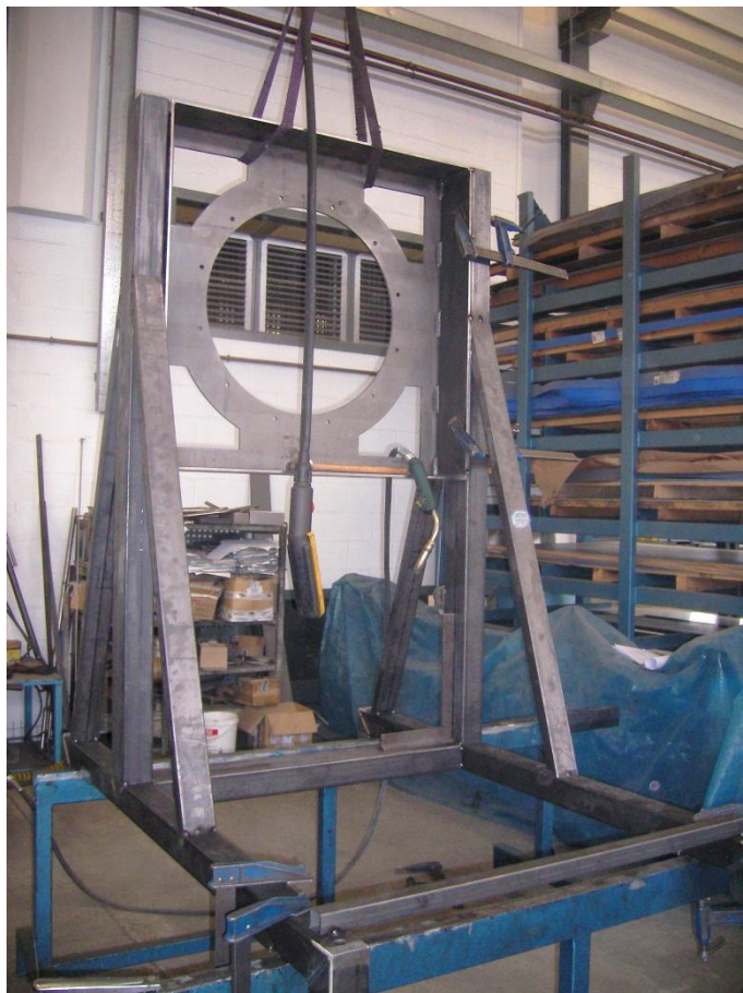
Figura 92: Fixació de la caixa a l'estructura per mitjà de serjants
