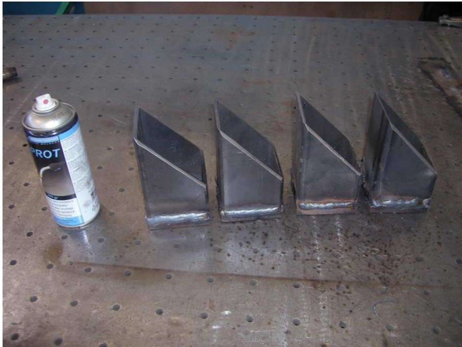
Figura 83: Cordó de soldadura perimetral i esprai antiadherent
