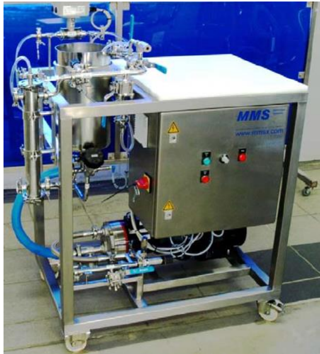
Figura 3.3. Instal·lació d'ultrafiltració MMS SW 18 (MMS AG Membrane Systems) utilitzada per concentrar el plasma. Font: http://www.mmsx.com/content/products/Bench_Systems.php
