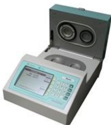
Figura 3.10. Equip Novasina Lab Master-aw utilitzat per mesurar l'activitat de l'aigua.
