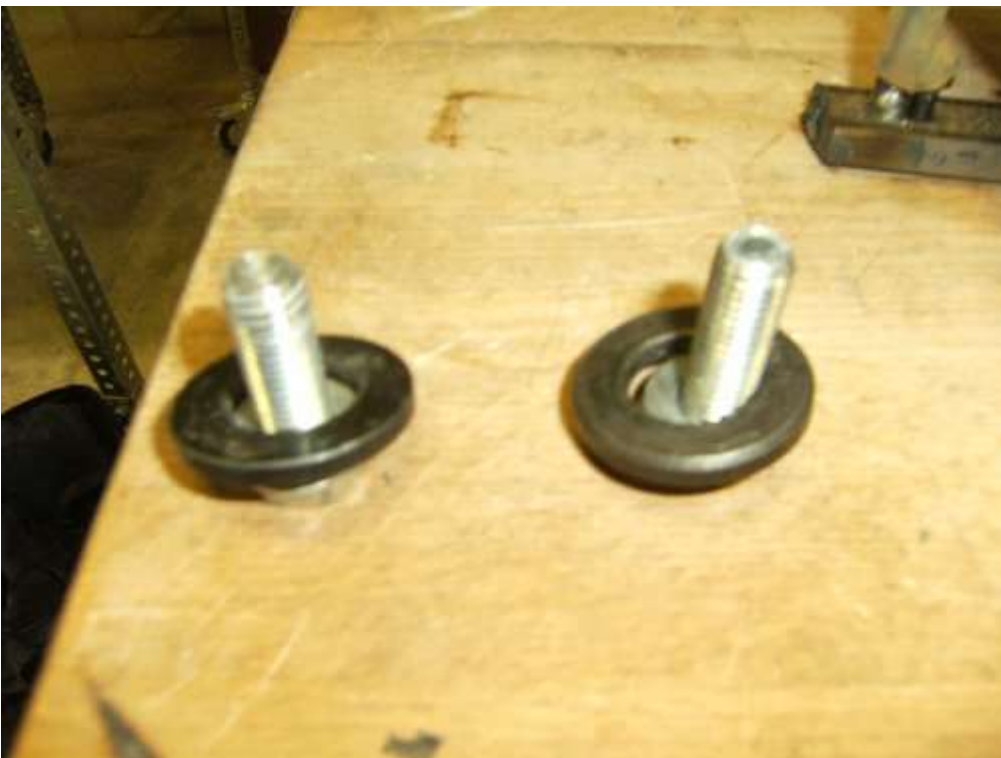
Figura 5.10.4.4d – Unions cargolades després de l'assaig
