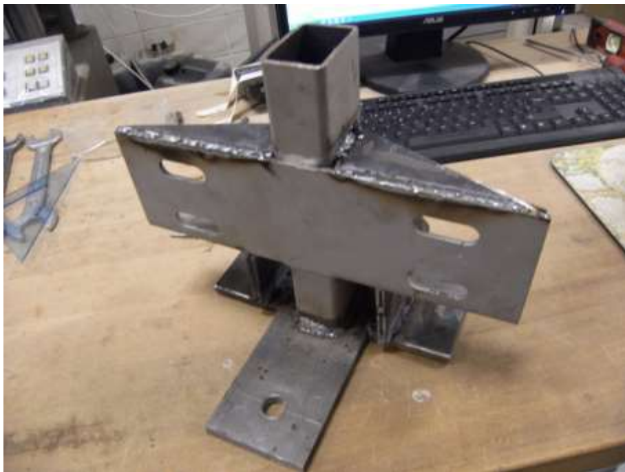
Figura 5.5.1f – Estat de la peça de suport amb cartelles i rigiditzadors (vista 2)
