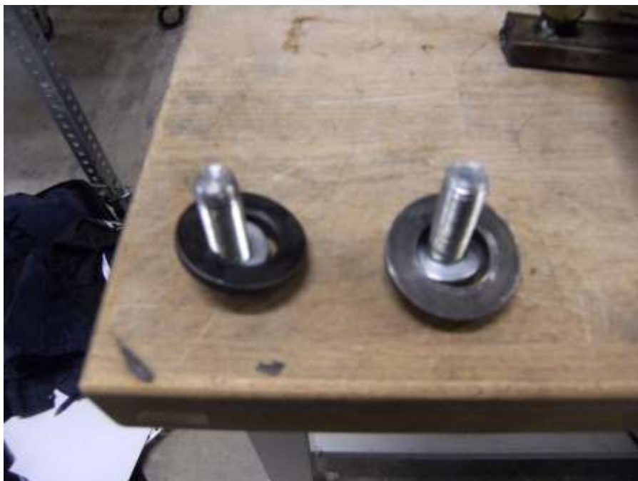
Figura 5.10.5.4b – Unions cargolades després de l'assaig
