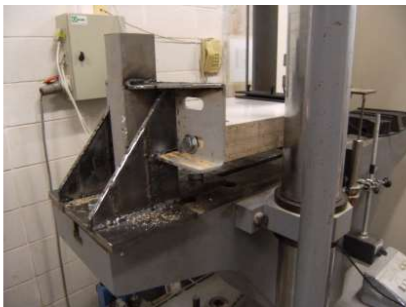
Figura 5.5.3e – Fixació de la peça de fusta i la peça de suport (vista 2)
