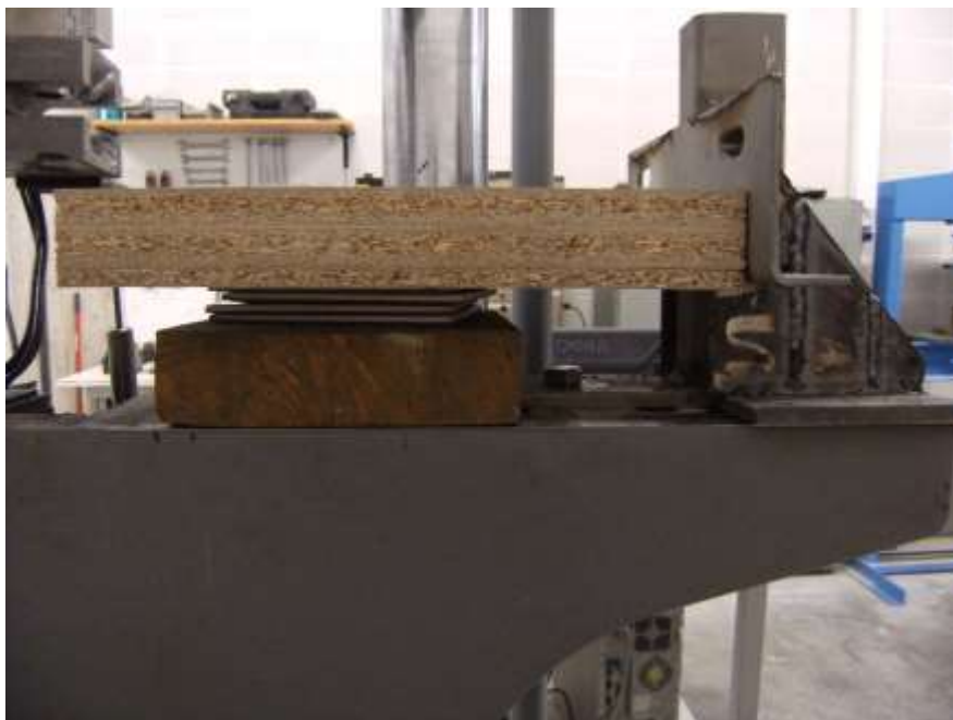
Figura 5.5.3d – Fixació de la peça de fusta i la peça de suport (vista 1)
