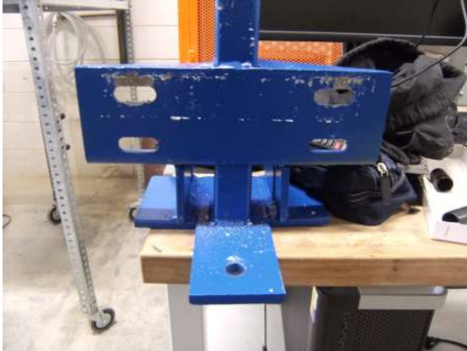
Figura 5.11a – Estat de la peça de suport després dels assaigs (vista 1)
