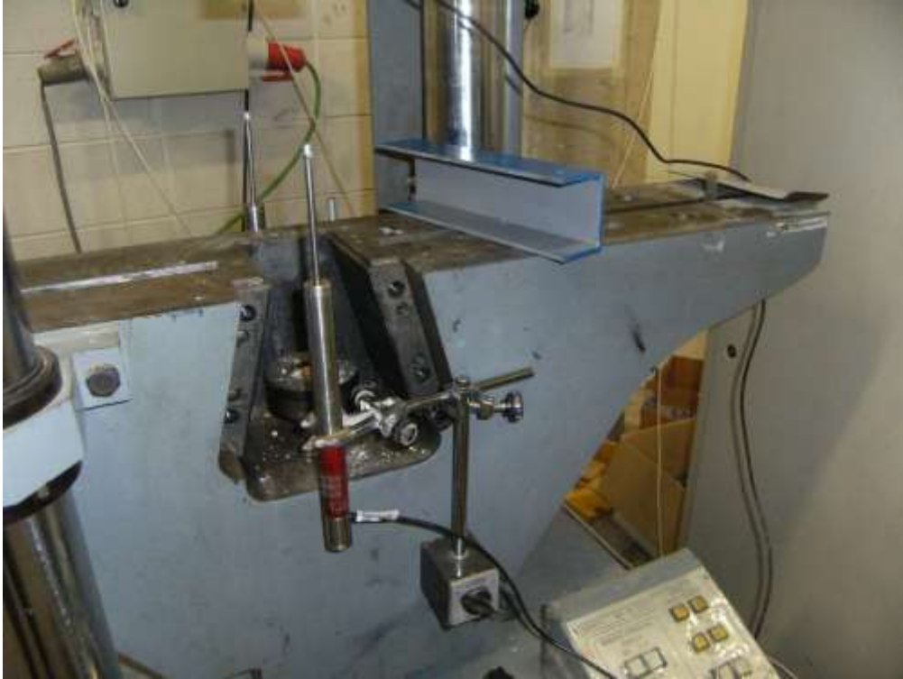
Figura 5.10.1b – Col·locació dels transductors RDP
