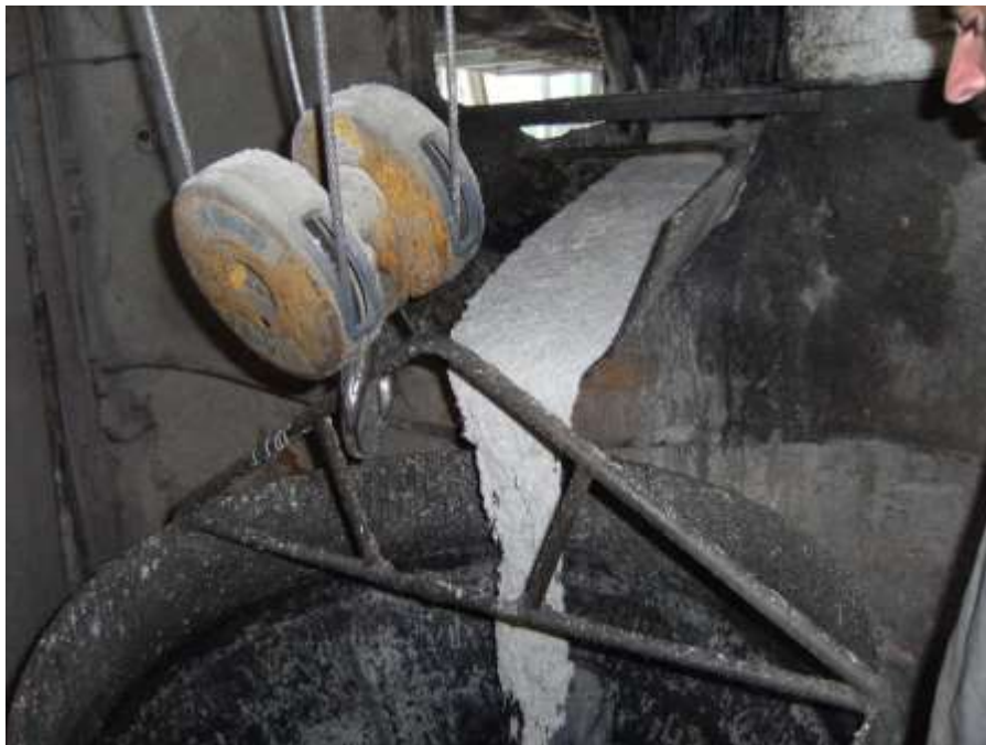
Figura 4.4.2j – Abocat d'ammassada de prova a cubilot (vista 1)
