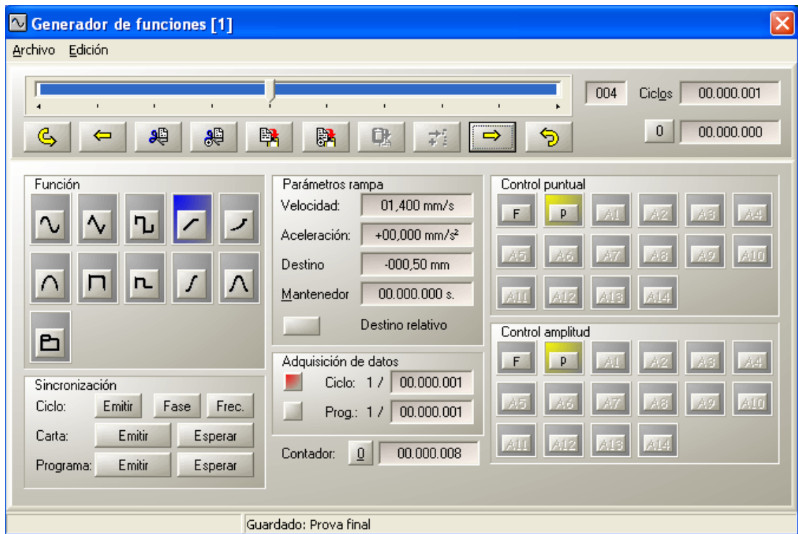
Figura 5.9.2e – Funció rampa de 0 mm a -0,50 mm
