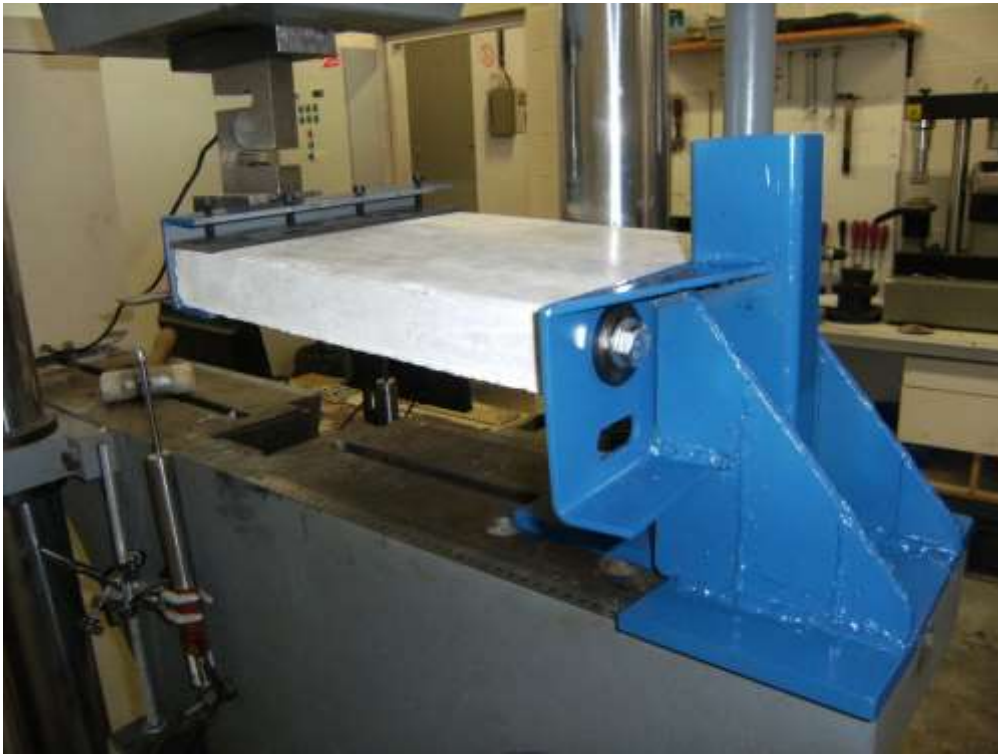
Figura 5.10.2.1c – Acoblament a la peça de suport
