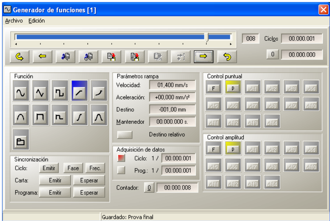
Figura 5.9.2i – Funció rampa de -0,50 mm a -1,00 mm
