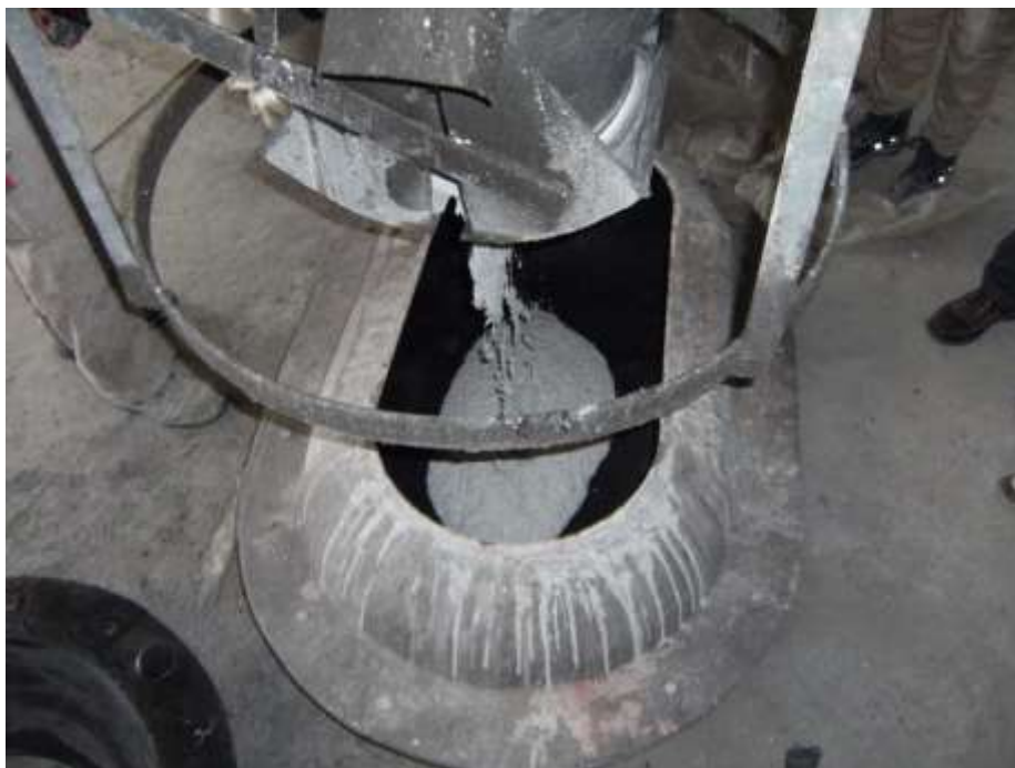
Figura 4.4.2m – Abocat d'amassada de prova a dipòsit de polièster
