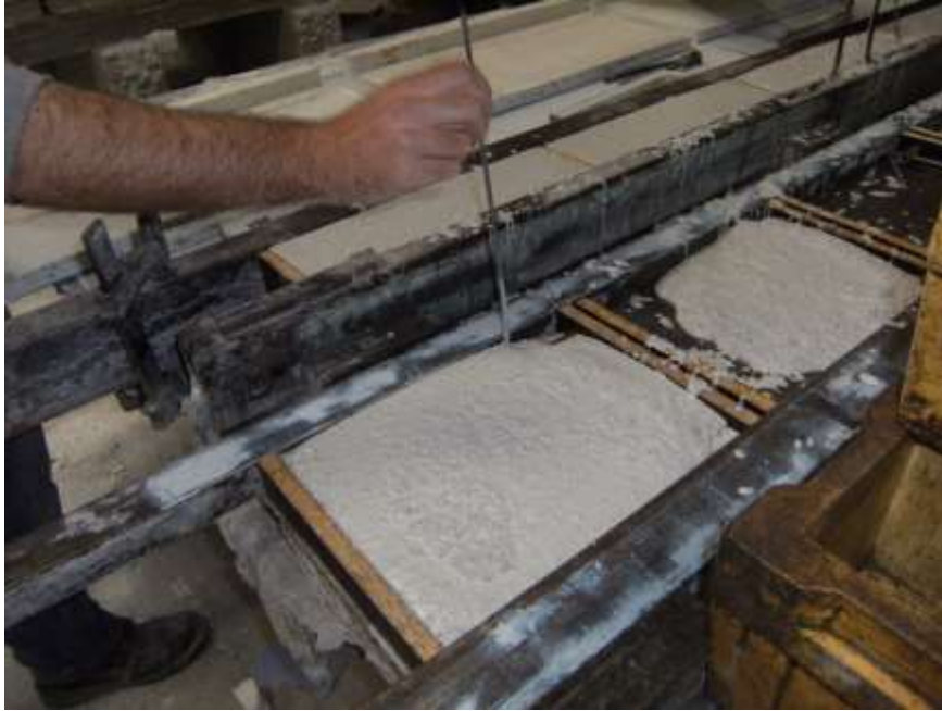
Figura 4.4.2s – Homogeneïtzació del formigó (vista 1)
