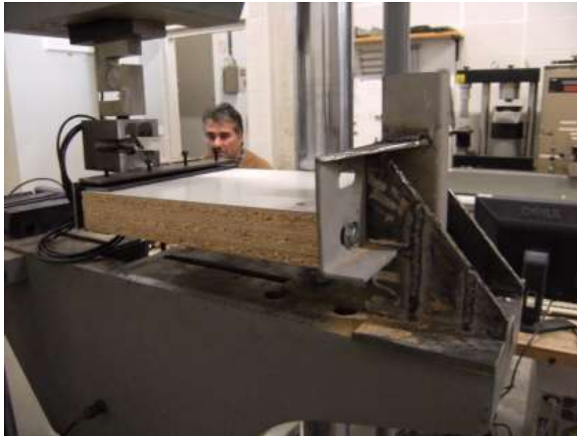
Figura 5.5.3f – Fixació de la peça de fusta i la peça de suport (vista 3)
