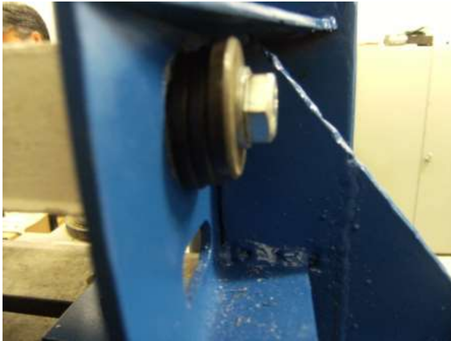
Figura 5.10.5.1b – Triple volandera a la unió cargolada esquerra
