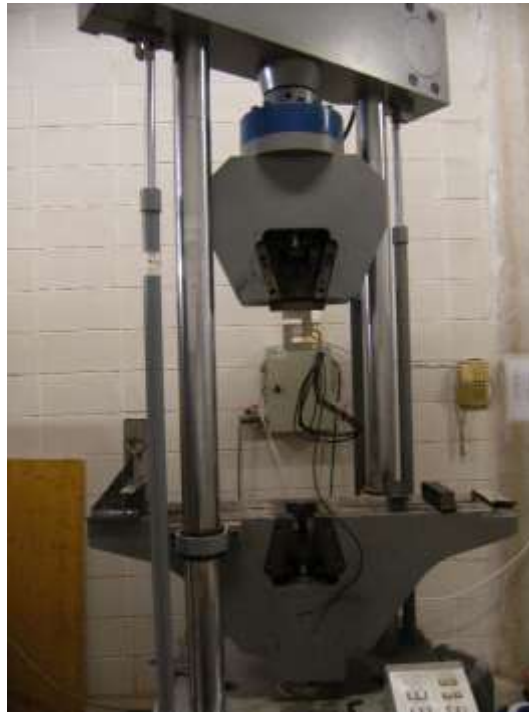
Figura 5.5.3a – Premsa universal d'assaigs; Servosis model MUE-60
