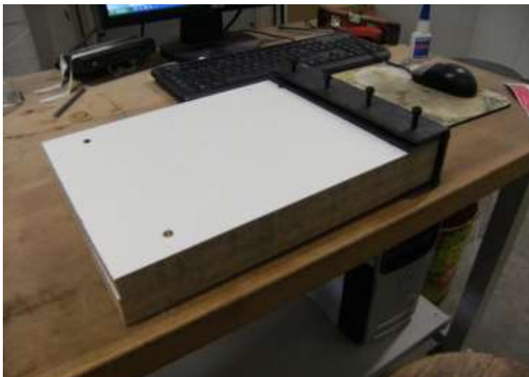
Figura 5.5.2b – Peça de fusta amb peça metàl·lica distribuïdora uniforme de la força (vista 2)
