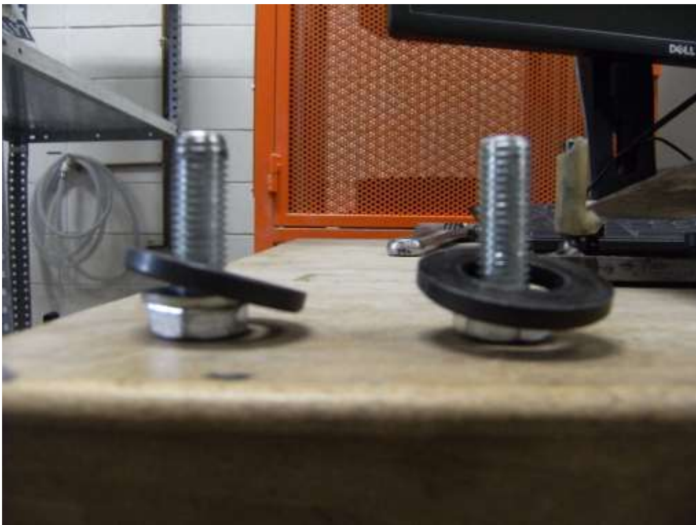
Figura 5.10.3.4e – Unions cargolades després de l'assaig
