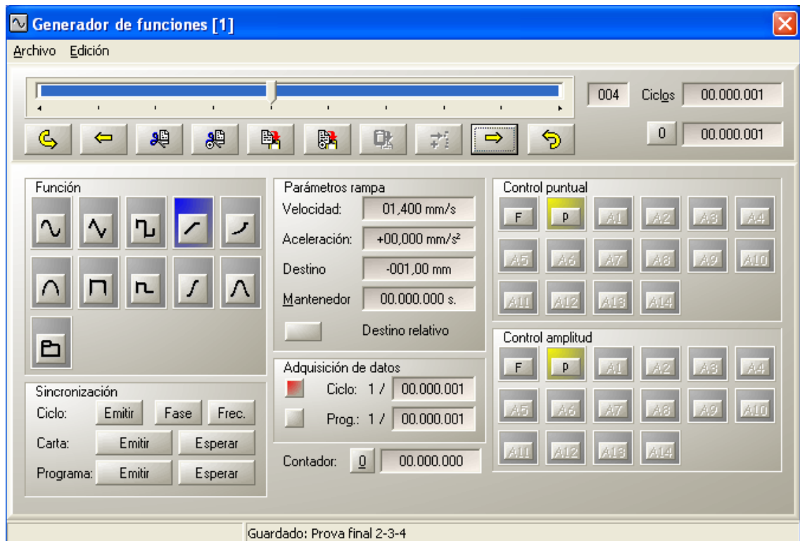
Figura 5.10.3.1e – Funció rampa de 0 mm a -1,00 mm
