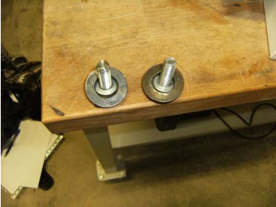
Figura 5.10.2.3b – Estat dels cargols d'unió després de l'assaig 1
