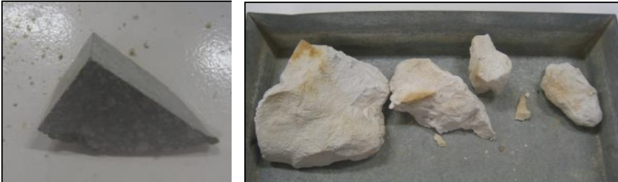
Imatge 24: Esquerra pedra de Girona, dreta pedres fornada 1 no calcinades.
