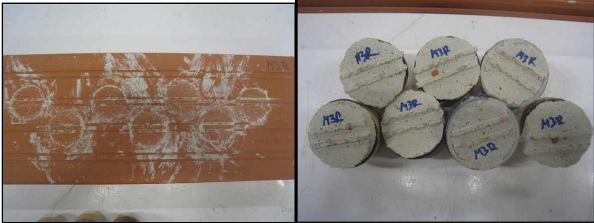
Forma de ruptura tipus A – provetes M3.R.
