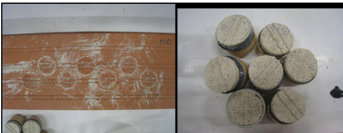
Forma de ruptura tipus A – provetes M10.
