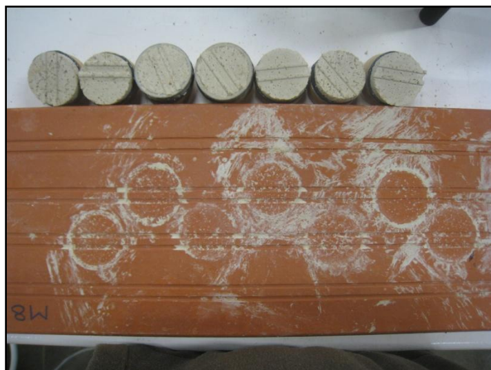
Forma de ruptura tipus A – provetes M8.
