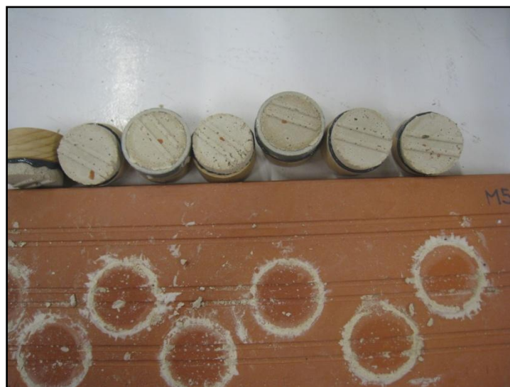
Forma de ruptura tipus A – provetes M5.
