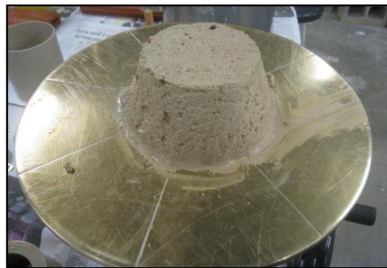
Imatge 38: Assaig per la determinació de la consistència. Abans dels cops.
