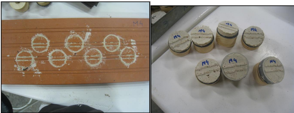
Forma de ruptura tipus A – provetes M4.
