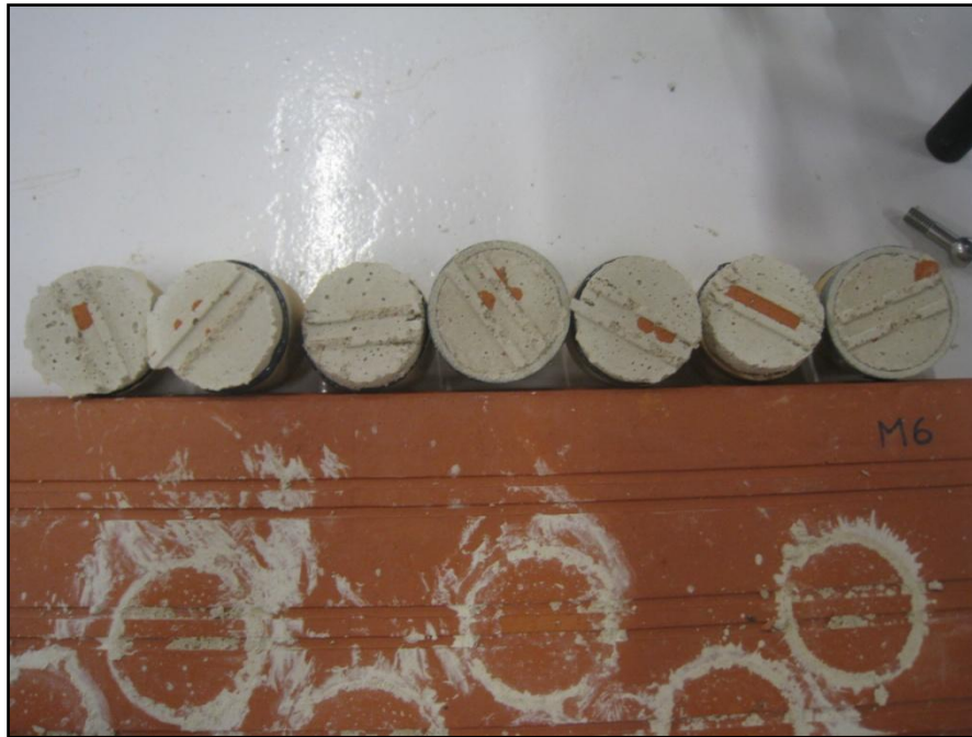
Forma de ruptura tipus A – provetes M6.
