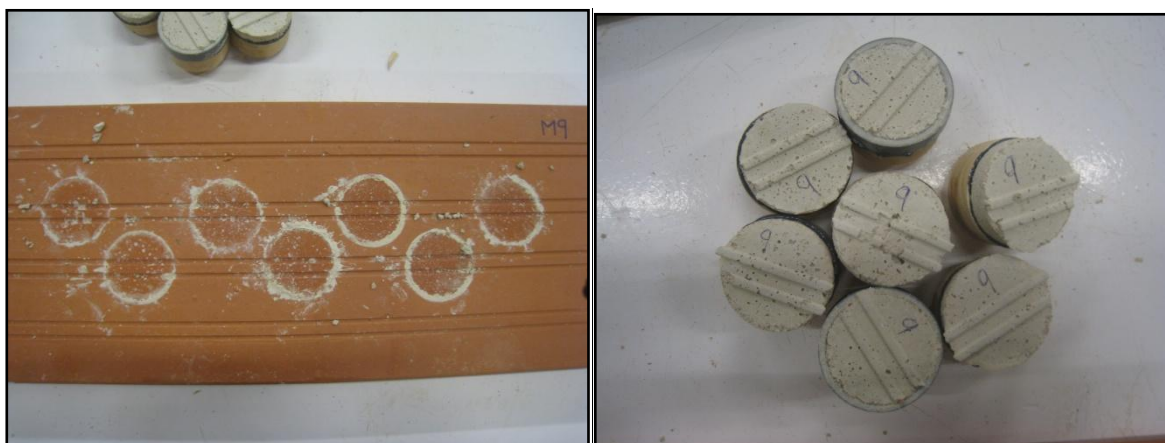
Forma de ruptura tipus A – provetes M9.
