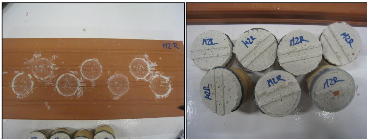
Forma de ruptura tipus A – provetes M2.R.
