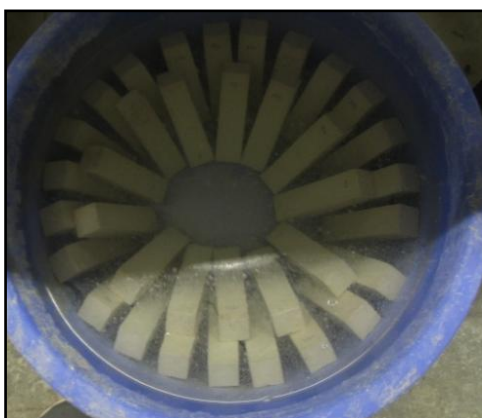
Imatge 47: Provetes submergides a l'aigua.
