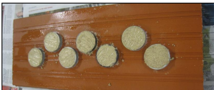
Imatge 43: Provetes acabades d'efectuar sobre suport en l'assaig de la resistència a l'adherència.
