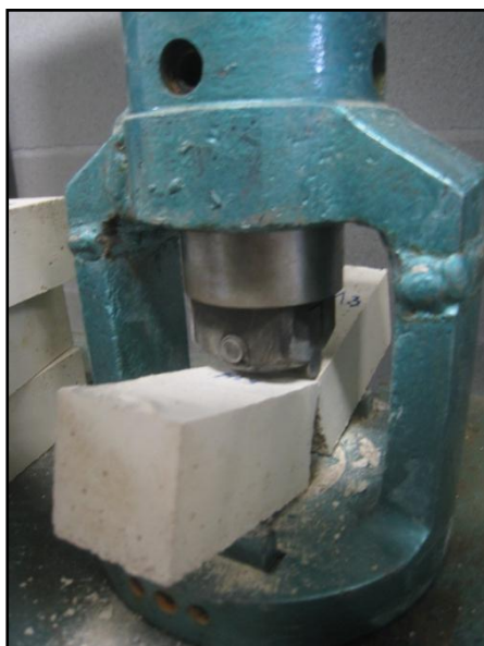
Imatge 46: Trencament en l'assaig per a la determinació a la resistència a flexió.
