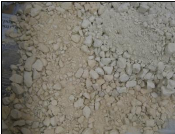
Imatge 21: Procés d'apagada de la calç. Trituració de les pedres.
