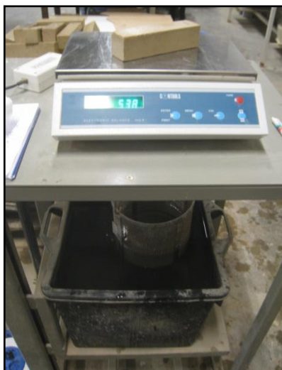
Imatge 48: Balança, prevista per poder pesar elements submergits sota l'aigua.
