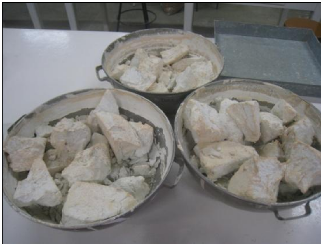
Imatge 18: Aparença de la calç un cop apagada i seca.
