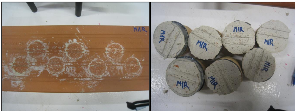
Forma de ruptura tipus A – provetes M1.R.
