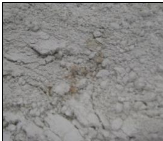
Imatge 23: Procés d'apagada de la calç. El color marró i gris és la trituració d'un dels còdols.
