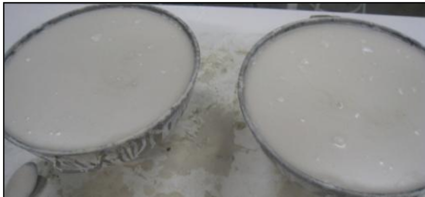
Imatge 19: Procés d'apagada de la calç. Moment on es deixa la calç apagada amb aigua que reposi.
