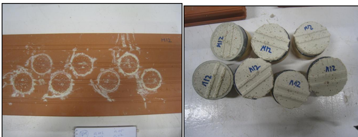
Forma de ruptura tipus A – provetes M12.
