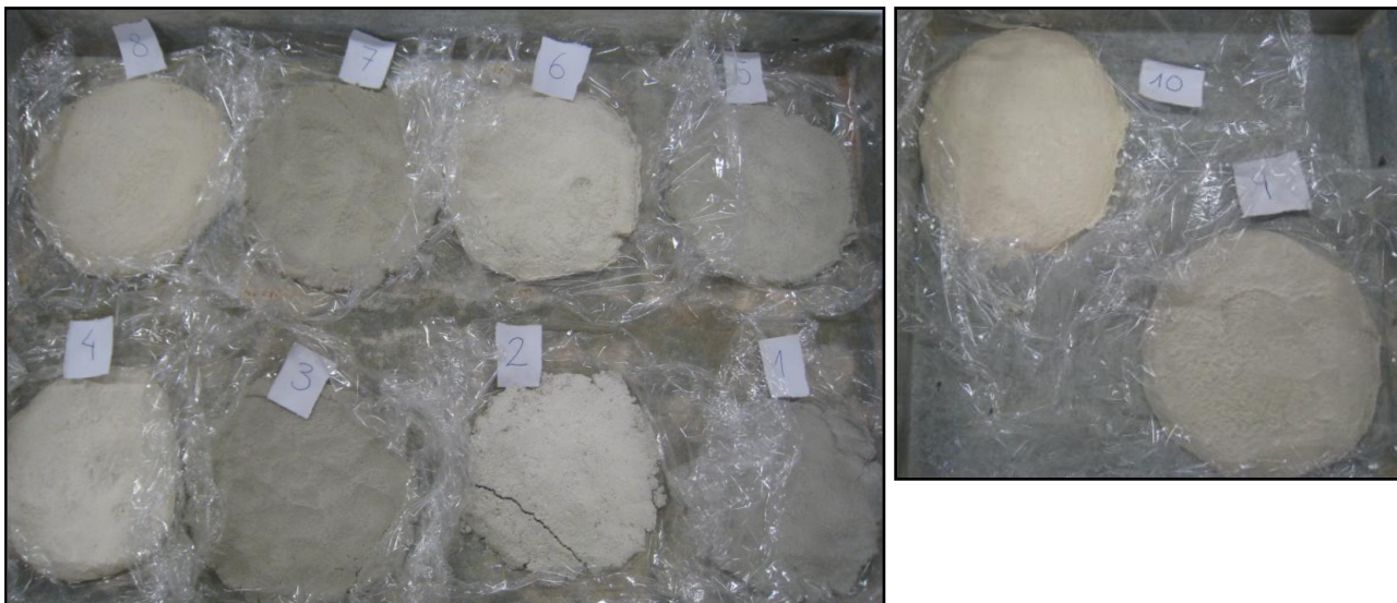
Imatge 34: Resultats del mostreig de color al cap de 30 dies.
