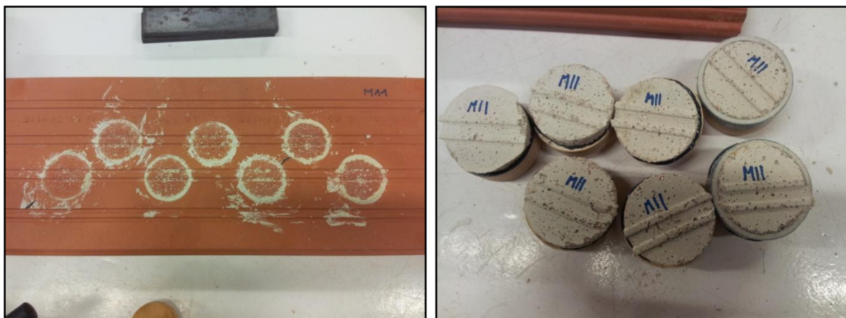
Forma de ruptura tipus A – provetes M11.
