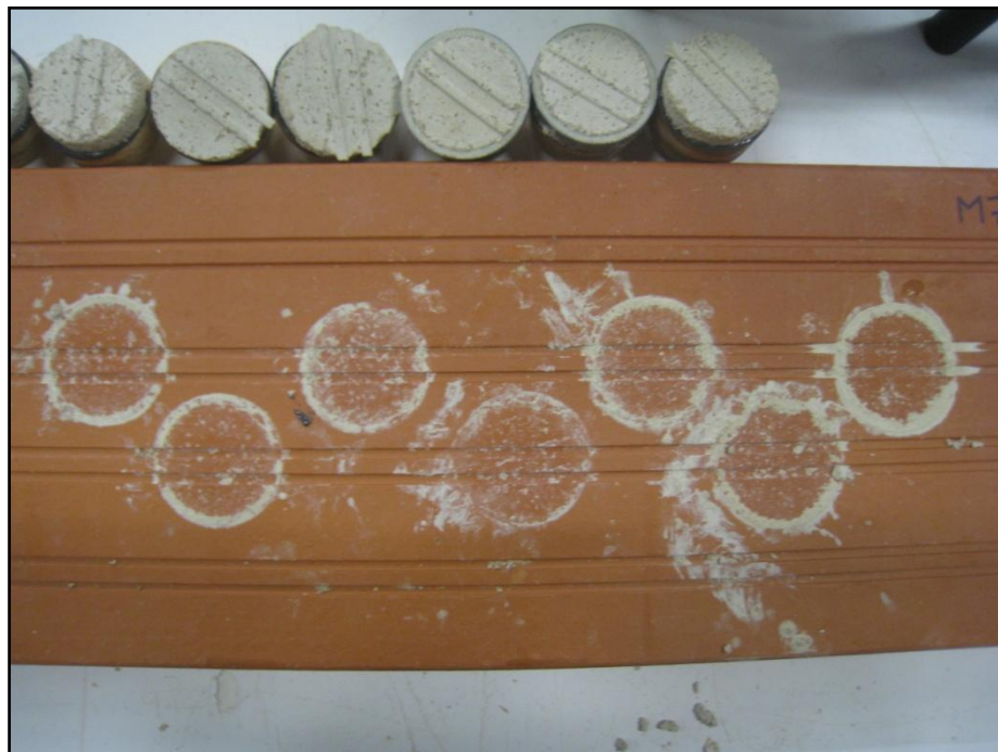
Forma de ruptura tipus A – provetes M7.
