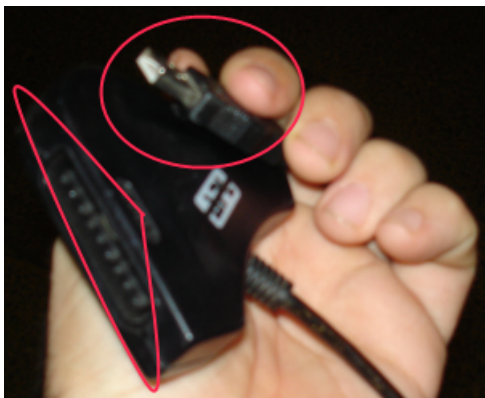
Figura 2.4: Conversor on es senyala la sortida USB, i una de les dues entrades
