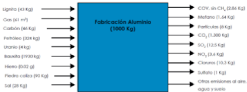
Figura 2.3: Análisis de inventario para la fabricación de un Kg de aluminio. Fuente: Comunidad de Madrid.
