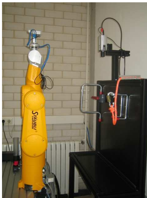
Figura 1. Entorn de treball amb el braç manipulador Stäubli i la càmera de vídeo
