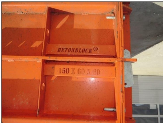
FIG. 64: Detall d'un motlle de tipus estàndard de 150x60x60 cm patentat sota la marca de Betonblock.
