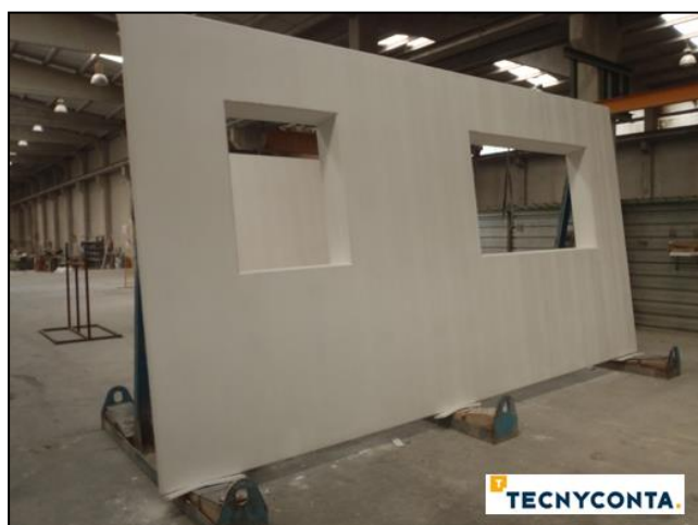
FIG.27 : Panell de formigó prefabricat tipus GRC, s'observa que el seu acabat és més llis i acurat.
