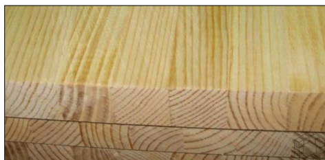
FIG.53: Detall de tauler de llistons, on sobretot en el lateral es pot observar els diferents llistons, cadascun d'ells amb un sentit de les fibres diferent. Font: Crearlab
