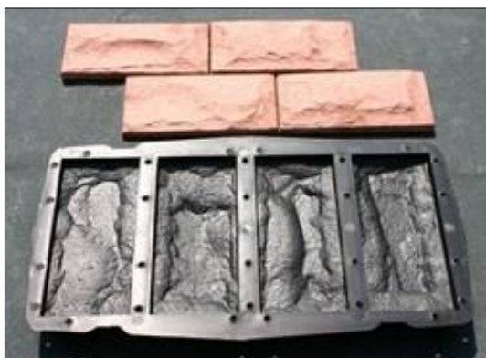
FIG. 6: Fotografia on es poden veure quatre pedres artificials de color ataronjat, i el seu respectiu motlle de fabricació.
