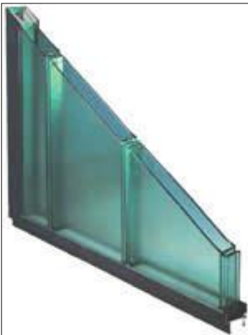
FIG.76: Detall de secció de tancament amb U-Glas amb bastidor perimetral d'alumini.
