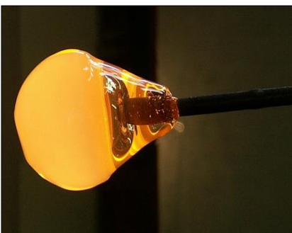
FIG. 128: Imatge del vidre en estat semi sòlid, el que li permet ser treballat i donar la forma desitjada.
