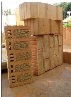
FIG. 31: Bloc ceràmic amb aïllament de llana mineral. Font: Fotografia pròpia
