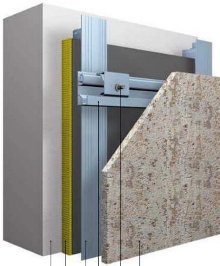
FIG.57: Detall constructiu de façana ventilada formada per guies metàl·liques fixades sobre la paret de suport, aïllament tèrmic i una cambra d'aire ventilada entre l'aïllament i el revestiment de pedra natural.
