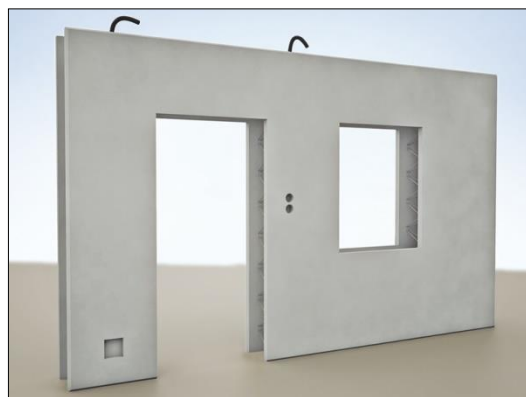
FIG.25 : Panell de formigó prefabricat de doble paret, com s'observa ja duu incorporat l'obertura de la porta i finestra, així com el pas de les instal·lacions.
