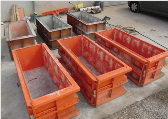
FIG. 63: Imatge de diferents motlles metàl·lics per a la fabricació del bloc de formigó amb el sistema "Lego".
