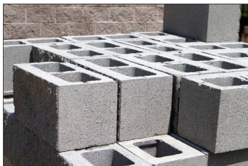
FIG. 54: Blocs de formigó amb dos forats per a l'armat i tancats lateralment.
