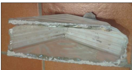
FIG.83: Detall d'una peça de pavès quadrada tallada diagonalment on s'observa el seu interior.
