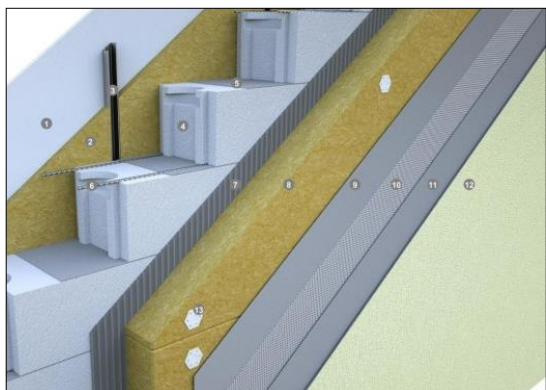
FIG. 87: Detall constructiu d'un possible tipus de façana construïda amb Porenbeton.
