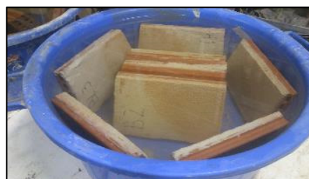
Imatge 54 Provetes saturades d'aigua amb sal Font: Pròpia
