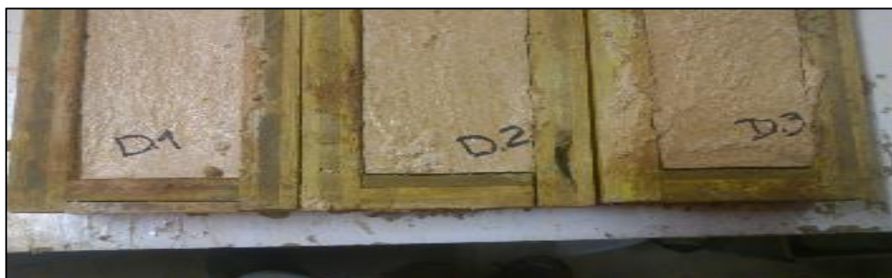
Imatge 52 Mostra de la retracció de 3 provetes Font: Pròpia
