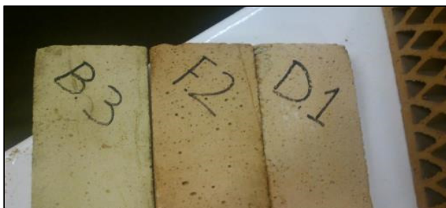
Imatge 31 Provetes de retracció després de ser extretes del motlle Font: Prònia
