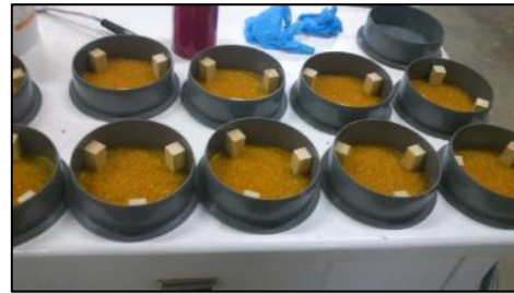
Imatge 44 Fabricació de provetes circulars 2 Font: Prònia
