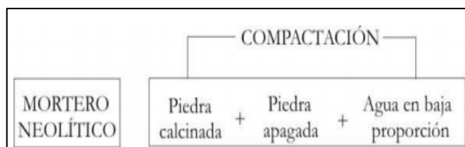
Figura 1 Fabricació del morter en Època Neolítica Font: Tesi doctoral Xavier Mas i Barberà
