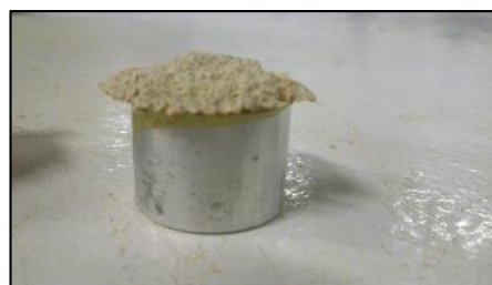
Imatge 62 Mostra individual després de ser arrencada Font: Pròbia
