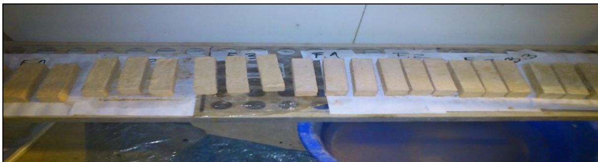
Imatge 27 Provetes prismàtiques reposant fregant a la càmera Font: Pròpia
