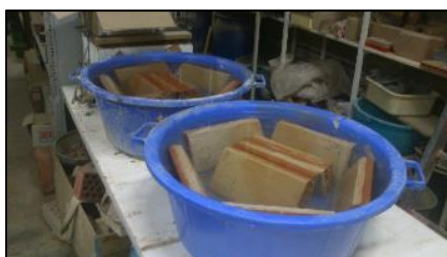
Imatge 53 Provetes saturades d'aigua Font: Pròpia
