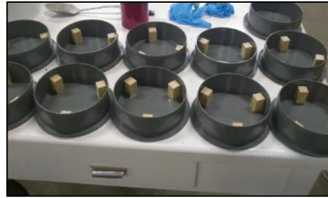
Imatge 42 Fabricació de provetes circulars Font: Prònia
