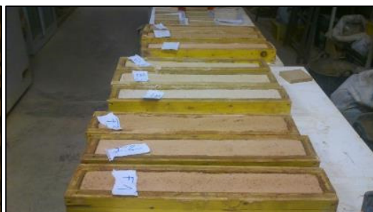
Imatge 32 Conjunt de provetes reposant els 7 dies Font: Prònia
