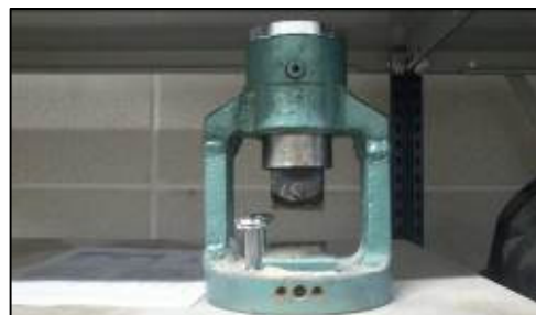
Imatge 47 Peça per trencar a flexió Font: Prònia
