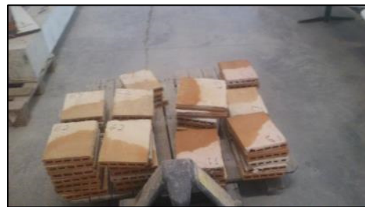
Imatge 36 Provetes assecant-se Font: Pròpia
