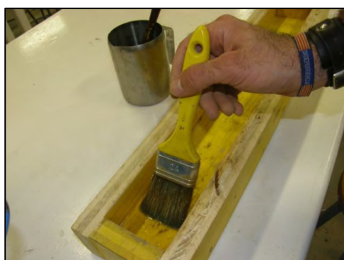
Imatge 29 Motlle de retracció aplicant oli desengreixant Font: Manso
