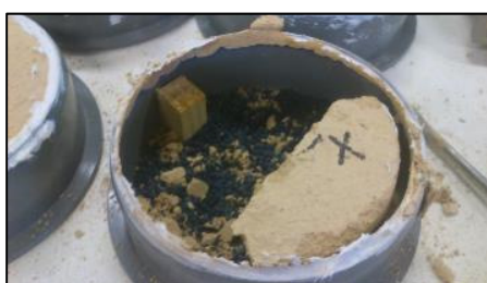
Imatge 65 Proveta després del assaig per reutilitzar per un altre assaig Font: Pròpia
