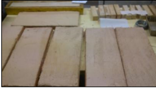
Imatge 33 Arrebossats aplicats en encadellats Font: Pròpia
