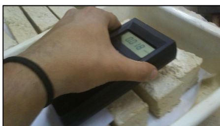
Imatge 49 Mesura d'una proveta a radioactivitat Font: Pròpia
