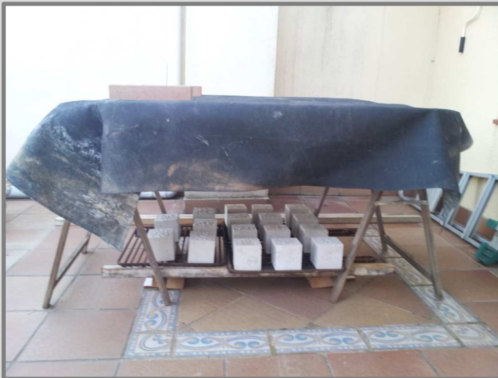
Imatge 47: Recinte d'assaig de la velocitat de penetració de la carbonatació. Autor: Guillem Martí / Font: Pròpia
