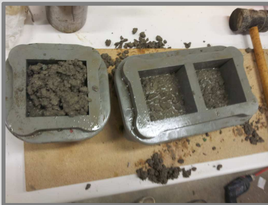
Imatge 18: Colpejat del motlle amb maça i enrasat de la cara superior. Autor: Guillem Martí / Font: Pròpia
