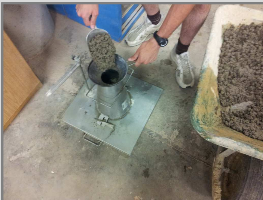
Imatge 76: Emplenat del con d'Abrams. Autor: Guillem Martí / Font: Pròpia
