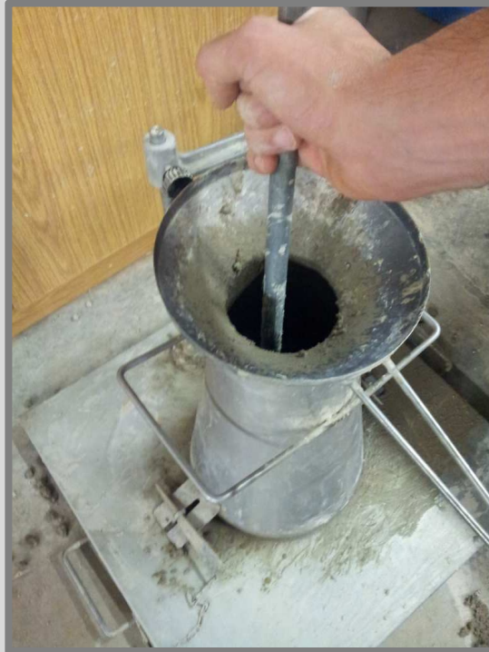
Imatge 77: Compactat del formigó mitjançant barra compactadora. Autor: Guillem Martí / Font: Pròpia
