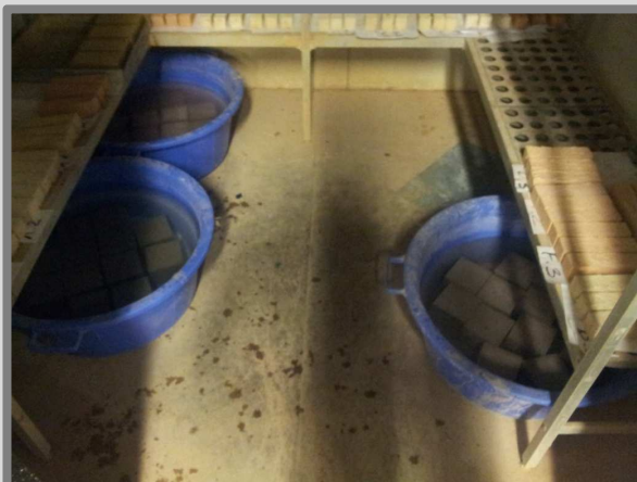
Imatge 24: Conservació provetes submergides en aigua entre 48-120 hores. Autor: Guillem Martí / Font: Pròpia
