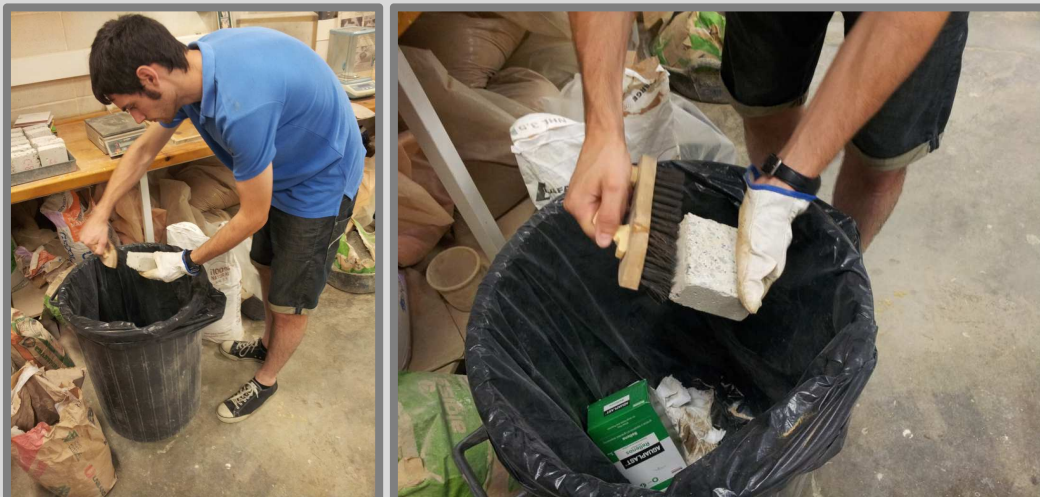
Imatge 61: Raspallat de les mostres per extreure'n el material després. Autor: Guillem Martí / Font: Pròpia
