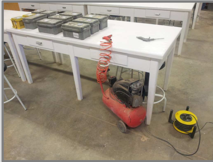
Imatge 21: Equip d'aire a pressió i pistola de desemmotllat. Autor: Guillem Martí / Font: Pròpia
