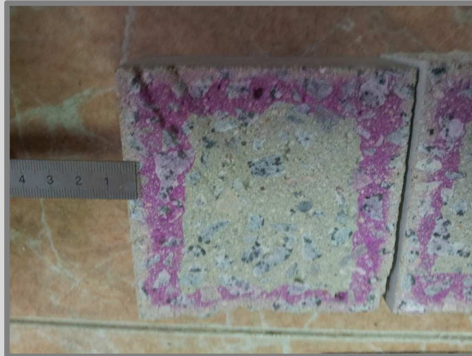
Imatge 51: Mesura de la penetració de la carbonatació sobre una de les mostres on s'ha aplicat el reactiu.
