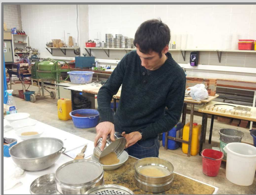
Separació de tamisos per determinar la fracció retinguda a cadascun d'ells. Autor: Guillem Martí / Font: Pròpia
