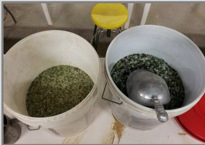
Imatge 13: Vidre de mida inferior a 4 mm (esquerra). Vidre de mida entre 4 i 8 mm (dreta). Autor: Guillem Martí / Font: Pròpia
