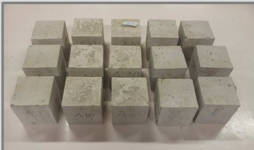
Imatge 32: Provetes en condicions de recepció després de conservació en cambra humida. Autor: Guillem Martí / Font: Pròpia
