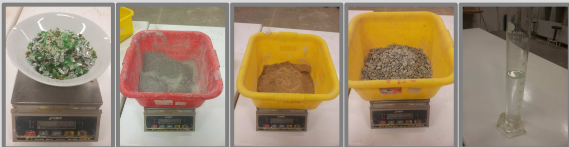
Imatge 14: Pesada dels diferents components del formigó. Autor: Guillem Martí / Font: Pròpia
