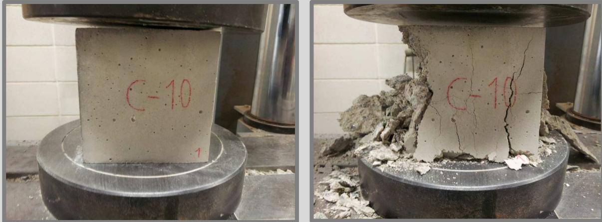
Imatge 29: Col·locació de la proveta en la màquina d'assaig i mostra trencada després de l'assaig. Autor: Guillem Martí / Font: Pròpia
