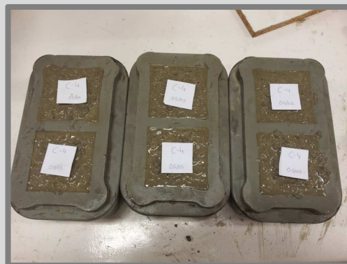
Imatge 19: Formigó després de la fase d'emmotllat, correctament identificat. Autor: Guillem Martí / Font: Pròpia
