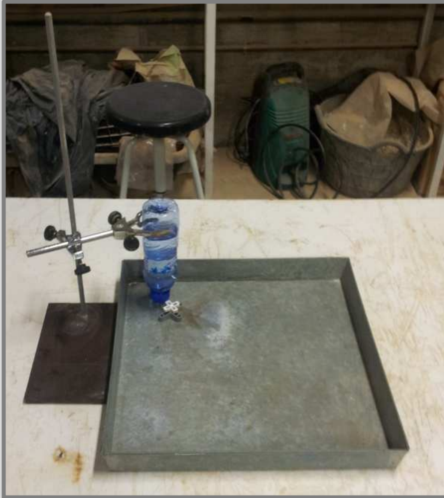
Imatge 41: Preparació de l'assaig de capil·laritat. Autor: Guillem Martí / Font: Pròpia
