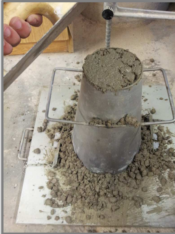
Imatge 79: Enrasat de la part superior del con d'assaig. Autor: Guillem Martí / Font: Pròpia
