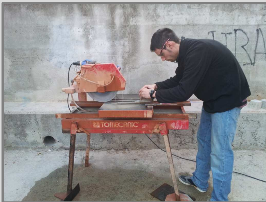
Imatge 54: Col·locació de la proveta núm. 5 per a l'assaig d'abradió i durabilitat a la màquina de tall. Autor: Guillem Martí / Font: Pròpia
