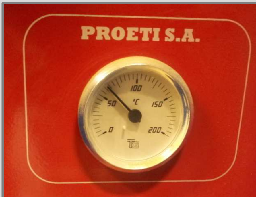
Imatge 35: Termòstat de l'estufa de laboratori configurat a temperatura entre 60 i 65°C. Autor: Guillem Martí / Font: Pròpia
