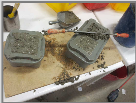
Imatge 18: Colpejat del motlle amb maça i enrasat de la cara superior. Autor: Guillem Martí / Font: Pròpia
