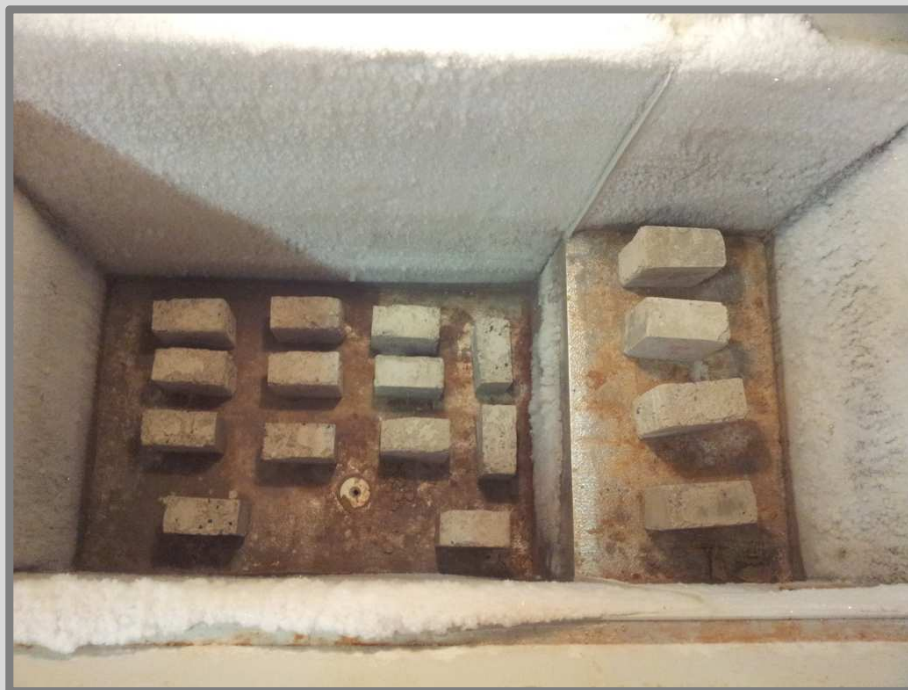
Imatge 59: Provetes dins el congelador. Autor: Guillem Martí / Font: Pròpia
