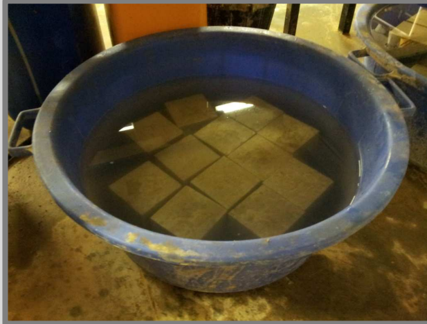
Imatge 36: Saturació de les provetes submergides en aigua. Autor: Guillem Martí / Font: Pròpia
