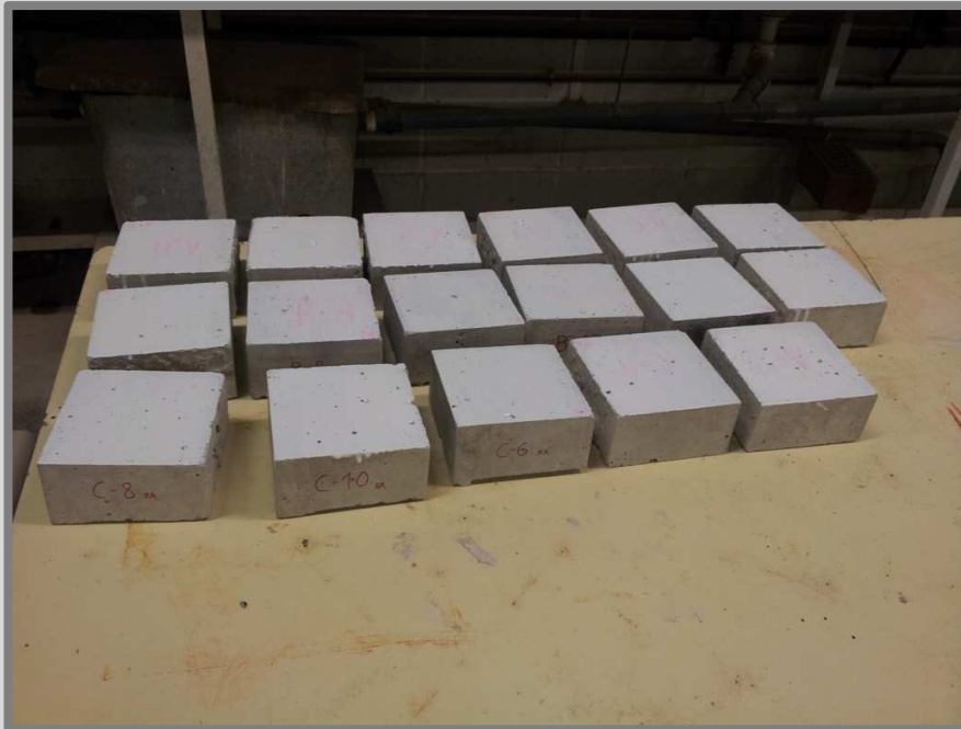
Imatge 70: Provetes de formigó abans de l'assaig, ja pintades. Autor: Guillem Martí / Font: Pròpia
