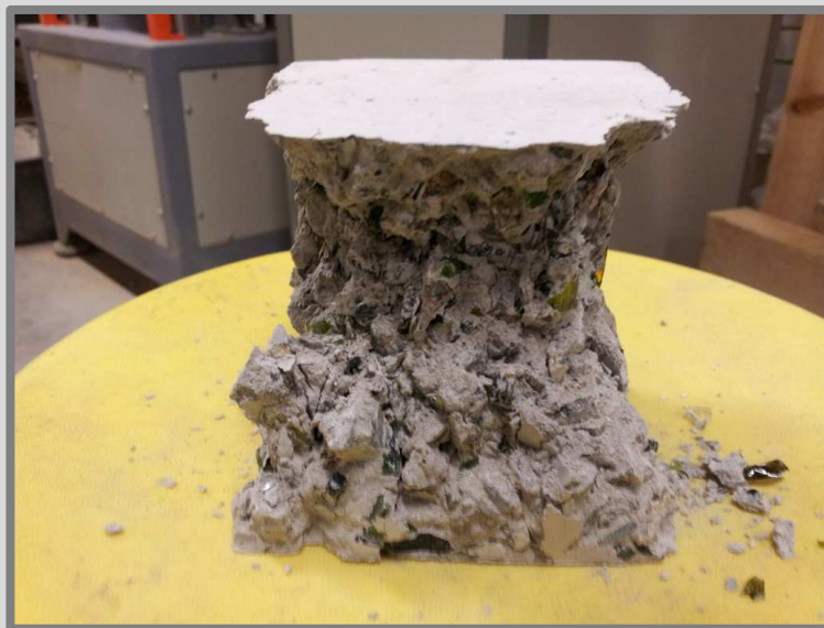
Imatge 30: Anàlisi del tipus de ruptura. Ruptura satisfactòria. Autor: Guillem Martí / Font: Pròpia
