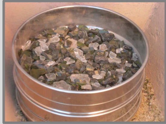
Imatge 12: Procés de tamisat del vidre. Autor: Guillem Martí / Font: Pròpia
