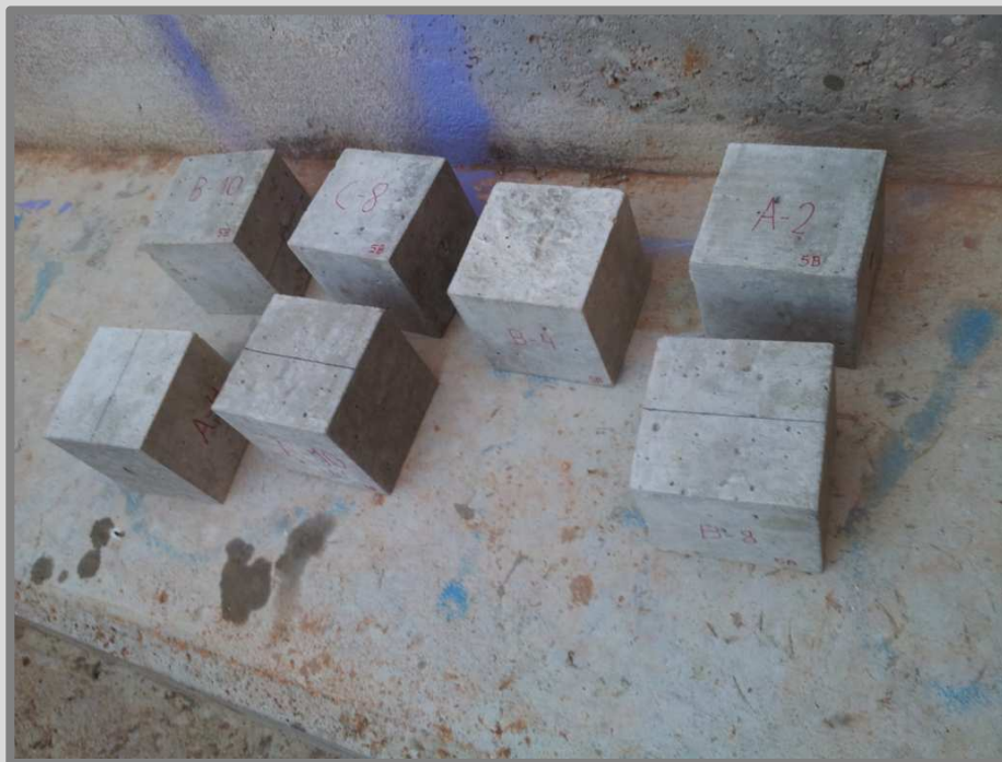
Imatge 53: Marcat de les provetes previ al tall. Autor: Guillem Martí / Font: Pròpia
