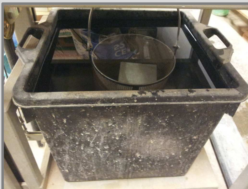
Imatge 39: Determinació pes m_4 mitjançant balança hidrostàtica. Autor: Guillem Martí / Font: Pròpia
