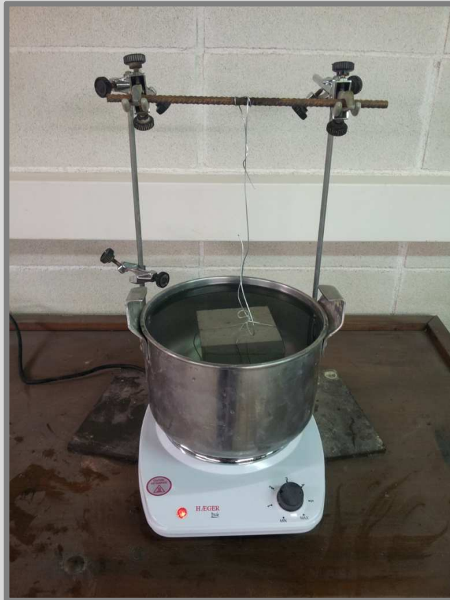
Imatge 37: Ebullició de les mostres de formigó mitjançant placa tèrmica. Autor: Guillem Martí / Font: Pròpia
