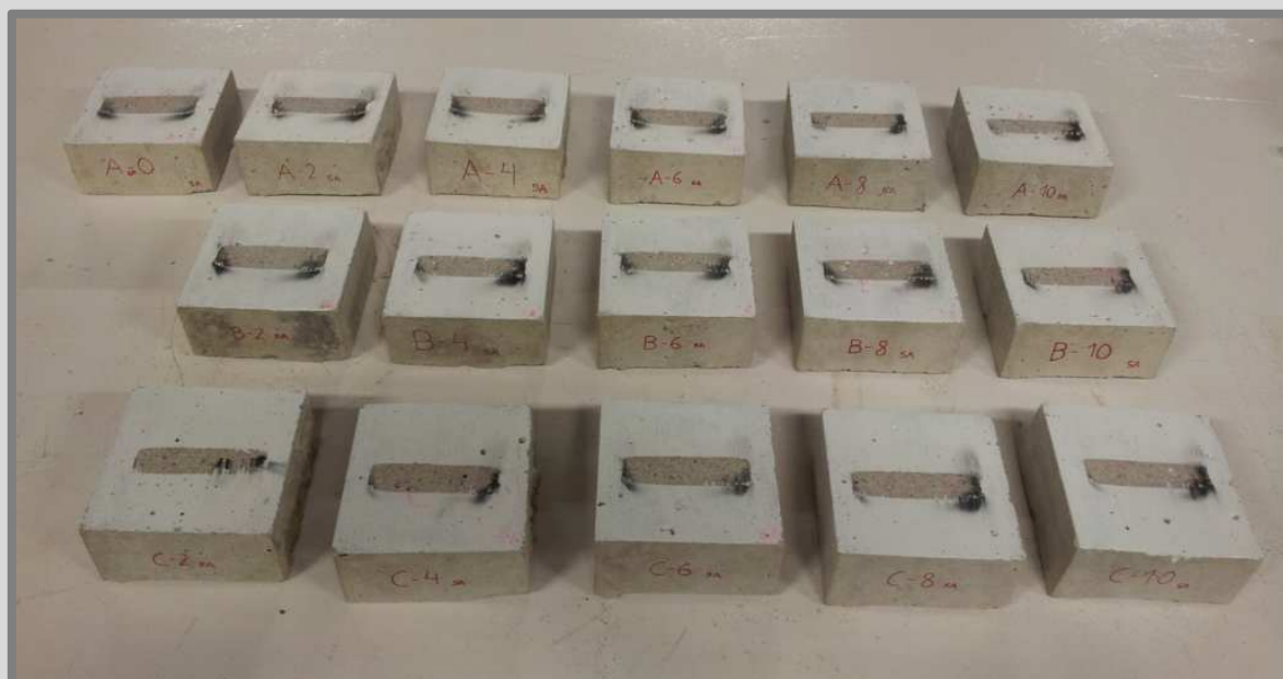
Imatge 73: Provetes un cop finalitzat l'assaig d'abradió. Autor: Guillem Martí / Font: Pròpia
