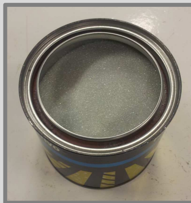
Imatge 5: Pigment reflexiu en forma de pols de vidre de l'empresa Productos Químicos FM 2005, S.L. Autor: Guillem Martí / Font: Pròpia
