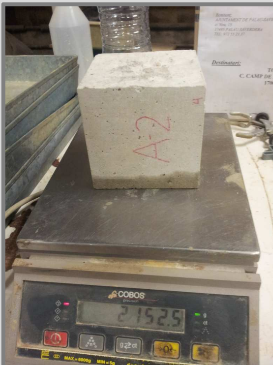
Imatge 44: Registre d'increment de pes de l'assaig de capil·laritat. És pot observar l'augment de l'absorció d'aigua en les cares de la proveta. Autor: Guillem Martí / Font: Pròpia
