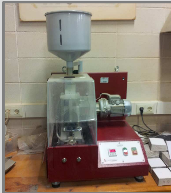
Imatge 64: Aparell d'abrasió. Autor: Guillem Martí / Font: Pròpia
