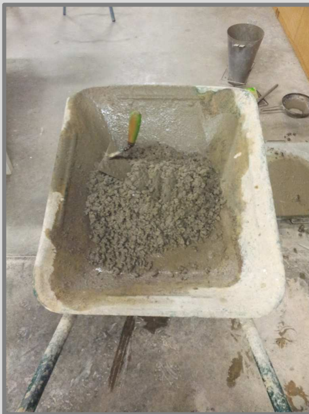
Imatge 75: Formigó elaborat amb formigonera previ a l'assaig de consistència. Autor: Guillem Martí / Font: Pròpia
