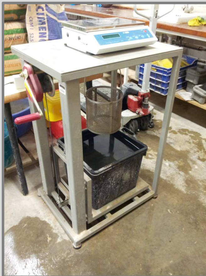
Imatge 38: Balança hidrostàtica equipada amb cistella. Autor: Guillem Martí / Font: Pròpia
