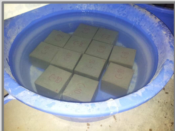
Imatge 24: Conservació provetes submergides en aigua entre 48-120 hores. Autor: Guillem Martí / Font: Pròpia
