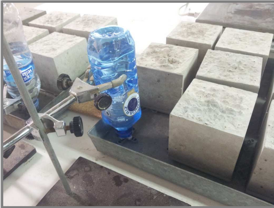
Imatge 43: Sistema de manteniment del nivell d'aigua durant l'assaig de capil·laritat. Autor: Guillem Martí / Font: Pròpia
