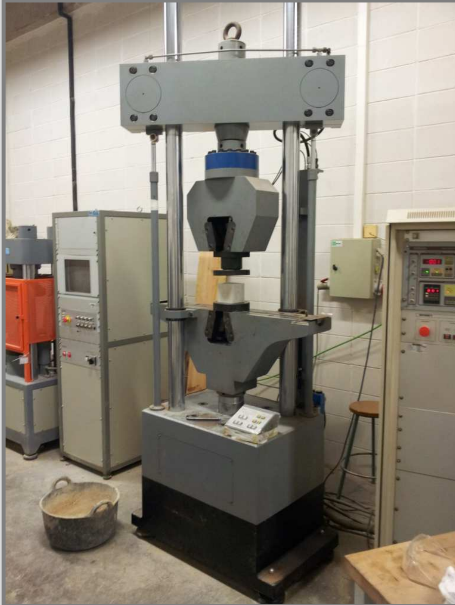
Imatge 26: Premsa universal de 60T. Autor: Guillem Martí / Font: Pròpia
