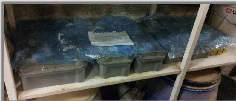
Imatge 20: Conservació del formigó 0-48 hores. Autor: Guillem Martí / Font: Pròpia
