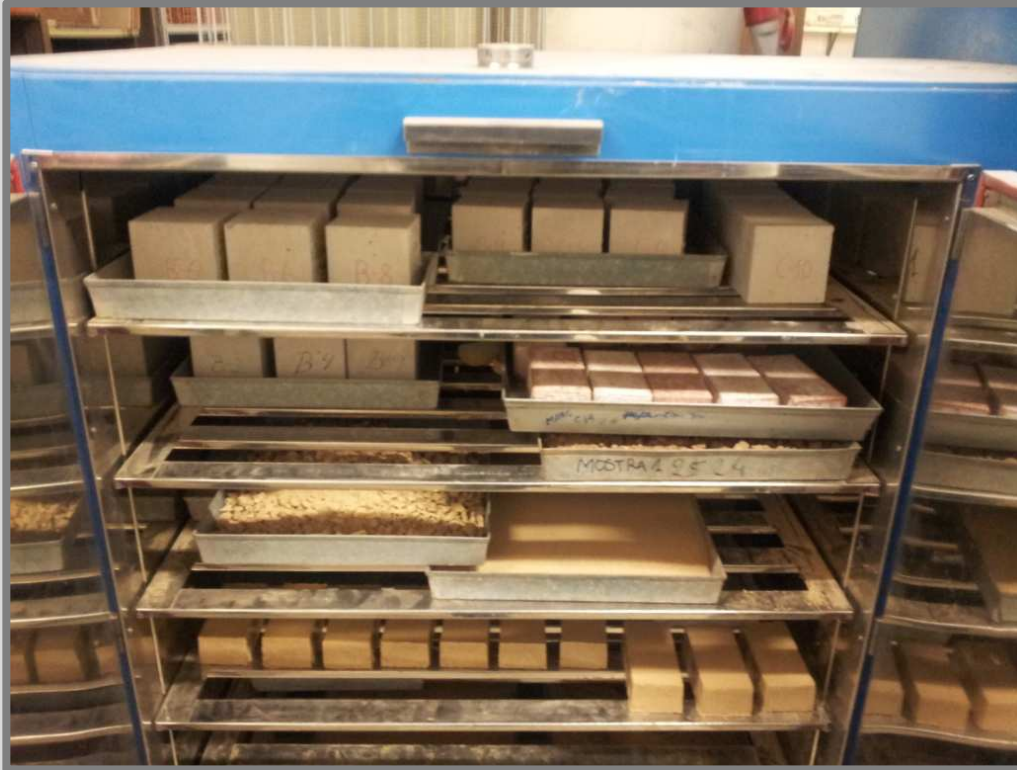
Imatge 34: Condicionament de les provetes a l'estufa de laboratori per tal de determinar el pes sec, m1. Autor: Guillem Martí / Font: Pròpia
