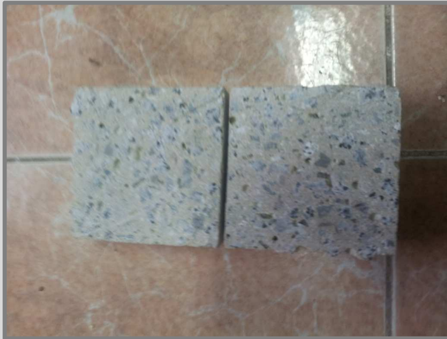
Imatge 49: Proveta després de ser tallada per la meitat. Autor: Guillem Martí / Font: Pròpia
