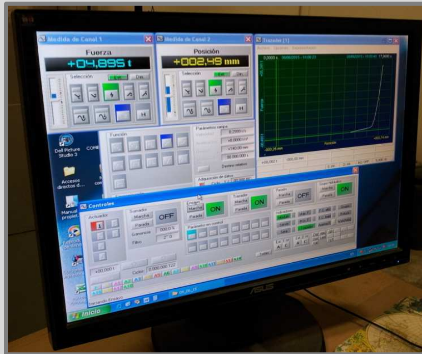
Imatge 31: Interfície de control del programa PCD2K. Font: Software PCD2K
