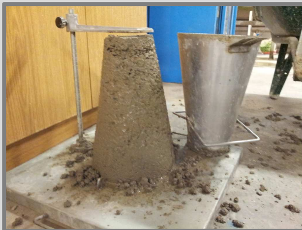
Imatge 80: Assentament produït en el formigó al retirar el con d'assaig. Autor: Guillem Martí / Font: Pròpia
