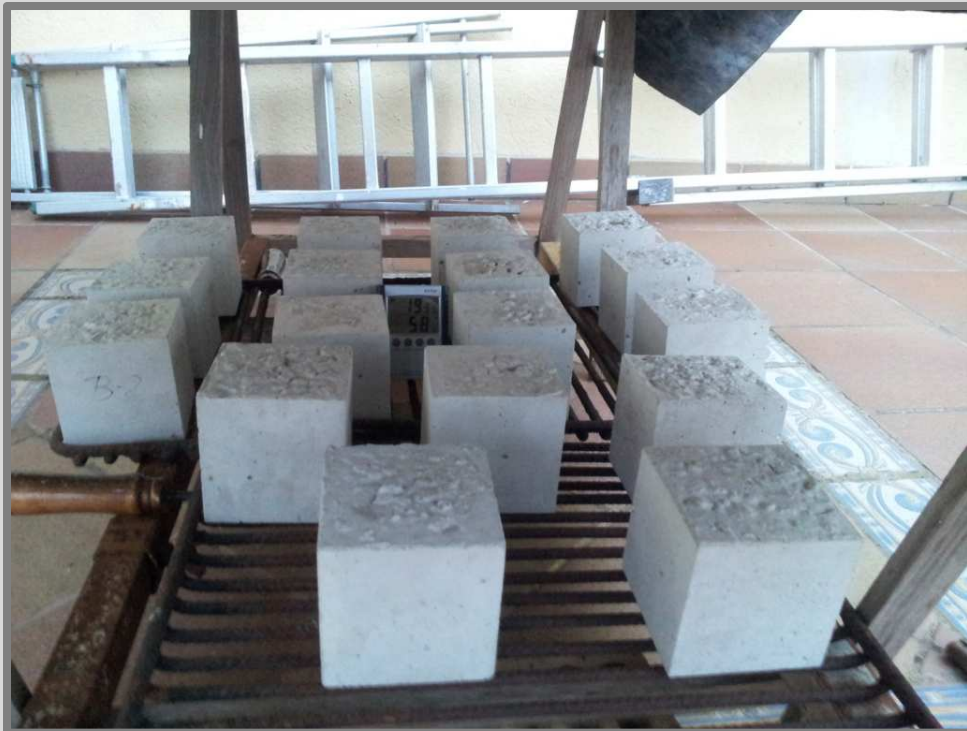
Imatge 48: Dispositiu de control de la temperatura i humitat en el recinte d'assaig. Autor: Guillem Martí / Font: Pròpia
