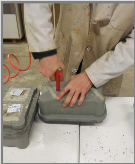
Imatge 22: Acoblament pistola al motlle i extracció de la proveta del motlle. Autor: Guillem Martí / Font: Pròpia
