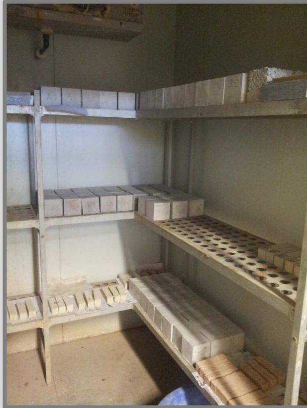
Imatge 25: Conservació de les provetes de formigó dins cambra humida. Autor: Guillem Martí / Font: Pròpia
