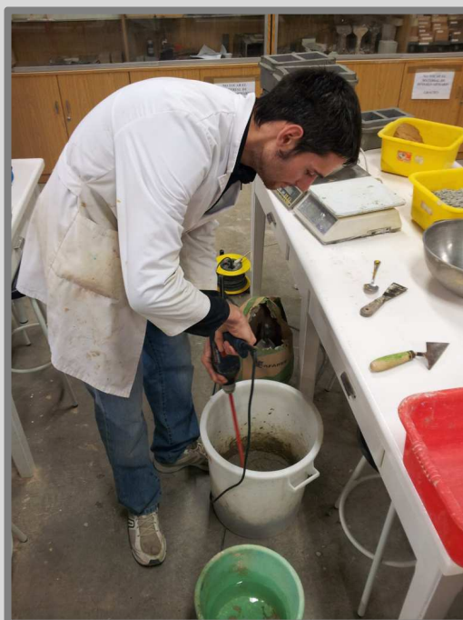
Imatge 16: Procés de barreja de l'assada del formigó mitjançant màquina per a morters. Autor: Guillem Martí / Font: Pròpia
