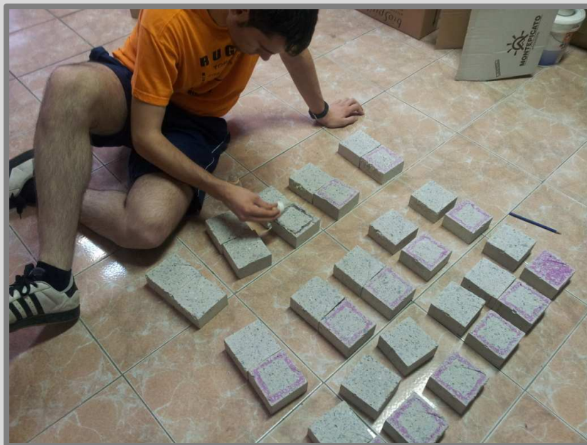
Imatge 50: Aplicació de la dissolució de fenolftaleïna. Autor: Guillem Martí / Font: Pròpia
