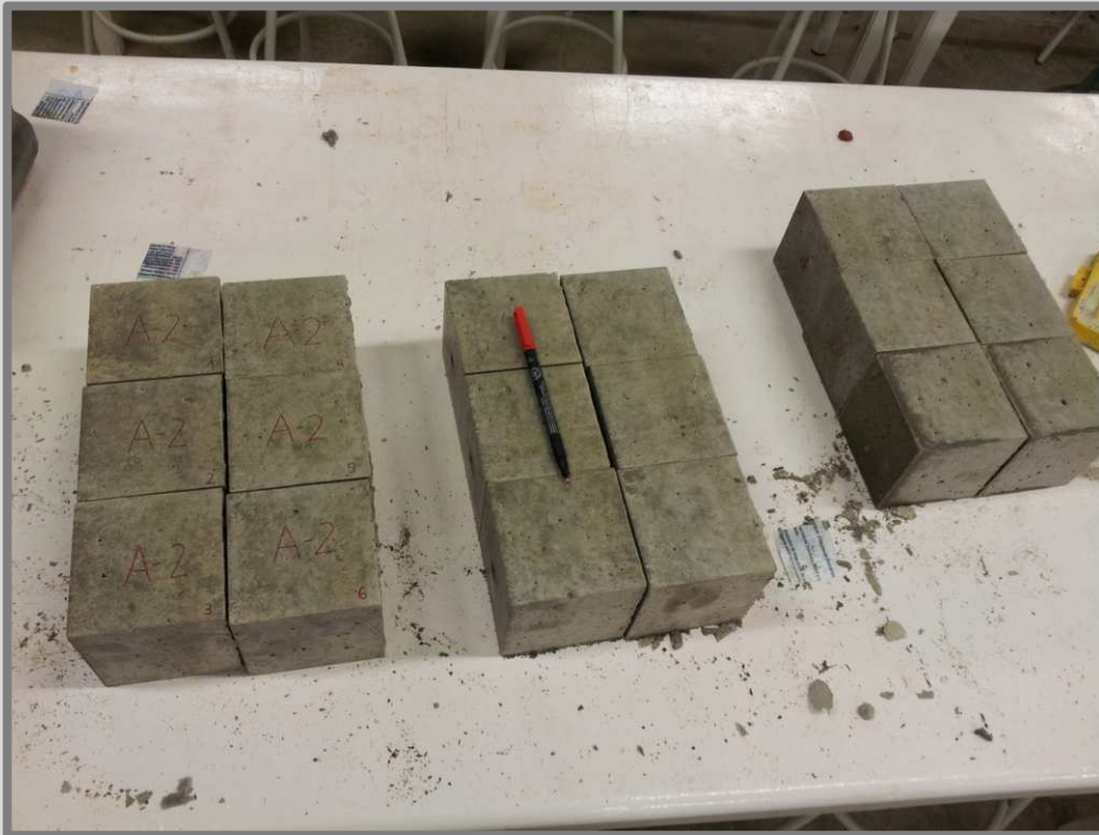
Imatge 23: Marcat amb retolador permanent de les provetes de formigó després del desemmotllat. Autor: Guillem Martí / Font: Pròpia
