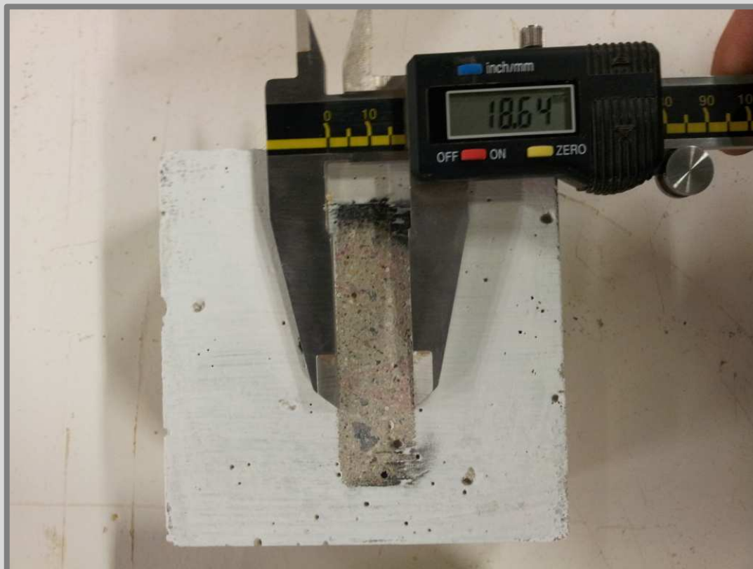
Imatge 72: Mesurament de l'amplada de l'empremta. Autor: Guillem Martí / Font: Pròpia
