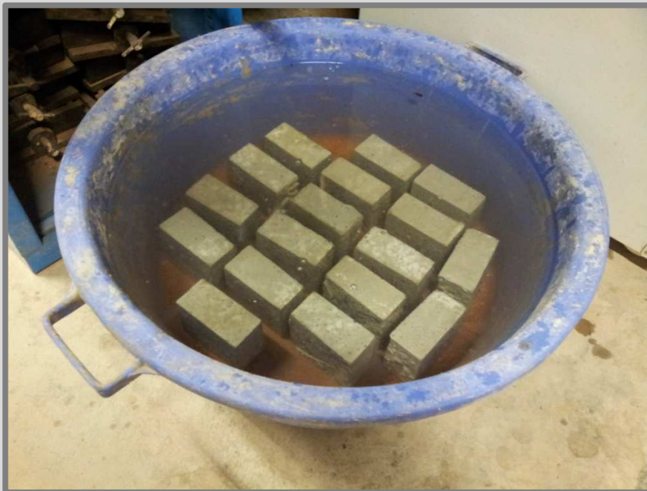
Imatge 57: Provetes submergides en aigua durant la humectació. Autor: Guillem Martí / Font: Pròpia
