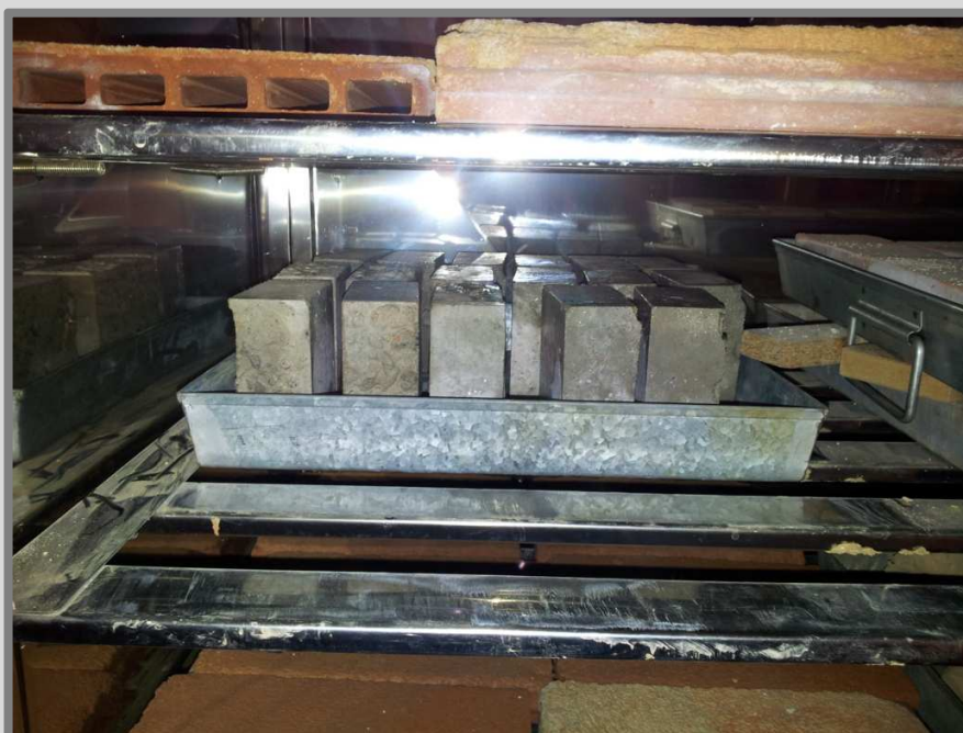
Imatge 60: Assecatge de les mostres en estufa a 60°C Autor: Guillem Martí / Font: Pròpia
