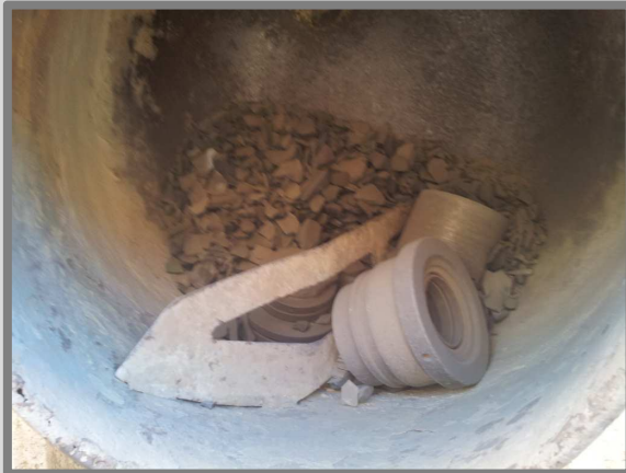
Imatge 11: Reducció de la mida del vidre. Autor: Guillem Martí / Font: Pròpia
