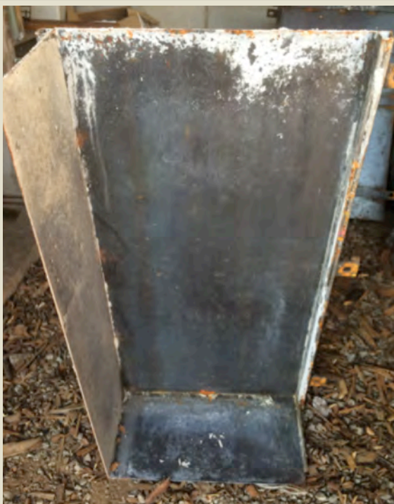
Imatge 2.2: Desencofrat motlle de planxa. Consistència fluida (+20l aigua) (MP2A3). Foto: Albert Coromina / Font: Pròpia
