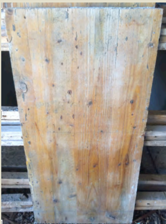
Imatge 2.10: Desencofrat motlle tauler de pi. Consistència fluida (+20l aigua) (MT2A3). Foto: Albert Coromina / Font: Pròpia
