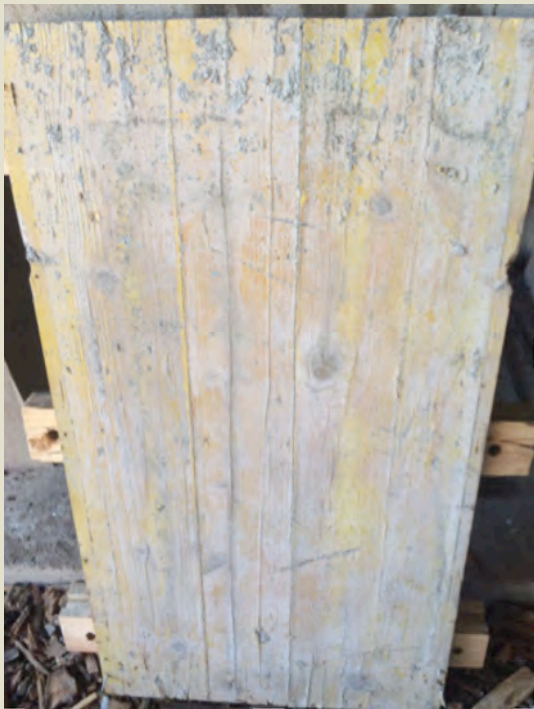
Imatge 2.14: Desencofrat motlle mixta. Lateral tauler de pi (MM1A3). Consistència tova. Foto: Albert Coromina / Font: Pròpia
