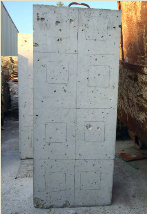
Imatge 1.5: Proveta MF1A2. Sense el. Intermitjos i Rn: 25mm. Foto: Albert Coromina / Font: Pròpia
