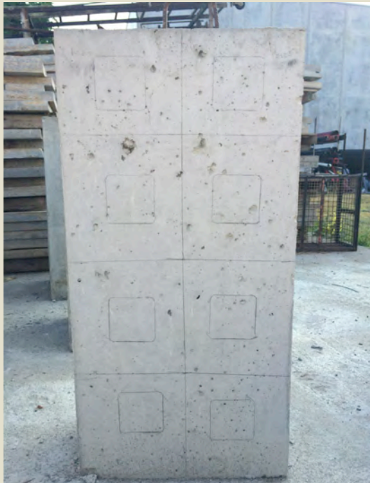
Imatge 1.3: Proveta MP2A2. Amb el. Intermitjos i Rn: 25mm. Foto: Albert Coromina / Font: Pròpia
