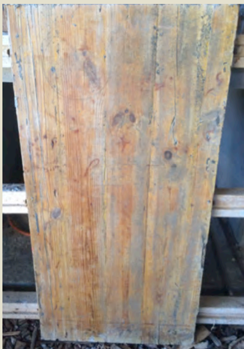
Imatge 2.9: Desencofrat motlle tauler de pi. Consistència fluida (+20l aigua). (MT2A3). Foto: Albert Coromina / Font: Pròpia
