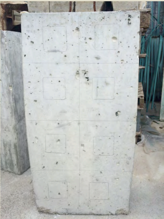
Imatge 1.8: Proveta MF2A2. Amb el. Intermitjos i Rn: 40 mm.
