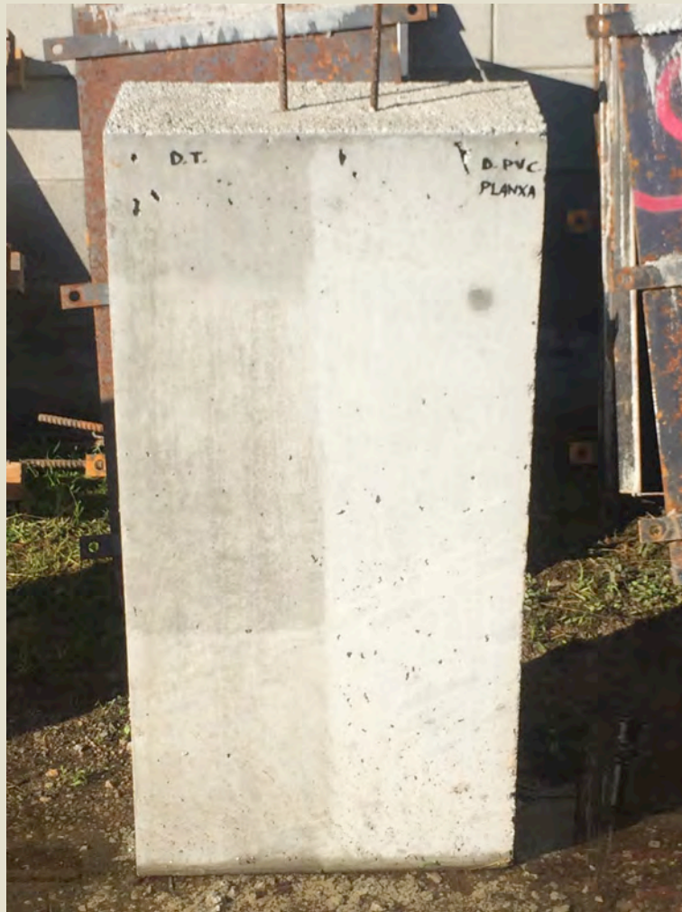
Imatge 1.3: Desencofrat motlle de planxa (MP1A3).
