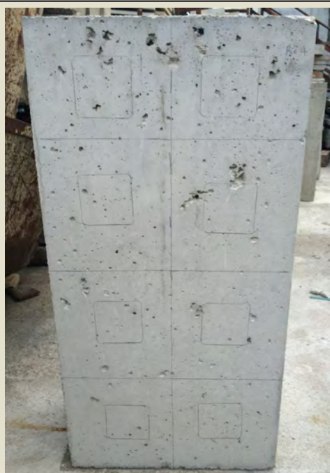
Imatge 1.2: Proveta MP1A2. Sense el. Intermitjos i Rn: 40 mm.
