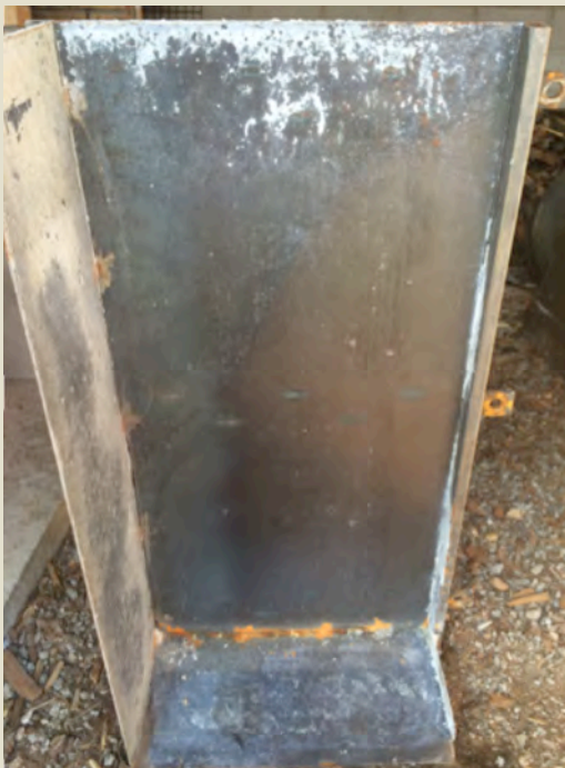
Imatge 1.2: Desencofrat motlle de planxa (MP1A3).
