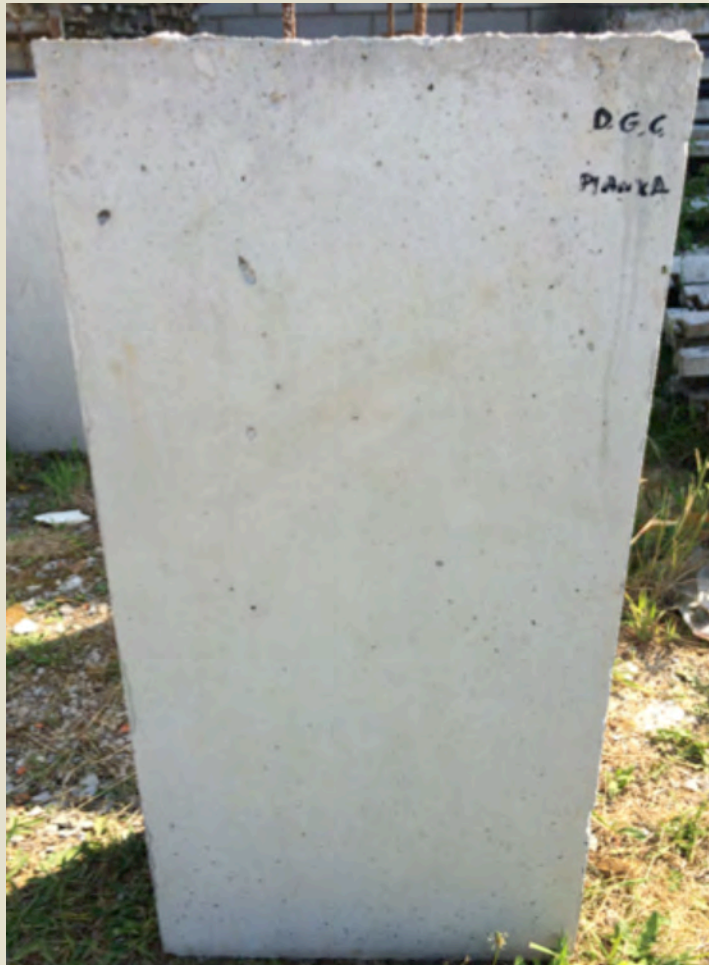
Imatge 2.4: Desencofrat motlle de planxa (MP2A3).
