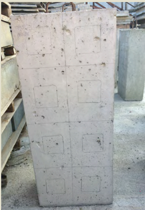
Imatge 1.6: Proveta MF1A2. Sense el. Intermitjos i Rn: 40mm. Foto: Albert Coromina / Font: Pròpia
