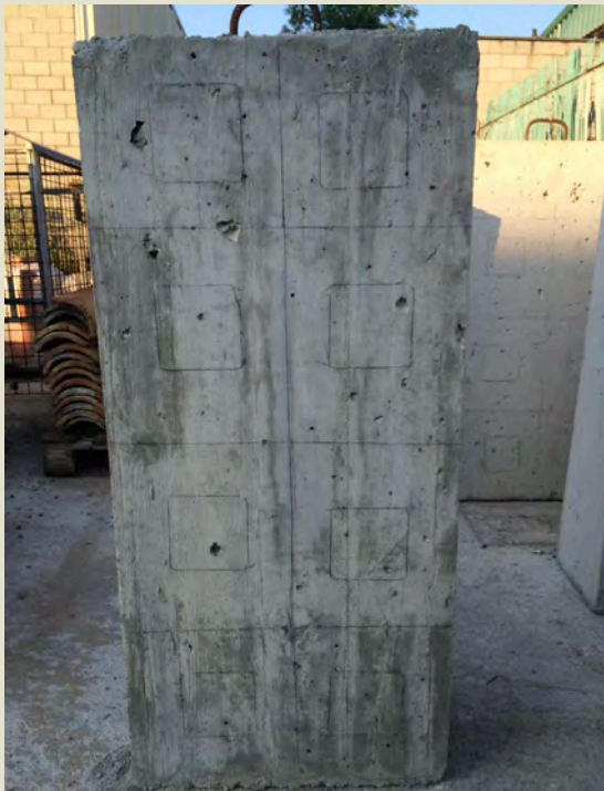
Imatge 1.12: Proveta MT2A2. Amb el. Intermitjos i Rn: 40 mm. Foto: Albert Coromina / Font: Pròpia
