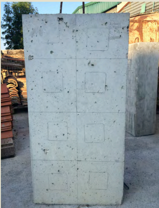
Imatge 1.4: Proveta MP2A2. Amb el. Intermitjos i Rn: 40 mm. Foto: Albert Coromina / Font: Pròpia
