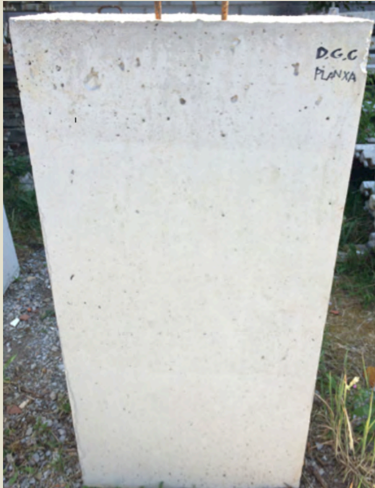
Imatge 1.4: Desencofrat motlle de planxa (MP1A3).
