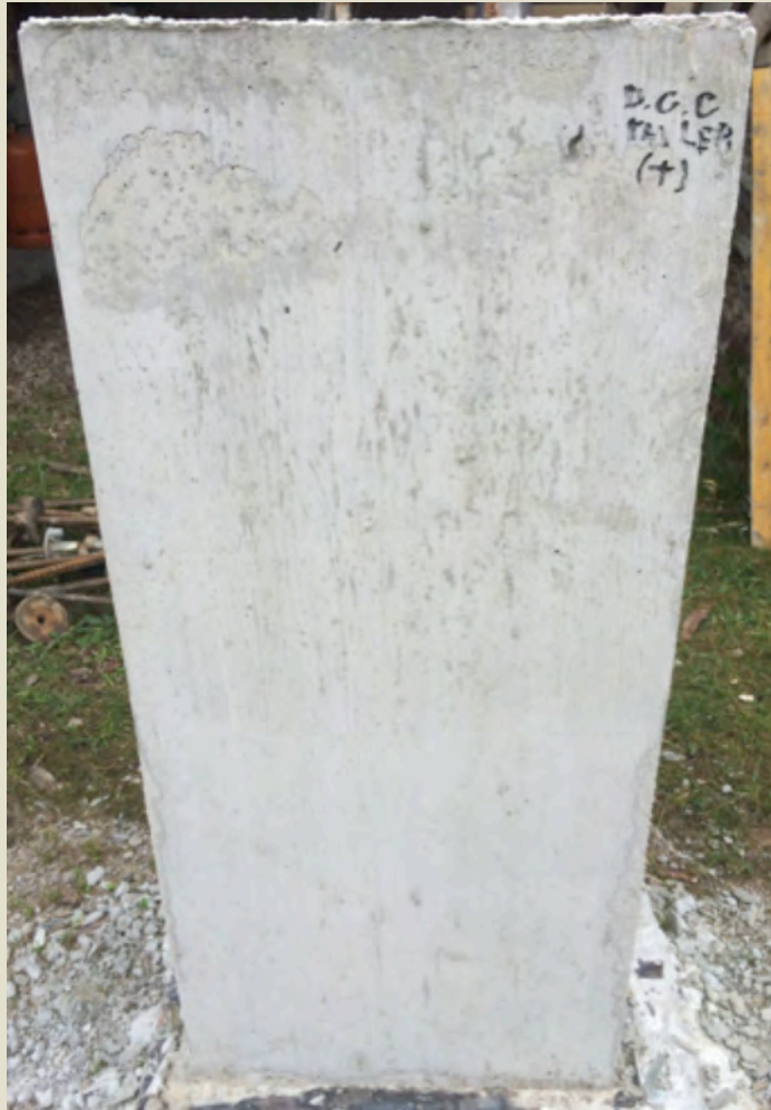
Imatge 2.12: Desencofrat motlle de tauler fusta de pi (MT2A3).
