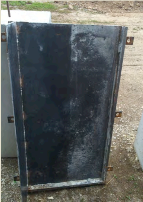
Imatge 2.1: Desencofrat motlle de planxa. Consistència fluida (+20l aigua) (MP2A3). Foto: Albert Coromina / Font: Pròpia
