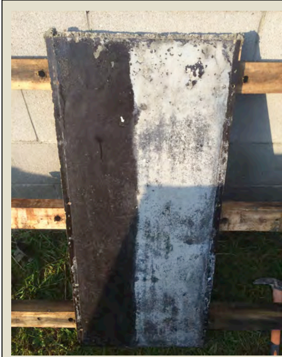
Imatge 1.5: Desencofrat motlle de tauler fenòlic. (MF1A3).
