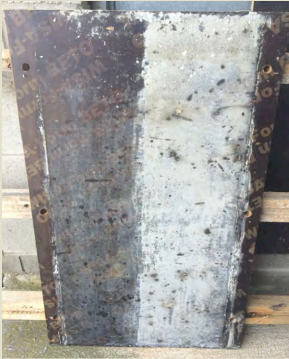
Imatge 2.5: Desencofrat motlle de tauler fenòlic. Consistència fluida (+20l aigua) (MF2A3). Foto: Albert Coromina / Font: Pròpia
