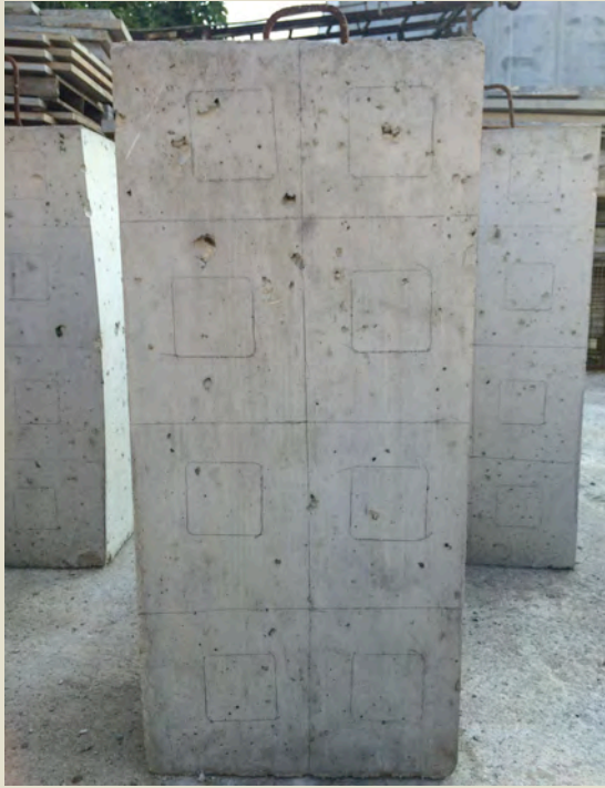
Imatge 1.11: Proveta MT2A2. Amb el. Intermitjos i Rn: 25 mm. Foto: Albert Coromina / Font: Pròpia
