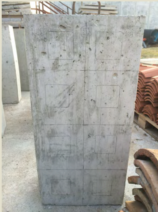
Imatge 1.9: Proveta MT1A2. Sense el. Intermitjos i Rn: 25 mm.
