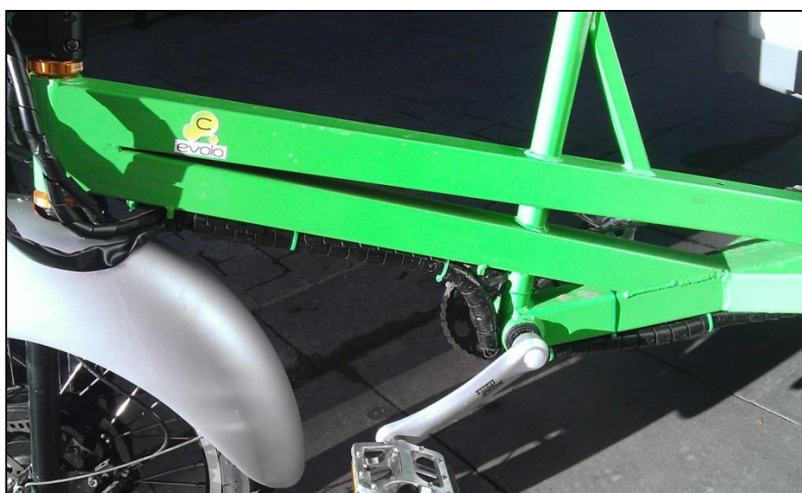
Figura 26. Funda espiral on es col·loca el cablejat
