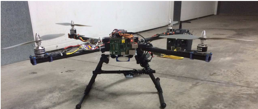
Figura 23 – Imatge frontal del drone amb la Raspberry Pi al davant i la webcam enfocada
