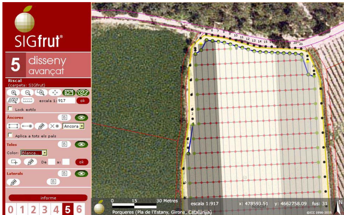
Figura 6. Diseño avanzado de la instalación con diferentes tipos de telas protectoras Fuente de datos: ICC Autor: SIGTE
