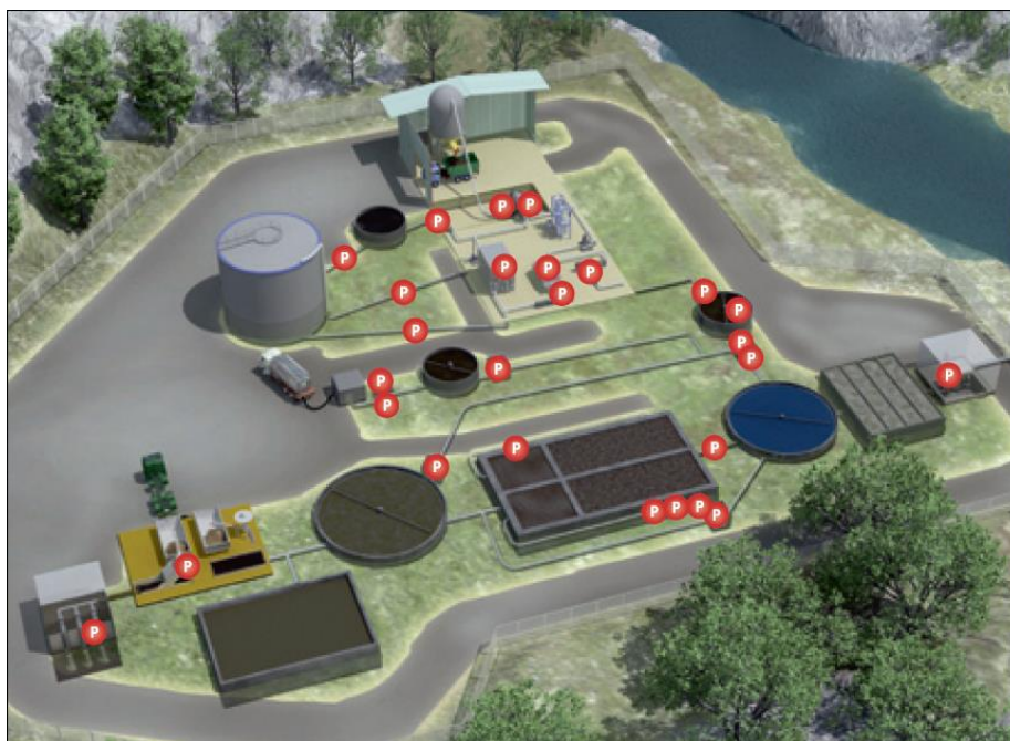
Figura 3.1: Localització de les bombes en les EDAR. (ITT Water & Wastewater AB)
