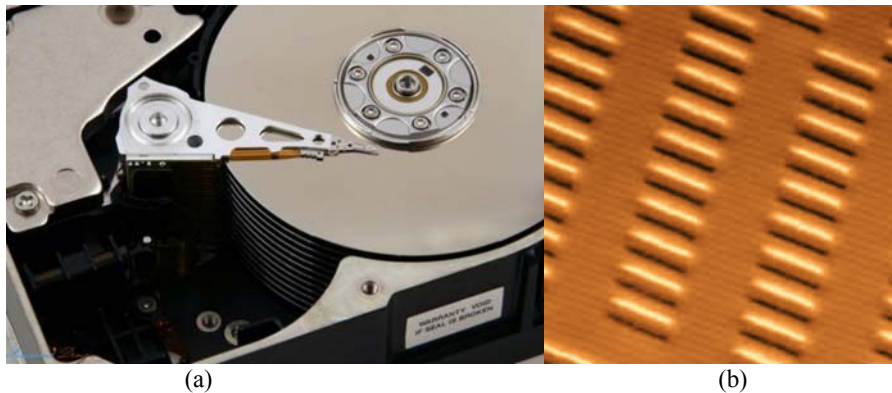
Figura 26. (a) sistema de discs i capçals d'un disc dur. (b) Imatge (30x30 \mu\text{m} ) de microscòpia electrònica dels dominis magnètics a la superfície d'un disc dur.
