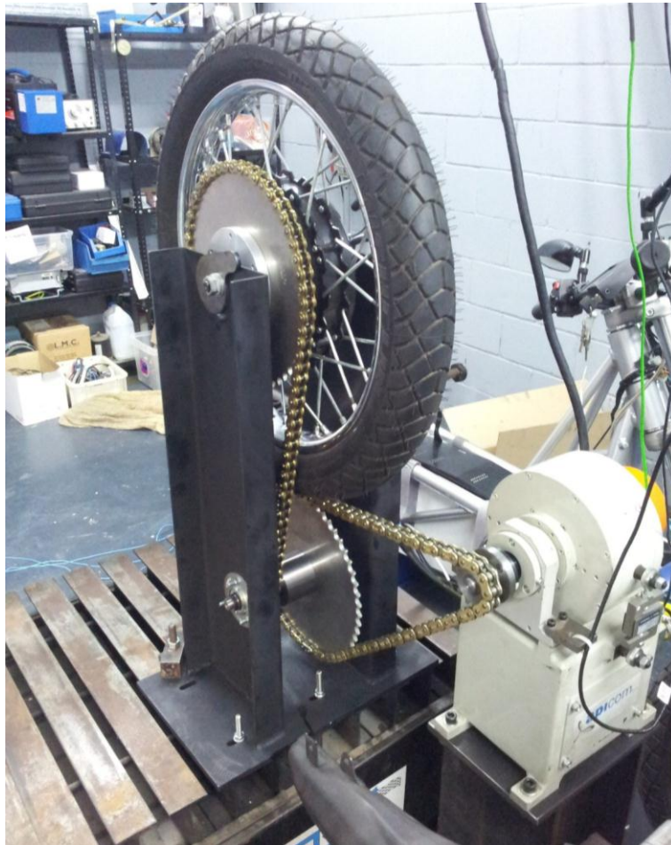
Figura 2. Muntatge final del motor elèctric al banc de proves.
