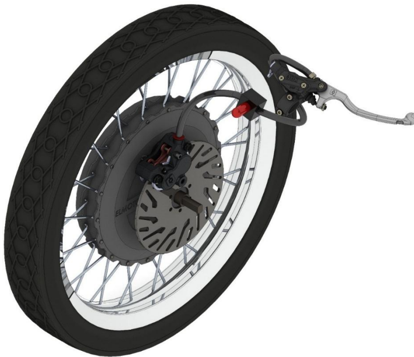
Figura A1. Disseny 1: Parell resistent mitjançant un disc de fre.
