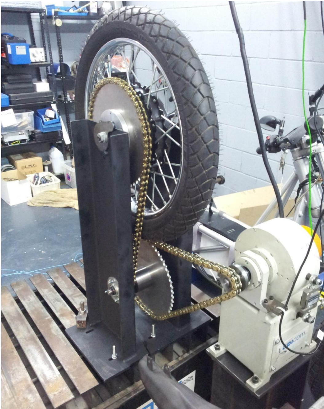
Figura 4. Muntatge final del motor elèctric al banc de proves.
