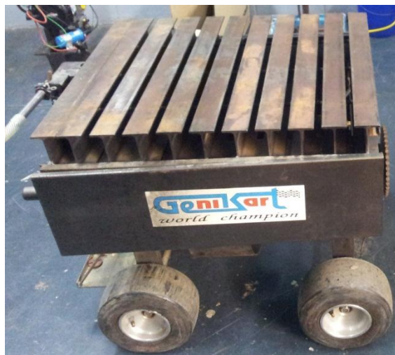
Figura 5. Bancada del conjunt de l'estructura motor.
