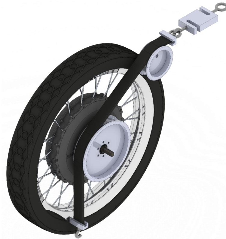
Figura A3. Disseny 2: Parell resistent mitjançant una corretja.
