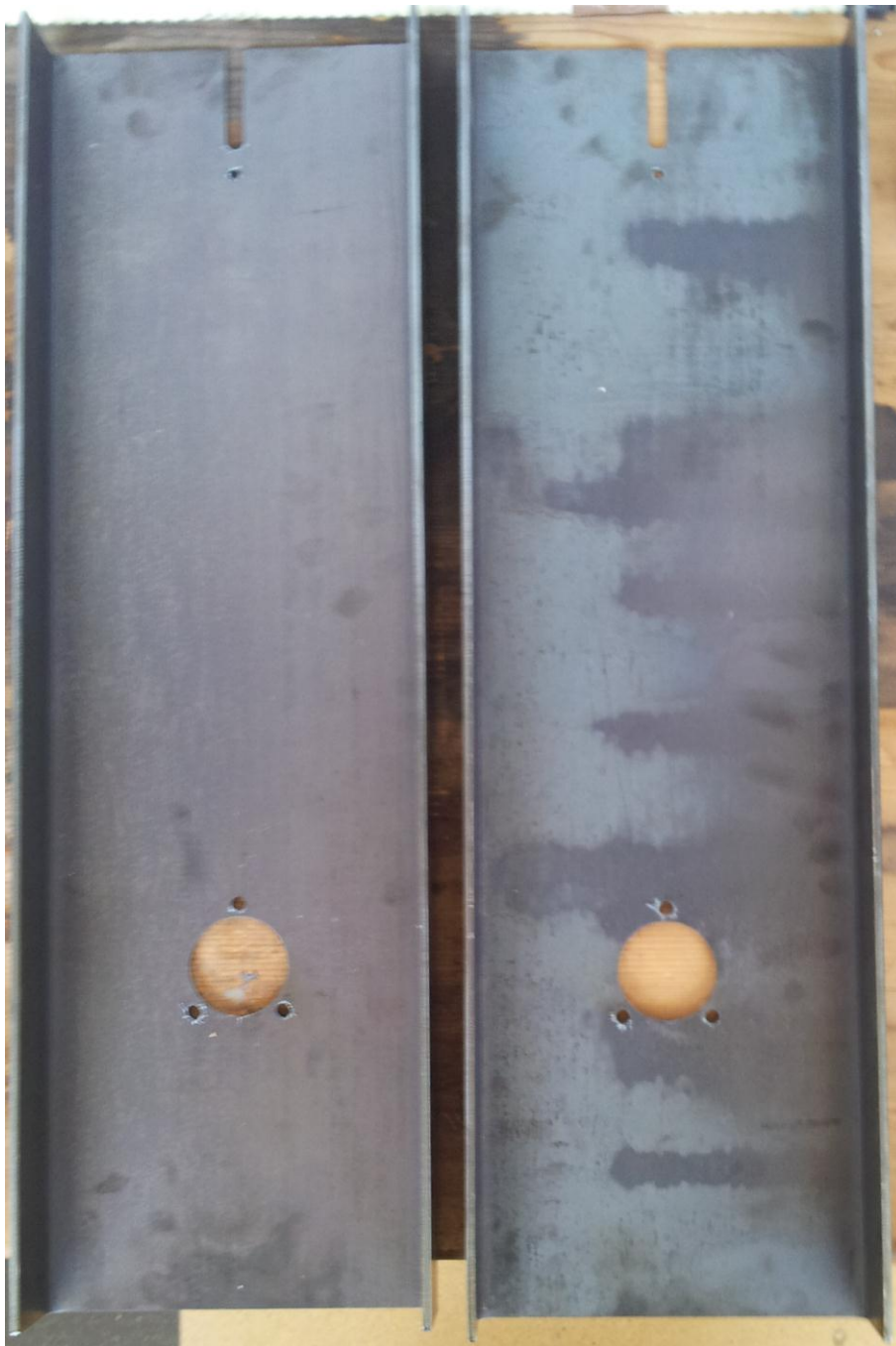
Figura 13. Error de mecanització dels forats dels cargols de fixació dels rodaments.
