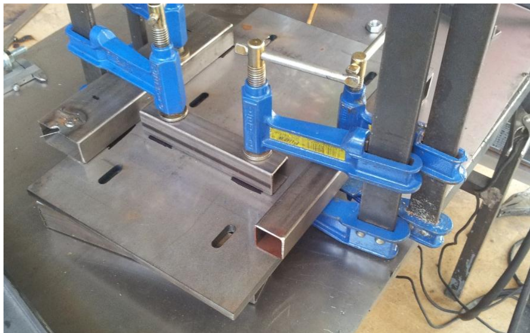
Figura D1. Posicionament de la primera biga respecte la base de l'estructura del motor.
