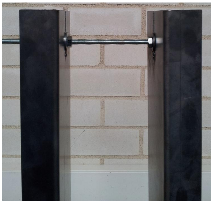
Figura D2. Muntatge d'un eix roscat entre les bigues per evitar que es dobleguin.
