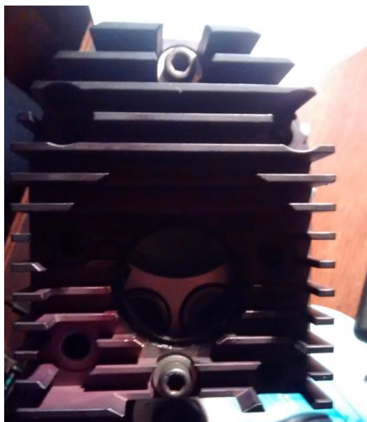
Figura 2.2 Motor sense cambra de combustió Figura 2.3 Motor amb cambra de combustió
