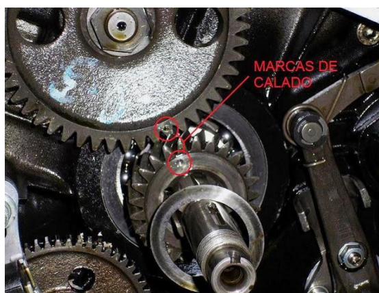
Figura 6.3 Sincronització arbre de lleves, extret de la mateixa font que la figura 6.2
